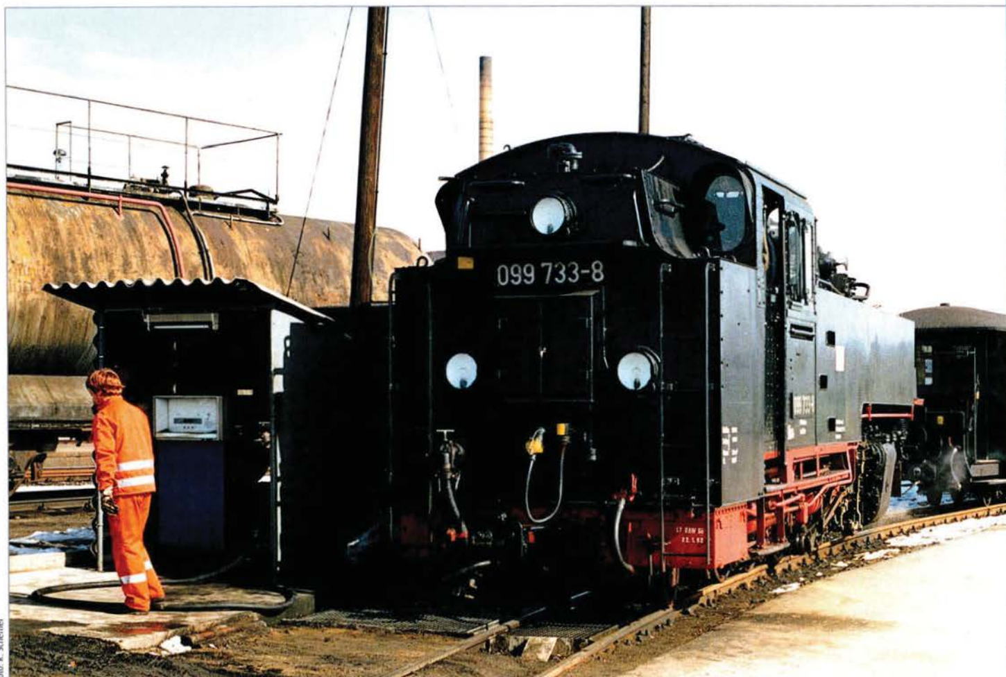
Letzter Versuch für ölgefeuerte Dampflokomotiven in Deutschland auf dem Zittauer Schmalspurnetz. Dieselöl wurde mit einer normalen Zapfpistole in den Tender gefüllt.
