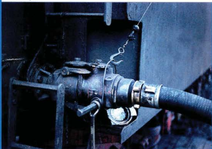
Durch die Schlauchleitung gelangt das zähflüssige C-Bunkeröl in den Tender.
