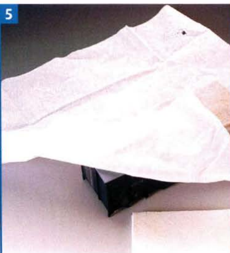
5 Ein auf das Wagendach aufgeklebtes passendes Stück Papiertuch imitiert den beim Vorbild anzutreffenden Dachpappenbelag.
