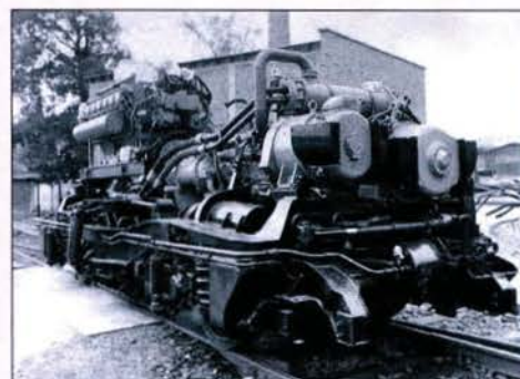
6 Das Triebgestell: 1000 PS und die Hilfsbetriebe wollten auf zwei Achsen untergebracht sein.
