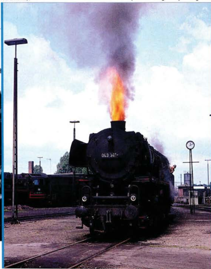
043 381 beim Ausblasen der Ölleitung. Es entsteht eine explosionsartige Verpuffung.
