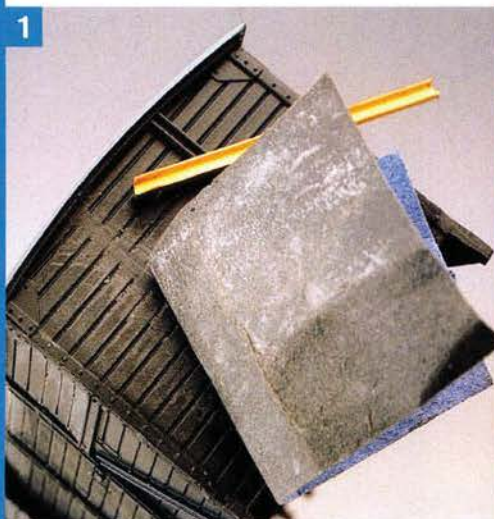
Die nicht exakt vorbildgerechten Träger der Stirnwand werden vorsichtig abgeschliffen und durch feinere Messingprofile ersetzt.
