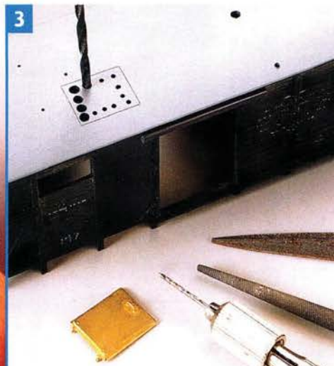
Die Ausstiegsöffnung wird mittels Handbohrer perforiert, das Material vorsichtig herausgebrochen und das Loch passend gefeilt.
