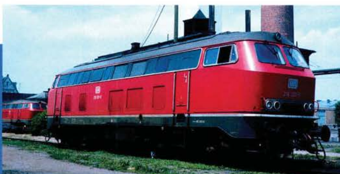
218001 erhielt das Voith L 820 brs mit hydrodynamischer Bremse.
