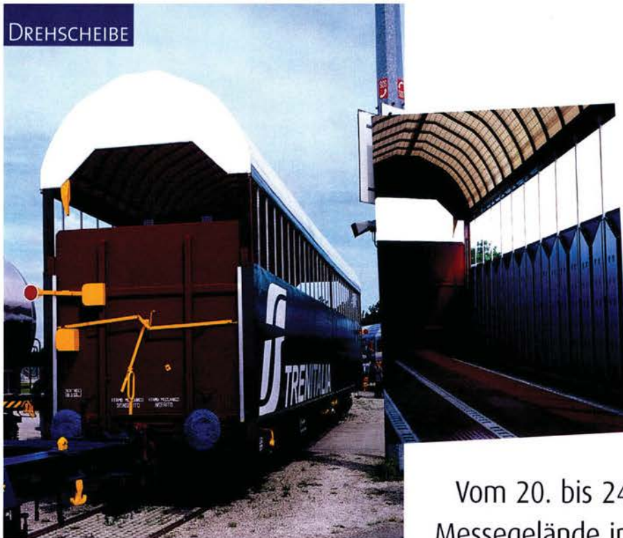
Das ist der Prototyp des Großraumwaggon Habis-X für die italienischen Staatsbahnen FS. Dessen Dach kann für Beladevorgänge angehoben werden. Das Bild rechts zeigt die mögliche großzügige Höhenverschiebbarkeit von innen.
