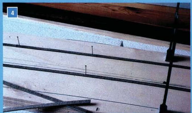
4 Jedes Gleis in Kurvenlage erhält seine eigene Überhöhung am äußeren Bogen. Als Unterbau dienen Kartonstreifen, die aufgeleimt werden.
