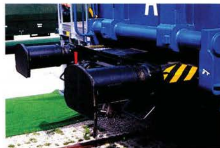
Pufferbohle des Habis 11/3, deren Konstruktion eine Stoßverzögerung um 1 g bewirkt.
