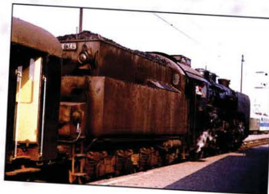
424 349 im September 1972 in Budapest: Eine ungarische Spezialität war die Schornsteinsaugzuganlage Bauart Ister.
