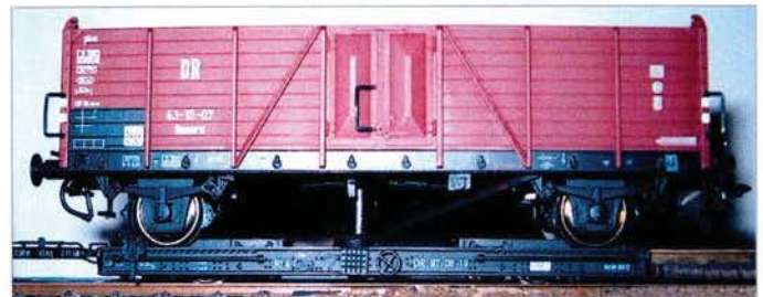
Die Magnete im Wagenboden des Ommru stehen exakt über denen des Rollwagens und halten so den Regelspurwagen in Position.
