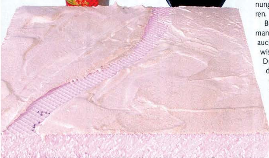
Mit Gips erhält die Styrodur-Platte Geländekonturen. Der Weg bleibt zunächst frei.
