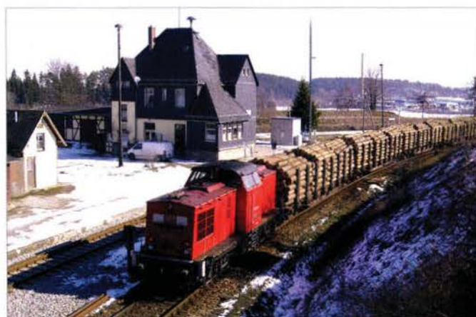
Derselbe Zug im Keilbahnhof Unterlemnitz: Für den Holzverkehr wurde das 1997 entfernte Ausweichgleis bis 2003 wieder eingebaut.
