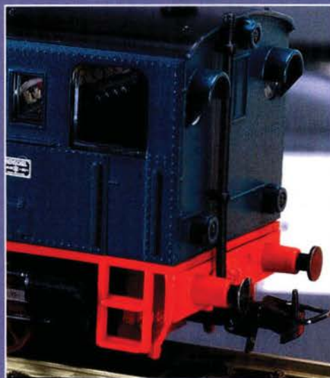
Trotz des geringen Raums im Führerhaus lässt sich ohne Fräsarbeiten ein Decoder unterbringen.
