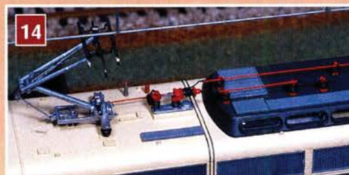
14 Dachpartie hinter dem Führerstand 1 mit versetzter Lokpfeife, Zugbahnfunkantenne und Hauptschalter.
