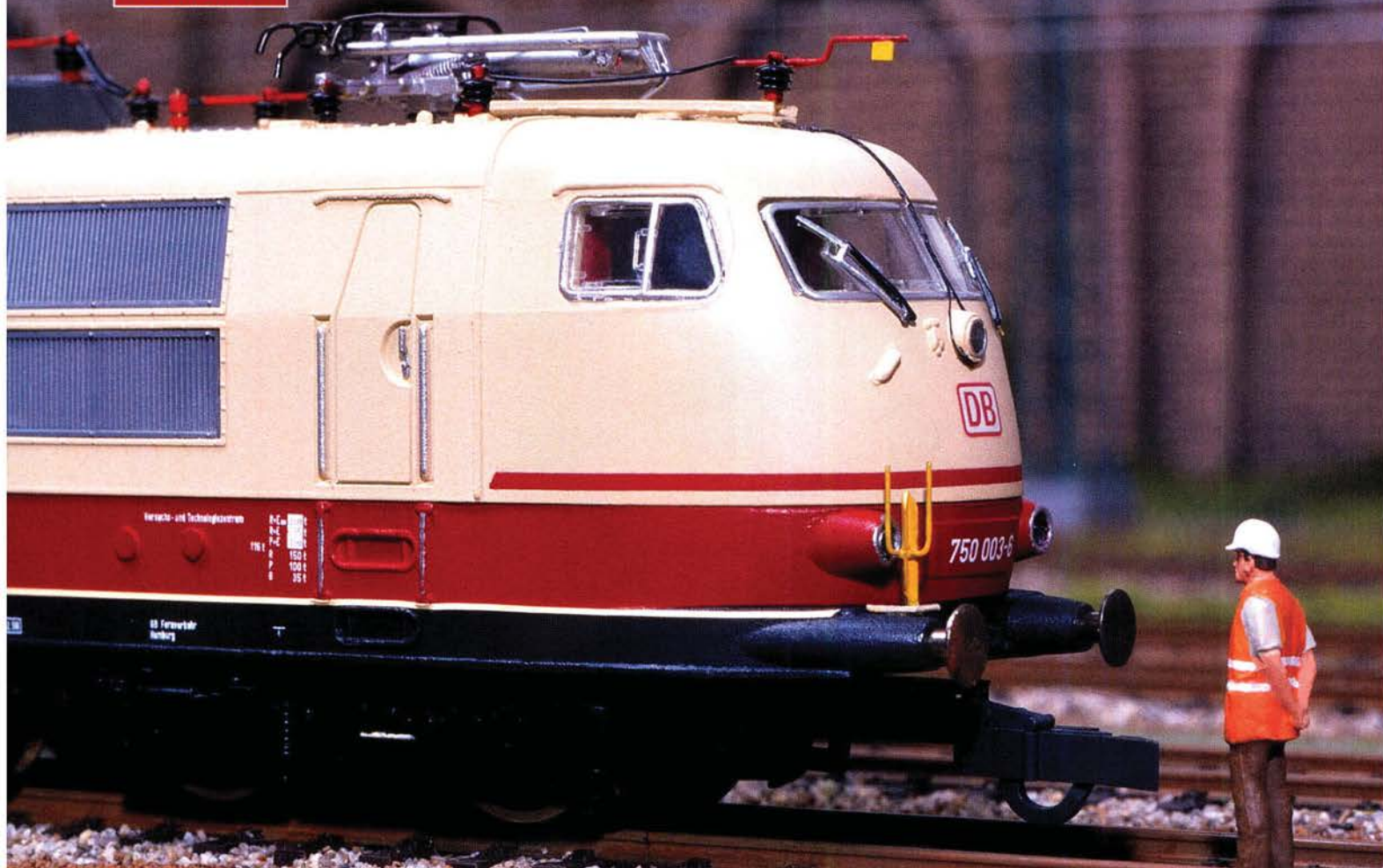
Führerstand 2: Die Hochspannungskupplung zum Messwagen bestimmt die Dachpartie; die Modellkupplung (unten) ersetzt die Kupplungsattrappe.
