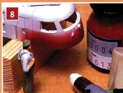
8 Nach der Grundierung folgt der Sprühauftrag für den roten Zierstreifen an der Lokfront.
