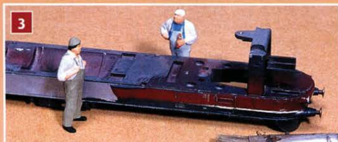
3 Mach mal Pause: Derweil zeigt der Lack unter Acetoneinfluss Wirkung.
