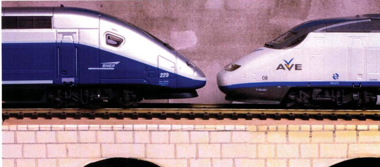
Hier sind die Unterschiede zwischen TGV (li.) und AVE (re.) besonders gut auszumachen. Der AVE-Triebkopf hat zudem eine lange Dachschräge.
