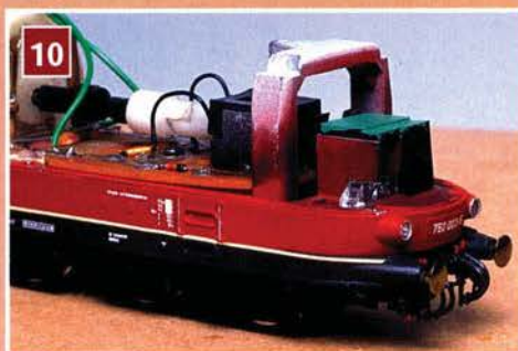
10 Ansichtssache: Der fertige Lokrahmen präsentiert sich mit ausgefräster und neu verkabelter Platine.
