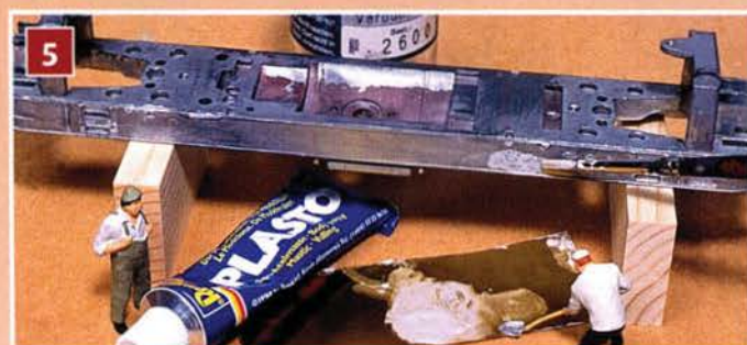
5 Mit Spachtelmasse und Schleifpapier gleicht man Unebenheiten aus.
