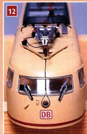
12 Mittels Kupferfilz wird die drahtige Hochspannungskupplunghalterung, geschlungen um die obere Lampe des Dreilichtspitzensignals, nachgebildet.
