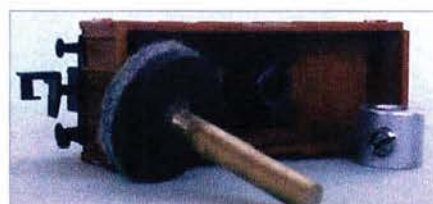
Mit der oberen Buchse (rechts) hindert man die Mechanik am Herausfallen.
