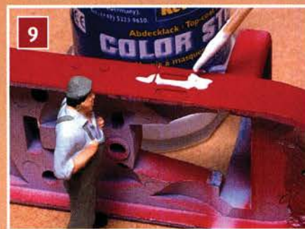
9 Rahmenbedingung: Abdecklack verhindert an Erhebungen das Unterlaufen der Trennkante.
