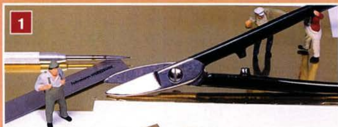
1 Erster Schritt: Das Haltekorsett aus Messingblech wird zugeschnitten.
