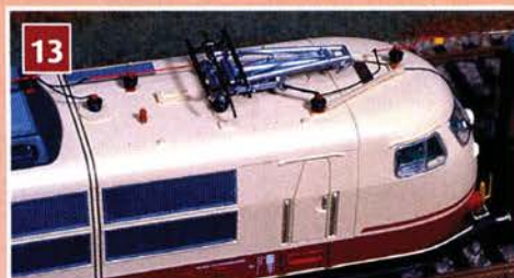
13 Die Detailansicht zeigt die Dachausrüstung samt Hochspannungsüberleitung zum Messwagen.
