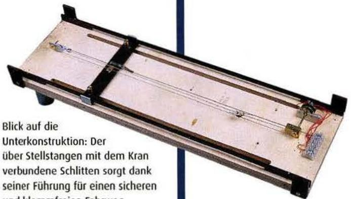
Blick auf die Unterkonstruktion: Der über Stellstangen mit dem Kran verbundene Schlitten sorgt dank seiner Führung für einen sicheren und klemmfreien Fahrweg.
