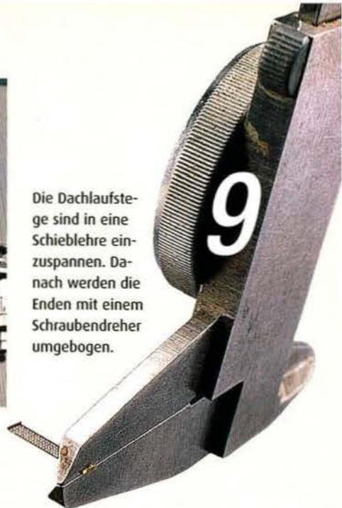
Die Dachlaufstege sind in eine Schieblehre einzuspannen. Danach werden die Enden mit einem Schraubendreher umgebogen.
