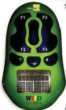
Motorola-Befehle (78 Lokadressen), hat ein Klartext-Display, kann zwölf Sonderfunktionen schalten und kommt dank Funk-Technik (Reichweite mindestens 20 Meter) ohne Kabelsalat aus. Fahrstufen und die Punkte in dem flach aufgebauten Menü (zwei bis drei Ebenen) werden per Scroll-Rad gewechselt. Auch ein Magnetartikel-Modus ist an
