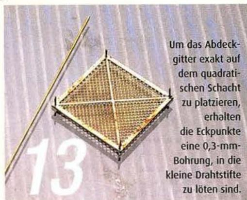
Um das Abdeckgitter exakt auf dem quadratischen Schacht zu platzieren, erhalten die Eckpunkte eine 0,3-mm-Bohrung, in die kleine Drahtstifte zu löten sind.
