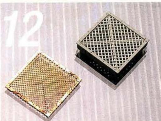
Das quadratische Abdeckgitter wird mit dem Rahmen und der Diagonalverstrebung verlötet.
