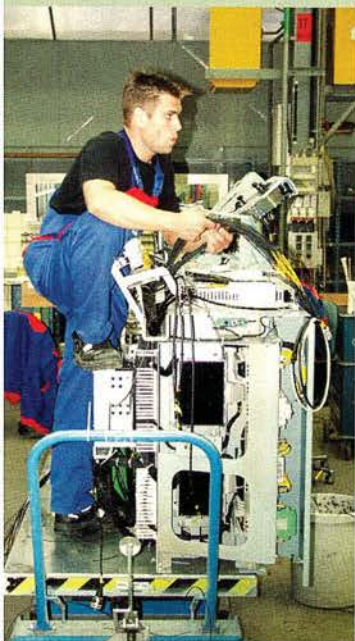
Die Führerstände der Traxx-Loks werden in Kassel verkabelt.
