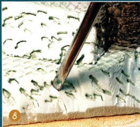
8 Im mittels Schraubendrehers zerlöchernten Hartschaum-Basismaterial findet der aufzutragende Geländegips besseren Halt.
