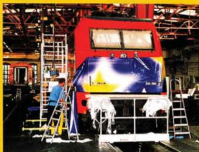
Der erste Frontstreifen ist angebracht. Die Dachschräge wurde wie Griffe, Steckdosen und Scheinwerfergehäuse blau lackiert.
