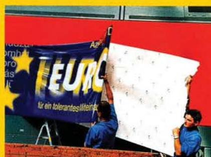
Präzisionsarbeit ist erforderlich, als die Folie von ihrer Trägerschicht abgezogen und die Seitenwand der Lok faltenfrei beklebt wird.
