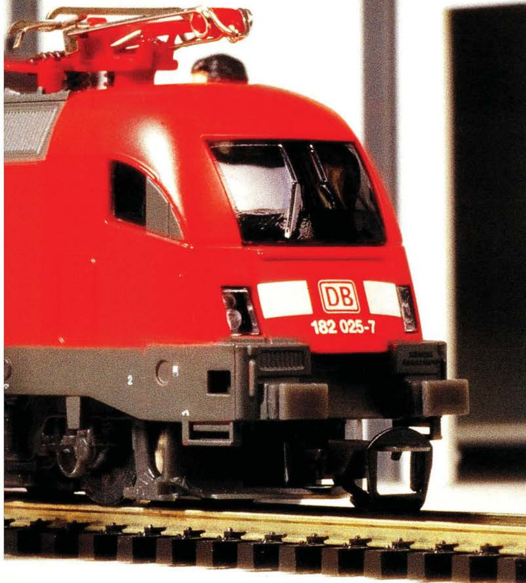
Das Design des Taurus hat Piko gut getroffen. Frontscheibe und Scheibenwischer sind ein Formteil.
