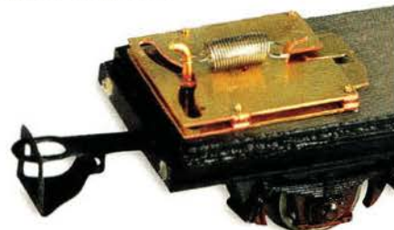
Die Montage der Kurzkupplungskinematik ist der anspruchsvollste Bauabschnitt.
