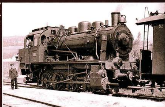
1942 waren die Laternen von Lok 181 (spätere 922901) abgedunkelt. Am Wagen sieht man Umlenkrollen der Gewichtsbremse.
