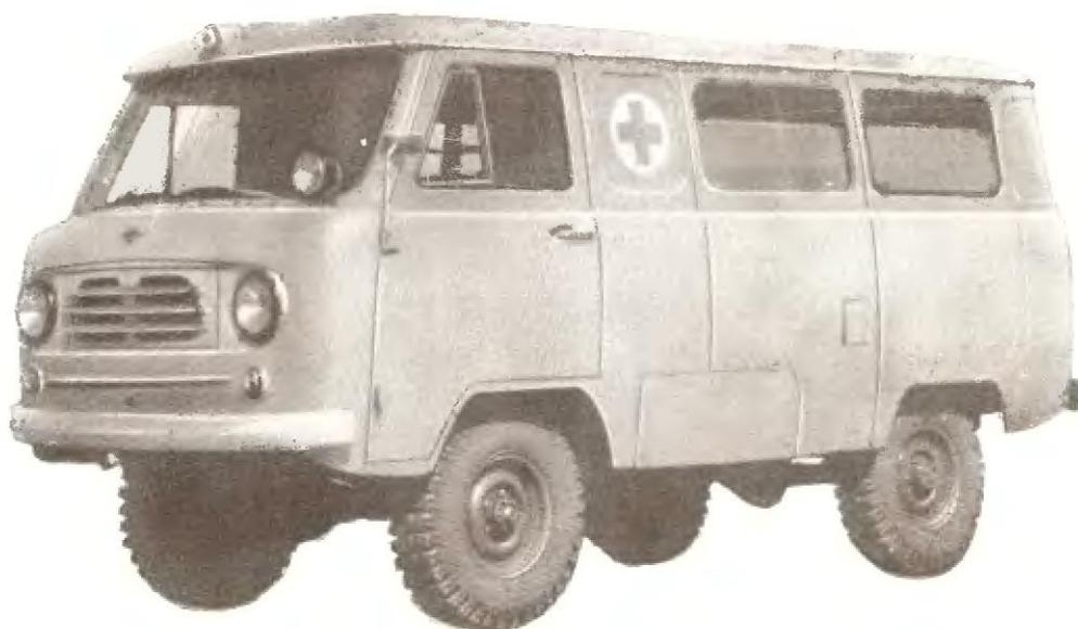
Санитарный автомобиль предназначен для перевозки больных по дорогам всех классов и бездорожью. Автомобиль может буксировать бестормозной прицеп общим весом 850 кг.
