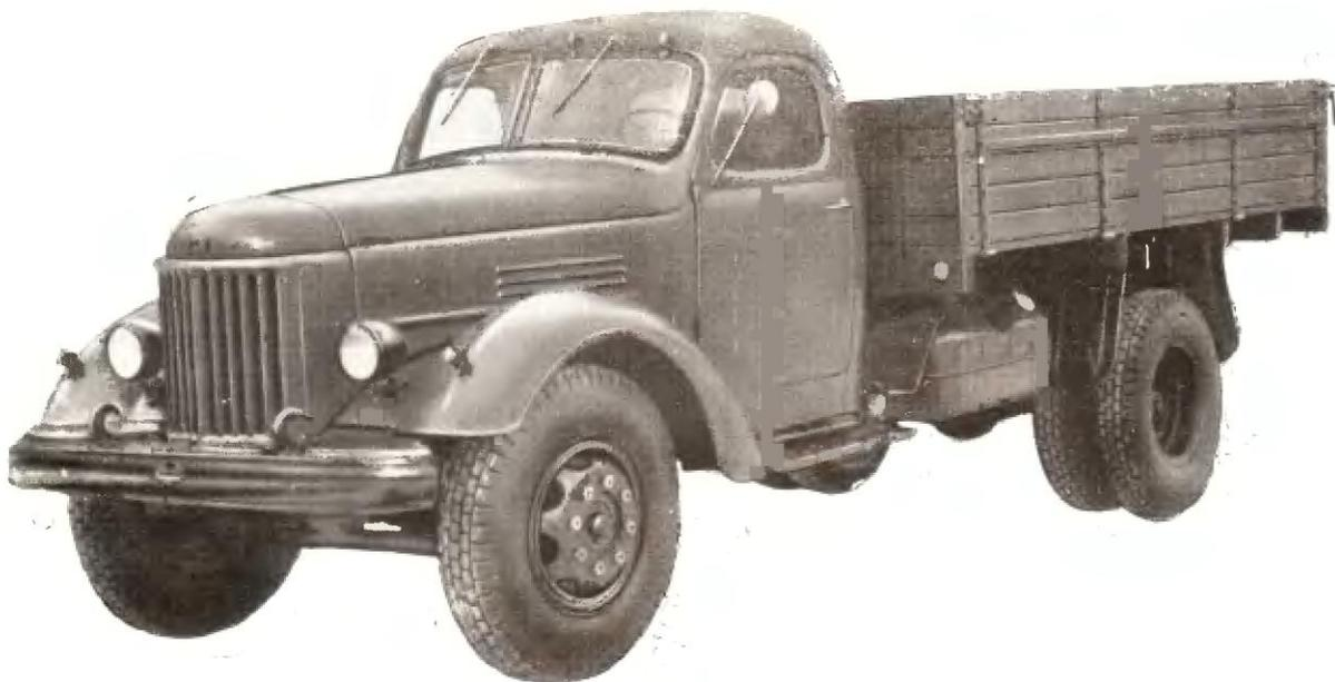
Грузовой автомобиль средней грузоподъемности предназначен для перевозки грузов по дорогам всех классов, включая проселочные. Автомобиль может буксировать прицеп общим весом 4500 кг.
