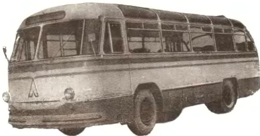
Городской автобус средней вместимости предназначен для работы на городских и пригородных линиях. На автобусе установлен восьмицилиндровый V-образный бензиновый двигатель, расположенный продольно сзади, сцепление с гидравлическим приводом выключения.
