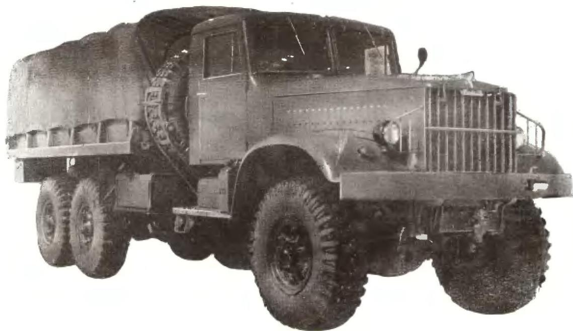
Автомобиль предназначен для эксплуатации в тяжелых дорожных условиях. Автомобиль может буксировать прицепы, оборудованные тормозами с пневматическим приводом, общим весом 50000 кг по дорогам с твердым покрытием и 10000 кг — по грунтовым дорогам и бездорожью.
