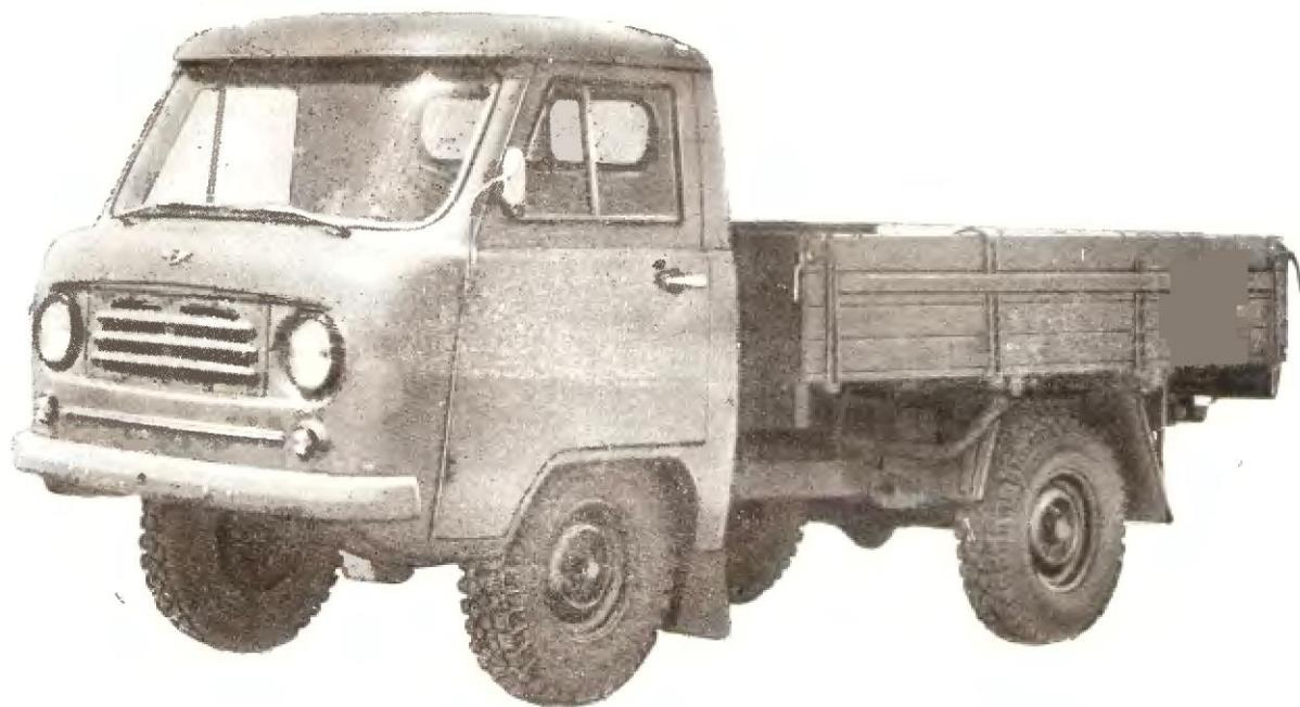
Грузовой автомобиль с кабиной над двигателем предназначен для эксплуатации по дорогам с твердым покрытием, а также по грунтовым и проселочным дорогам. Завод выпускает модификацию УАЗ-451 — автомобиль с кузовом фургон.
