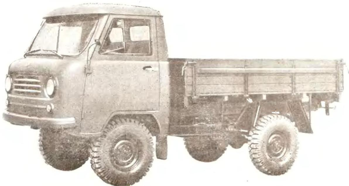
Грузовой автомобиль с кабиной над двигателем предназначен для перевозки различных мелкопартионных грузов по дорогам всех классов и бездорожью. Автомобиль может буксировать бестормозной прицеп общим весом 850 кг. Завод выпускает следующие модификации: УАЗ-450 — автомобиль с кузовом фургон, УАЗ-450А — санитарный автомобиль.
