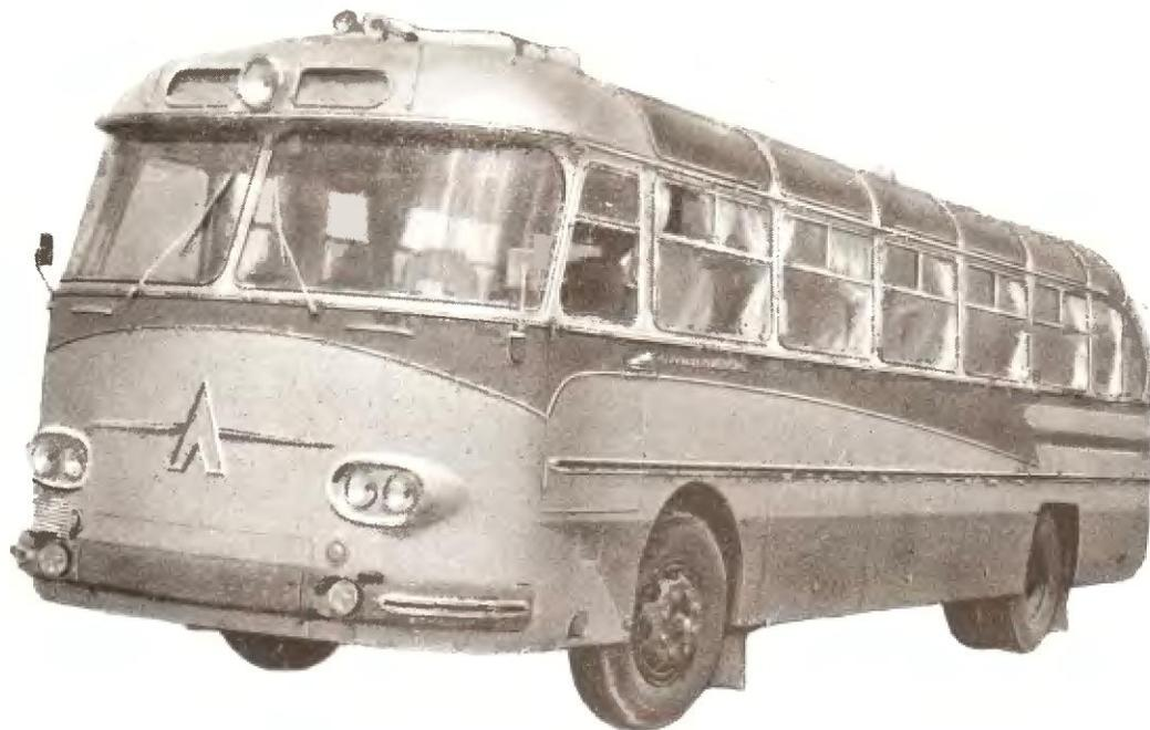
Междугородный автобус средней вместимости предназначен для работы на дорогах 1-го и 2-го классов. На автобусе установлен восьмицилиндровый V-образный бензиновый двигатель, расположенный продольно сзади. Сцепление с гидравлическим приводом включения. Шестискоростная коробка передач с синхронизаторами. Подвеска пневматическая. Рулевой механизм с гидравлическим усилителем. Тормоза с пневмогидравлическим приводом имеют пневматический усилитель. Автобус оборудован радио и микрофонной установкой.
