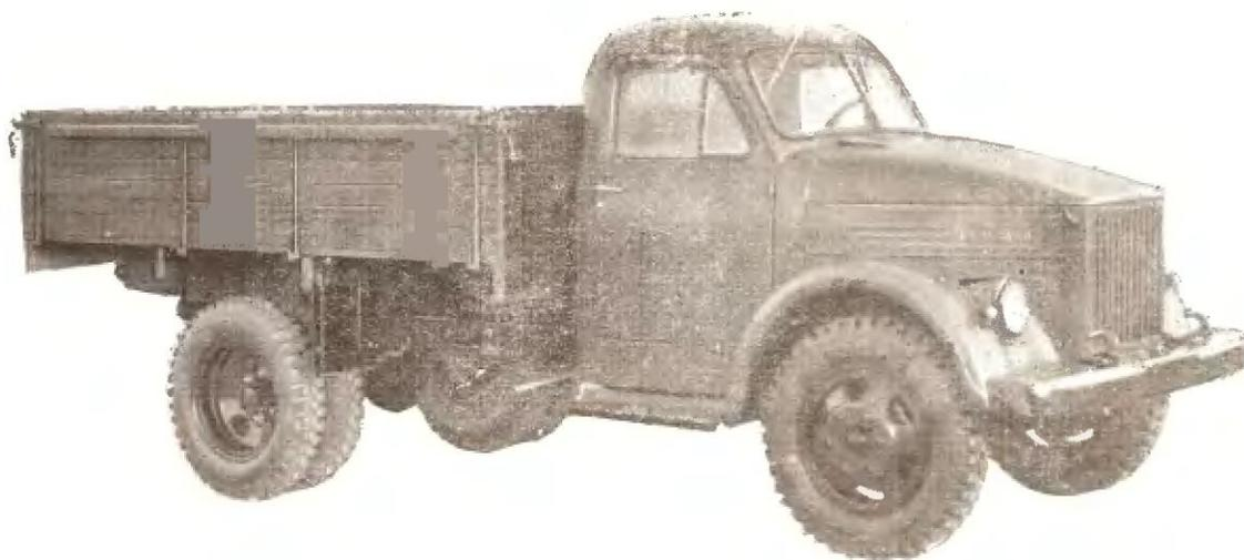
Грузовой автомобиль средней грузоподъемности предназначен для перевозки грузов по дорогам всех классов, включая проселочные.
