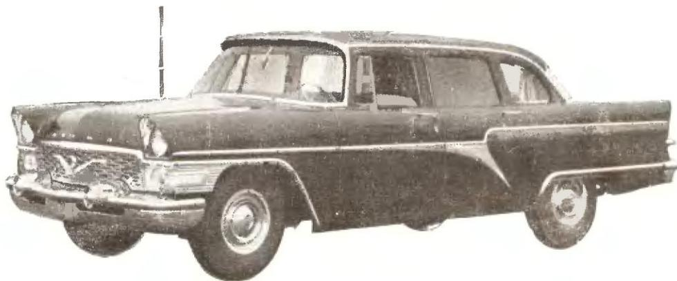
Легковой семиместный автомобиль повышенной комфортабельности, предназначен для эксплуатации по дорогам не ниже второго класса. Автомобиль рамной конструкции с цельнометаллическим четырехдверным кузовом типа седан, расположение сидений трехрядное.
