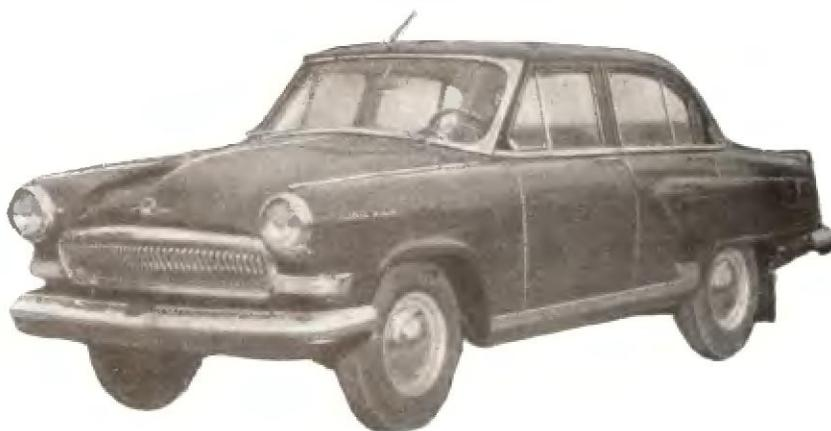
Легковой пятиместный автомобиль среднего литража, предназначен для эксплуатации по дорогам с усовершенствованным покрытием. Автомобиль с несущим четырехдверным кузовом типа седан.
