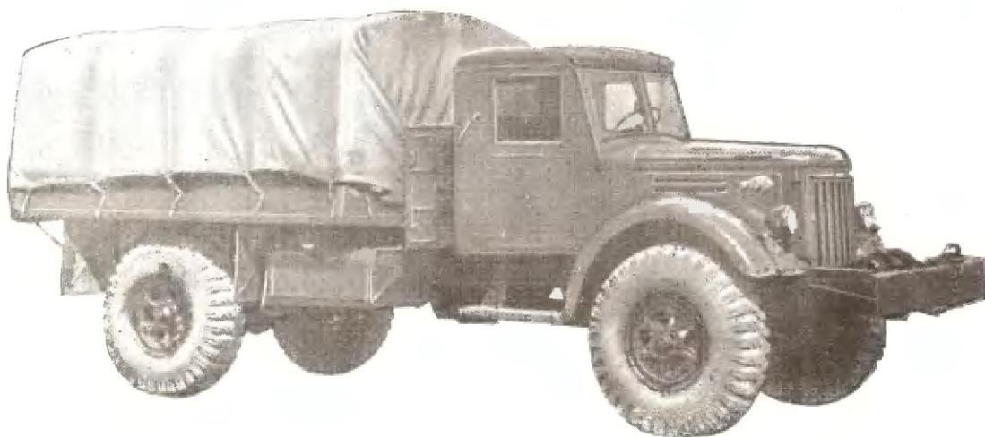
Грузовой автомобиль предназначен для работы с прицепом по дорогам всех классов. Полный вес буксируемого прицепа по дорогам с твердым покрытием и улучшенным грунтовым дорогам — 9500 кг, по тяжелым грунтовым дорогам — 5000 кг.
