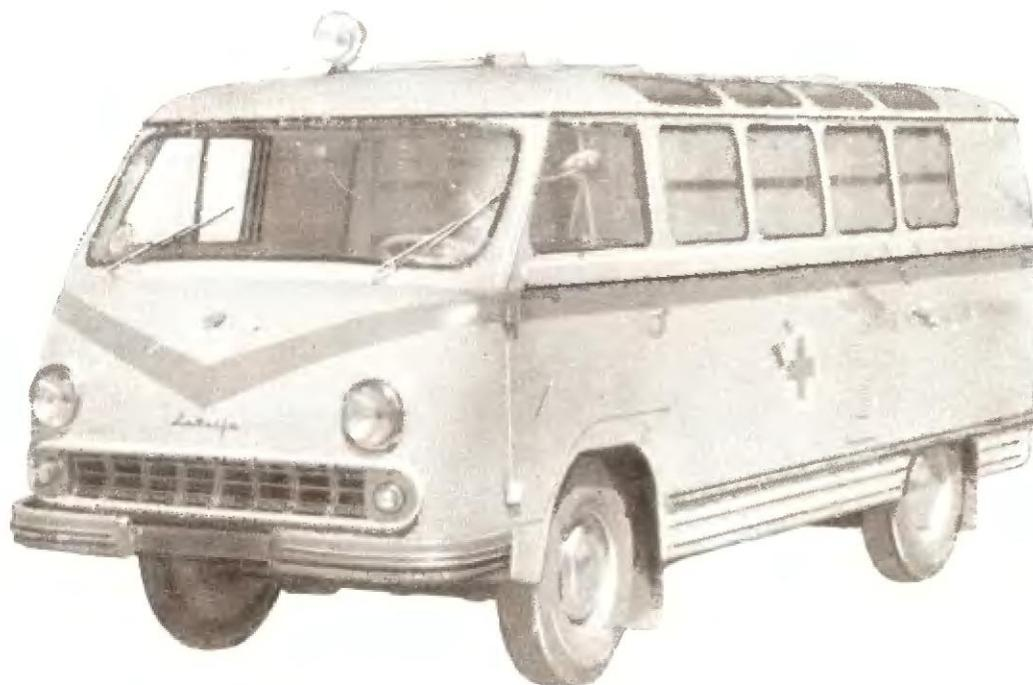
Автомобиль РАФ-977И на базе автобуса РАФ-977Д предназначен для оказания скорой медицинской помощи пострадавшим, применяется в населенных пунктах с усовершенствованным дорожным покрытием. Автомобиль оборудован погрузочным устройством, с помощью которого носилки с больным устанавливаются в транспортное положение. Кузов рассчитан на размещение дополнительных носилок для лежания и носилок для перевозки больного сидя.
