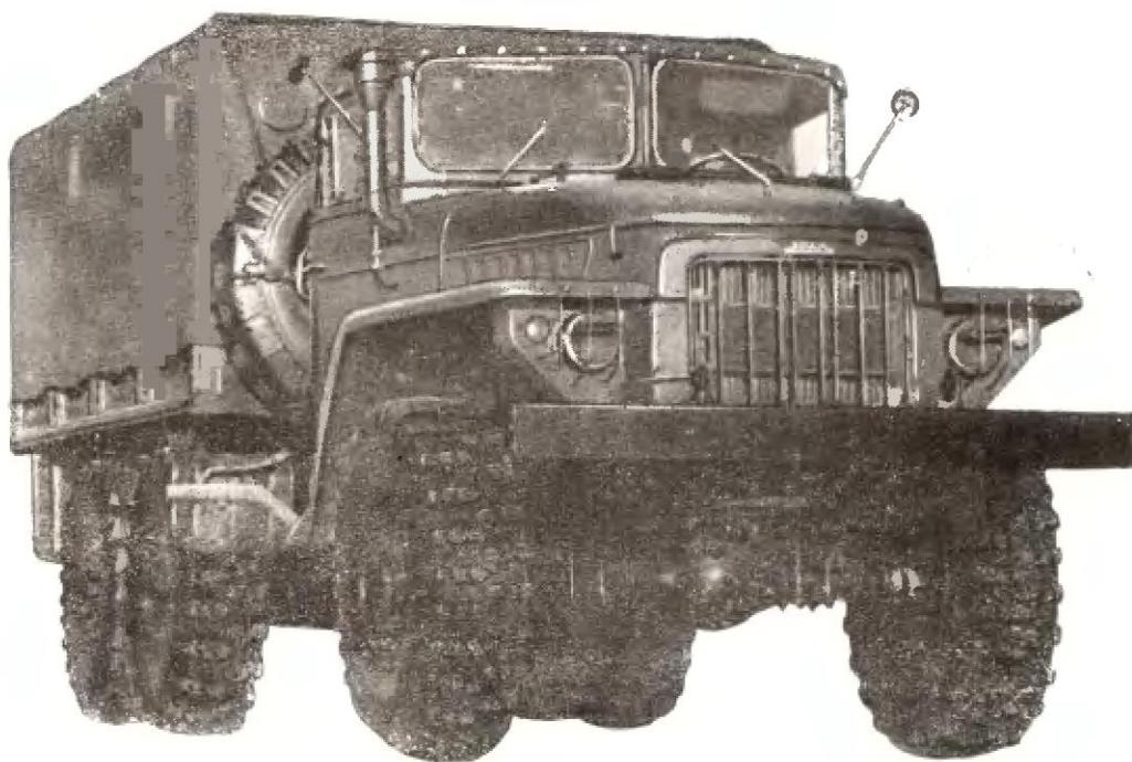
Грузовой автомобиль средней грузоподъемности предназначен для перевозки грузов по дорогам всех классов и бездорожью. Автомобиль может буксировать прицеп, общим весом 10000 кг по дорогам с твердым покрытием и по грунтовым дорогам и бездорожью — 5000 кг.
