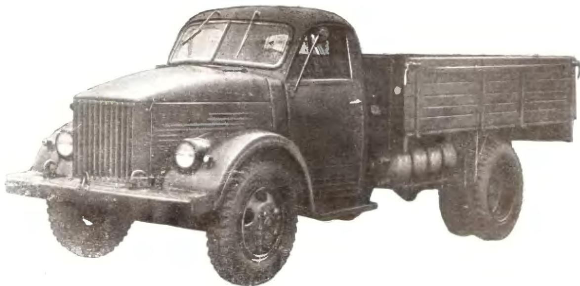
Грузовой автомобиль средней грузоподъемности предназначен для перевозки грузов по дорогам всех классов с твердым покрытием. Автомобиль может буксировать прицеп, оборудованный тормозом наката, общим весом 3,5 т.
