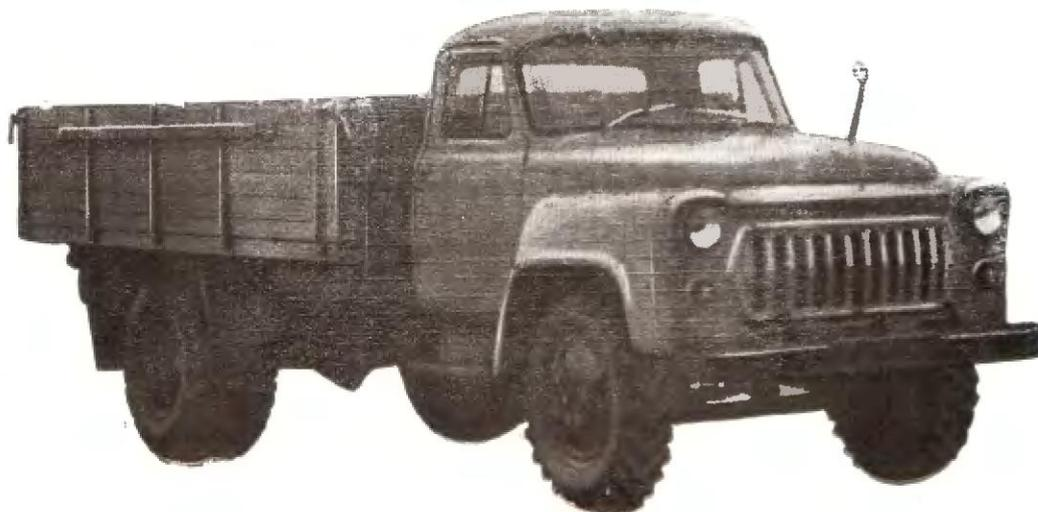
Грузовой автомобиль средней грузоподъемности (переходная модель до освоения производством автомобиля ГАЗ-53) предназначен для перевозки грузов по дорогам всех классов, включая проселочные, и может буксировать прицеп, оборудованный тормозом наката, общим весом 4000 кг.
