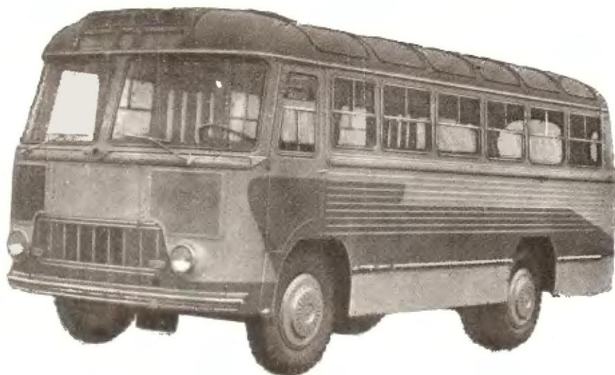
Городской автобус средней вместимости предназначен для работы на городских и пригородных линиях по дорогам с твердым покрытием. В конструкции автобуса использованы узлы и агрегаты грузовых автомобилей ГАЗ.
