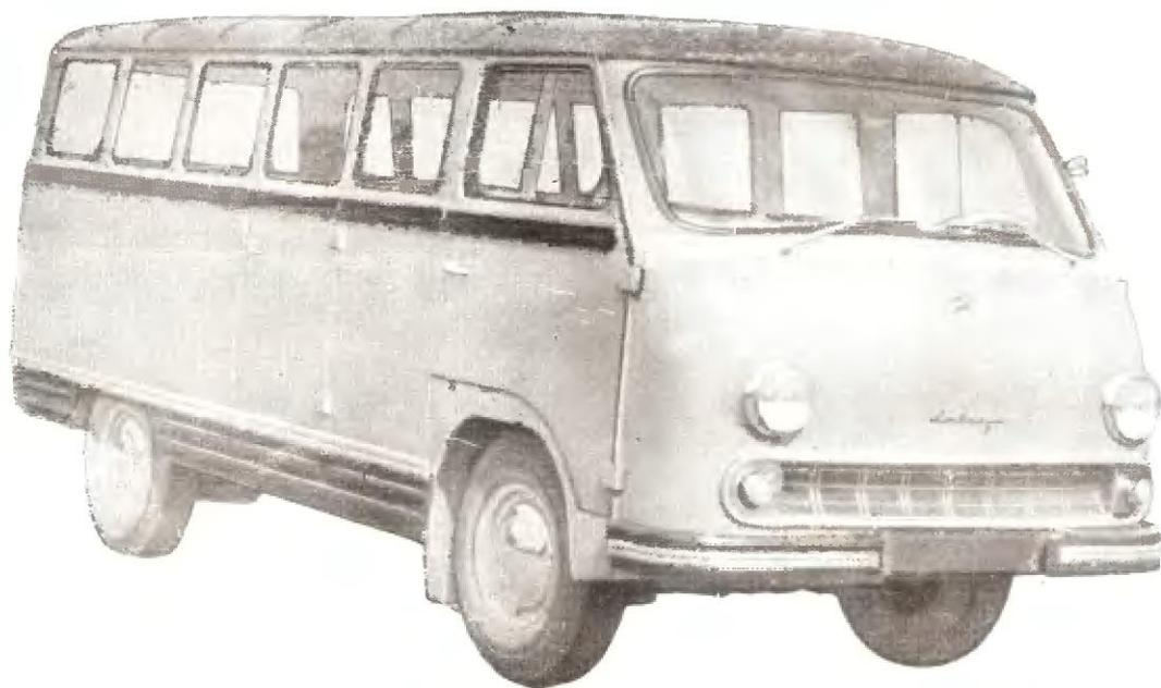
Автобус особо малой вместимости предназначен для перевозки пассажиров по дорогам с твердым покрытием. Сиденья салона легкосъемные, что позволяет перевозить в автобусе мелкий груз весом до 750 кг.
