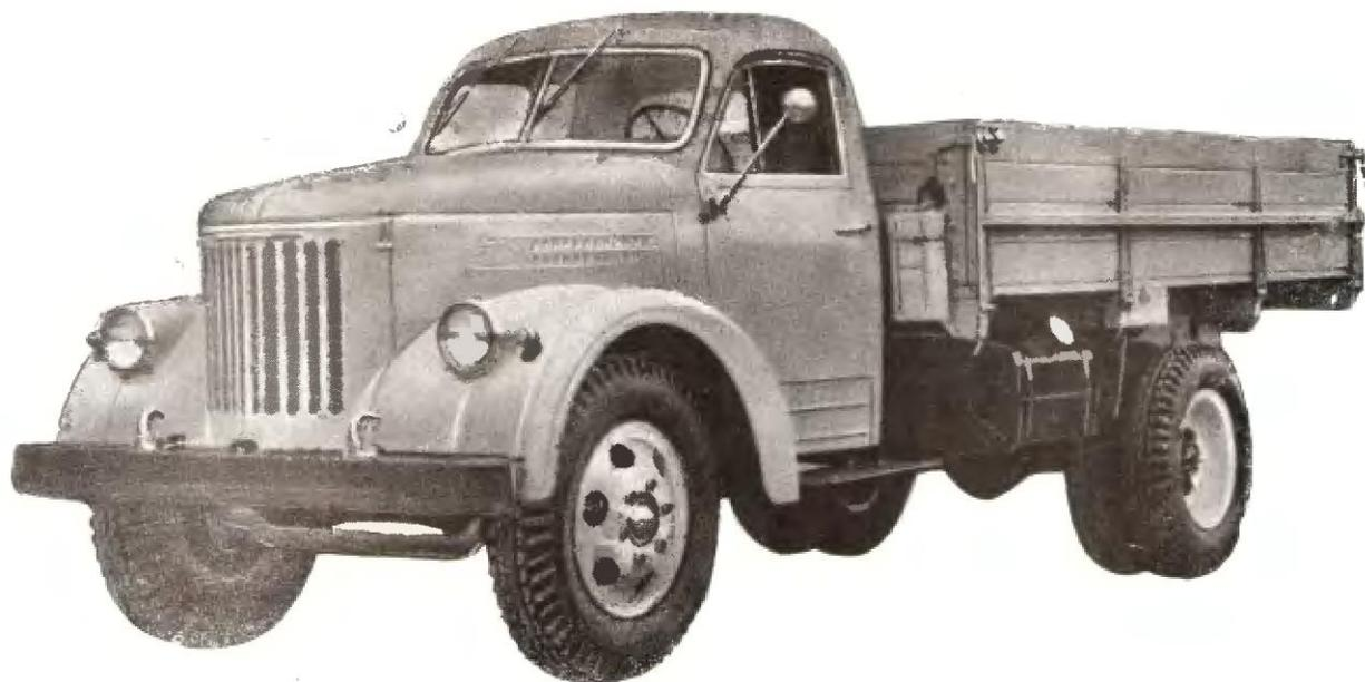
Автомобиль предназначен для эксплуатации на дорогах с твердым покрытием и грунтовых дорогах. Завод выпускает шасси Урал-355М.
