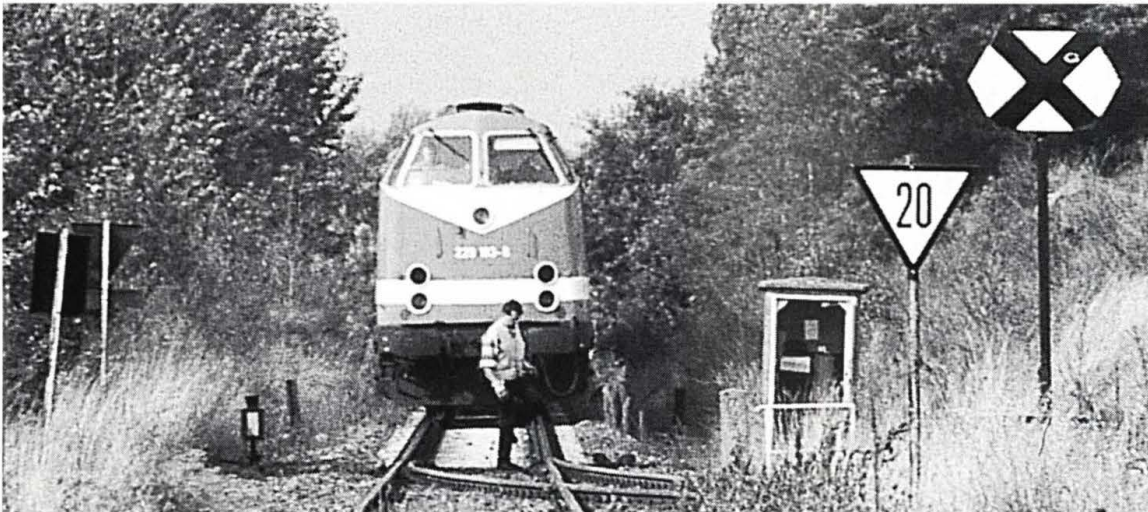
Abb. 7.18: Kreuztafel So6 (DR) anstelle eines Vor-signals und Geschwindigkeitstafel Lf4 (20 km/h) beim Ostseebad Heringsdorf
