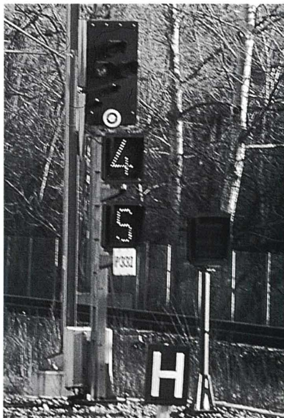
Abb. 2.6: Ks-Signal im Raum Berlin mit Geschwindigkeits- und Richtungs-Voranzeiger. Die kreisrunde Scheibe unten am Signalschirm bedeutet, daß Sh1 hier als Wärterauftrag gilt. Vor dem Signal H-Tafel Ne 5
