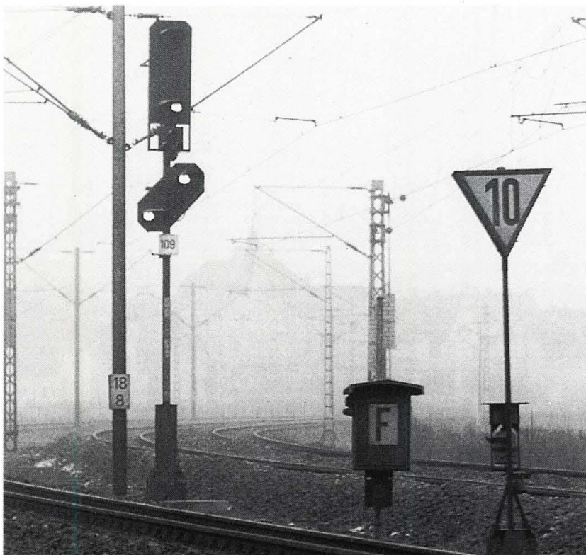
Abb. 10.9: Lf4-Tafel für Ge- schwindigkeits-Be- schränkung auf 100 km/h (10 x 10)
