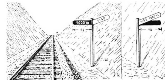
Abb. 142. Neigungsanzeiger mit Armen quer zur Bahn, links bei reichendem Raum, rechts bei beschränktem Raum.
