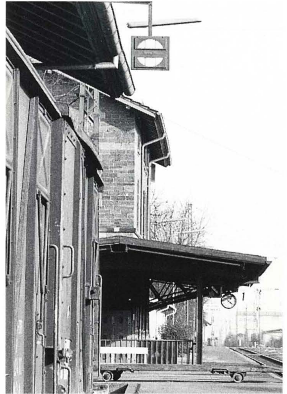
Abb. 9.4: Sh0-Gleisabschlußsignal am überkragenden Dach eines Güterschuppens
