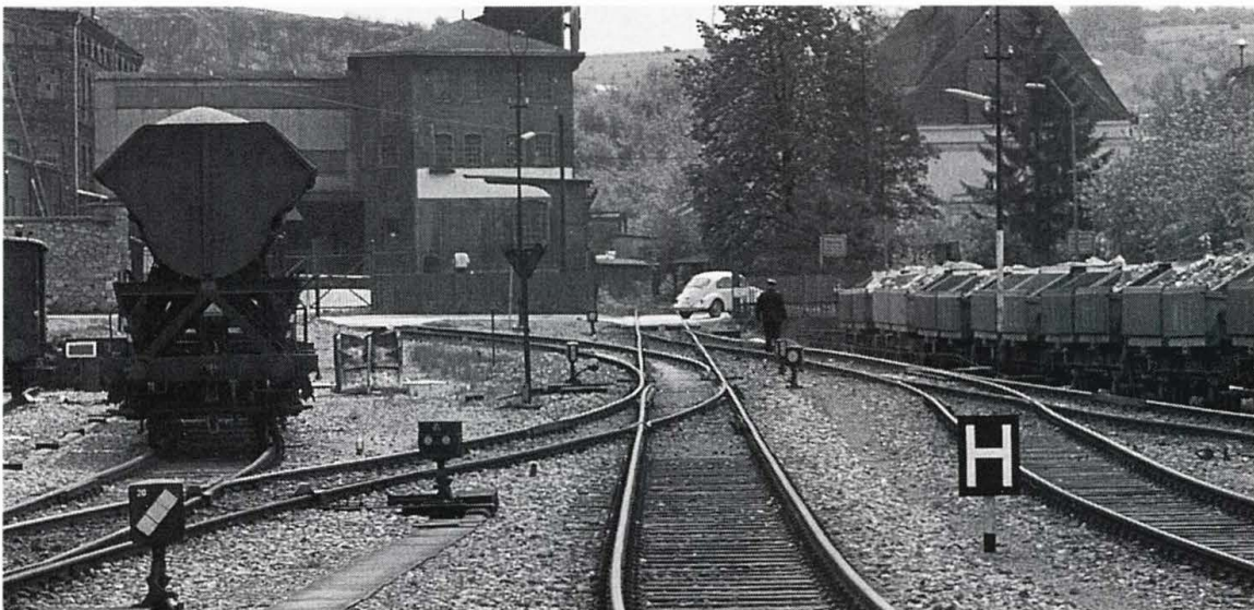
Abb. 9.10: Halte-Tafel Ne5 mit weißer Schrift (bei dunklem Hintergrund)
