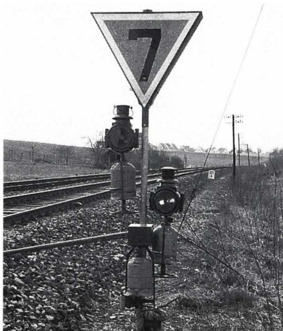
Abb. 10.1: Langsamfahr-Scheibe Lf1 für 70 km/h
