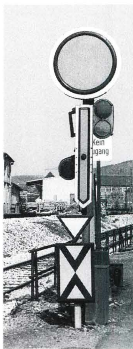
Abb. 3.3 (oben): Anordnung von Lichtsignalen bei verkürztem Bremsweg
