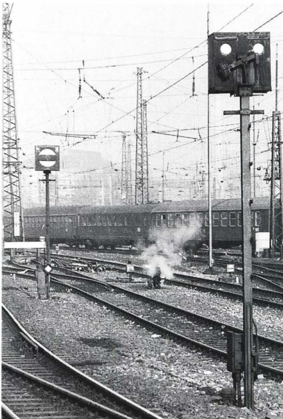
Abb. 8.8: Vorderansicht (links) und Rück- ansicht (rechts) von Form-Gleis- sperrsignalen
