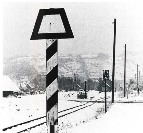
Abb. 7.8: Die Trapeztafel Ne1 ist bei ganz einfa- chen Eisenbahnen gewissermaßen der Ersatz für ein Ein- fahrtsignal: Die Züge müssen vor der Einfahrt hier erst halten.
