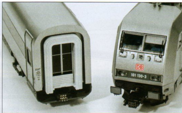
Šestipínový konektor ve spřáhle umožňuje elektrické propojení všech obvodů v celé soupravě.
