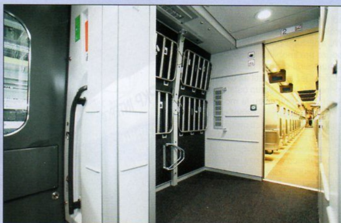
Jeden z nástupních prostorů ve vozech 14 a 15, v němž je situován prostor pro nadrozměrná zavazadla (se sklopnými policemi), stejně jako stojany pro přepravu dvou jízdních kol.
