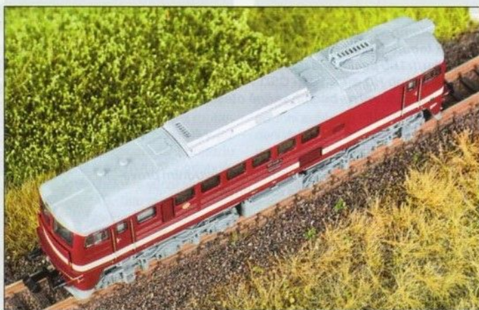
Zatímco střecha lokomotivy T 679.1006 ČSD je v provedení bez tlumiče výfuku (vlevo), stroj 120 048 DR je již osazen rekonstruovaným tlumičem výfuku VES-M (obrázek vpravo).
