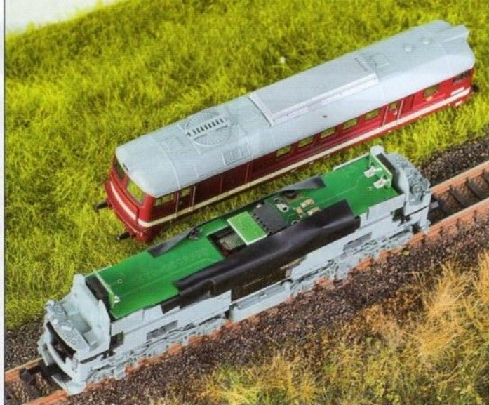
Model se sejmutou skříní: vnitřek lokomotivy a jejího těžkého rámu ze zinkové slitiny je vyplněn motorem, převody a DPS s elektronikou - dobře je vidět digitální rozhraní podle NEM 651.
