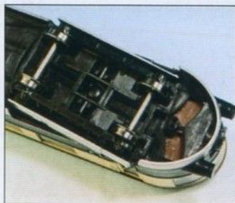
Detail podvozku koncového vozu vlaku Henschel-Wegmann. Oproti skutečnosti se i designové plentky kryjící podvozek natáčejí.
