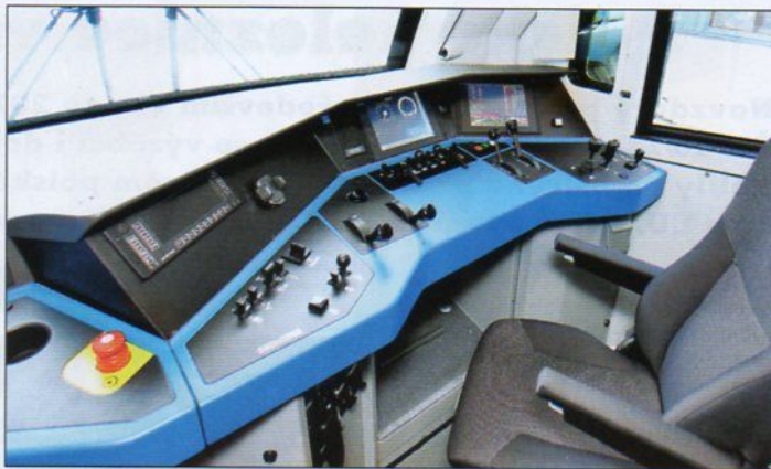
Stanoviště strojvedoucího v řídicím voze řady 80-91 ČD. Na čelním displeji jsou zobrazovány údaje řídicího systému a ETCS. Vlevo vedle něj je návěstní opakovač MIRELu VZ1 a vpravo displej diagnostiky. Zcela vlevo pak panel radiostanice.
