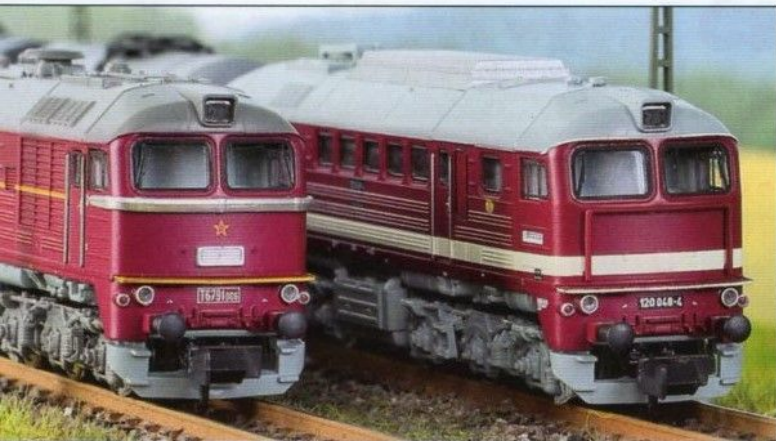
Porovnání čelních partií obou lokomotiv - vlevo verze ČSD, vpravo zjednodušené provedení DR s madlem pro lepší bezpečnost obsluhy při mytí čelních skel.
