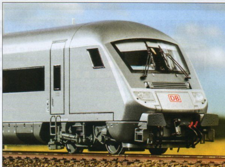
Čelo řidičeho vozu soupravy odpovídá standardnímu provedení vozů řady Bpmbdz 297 .
