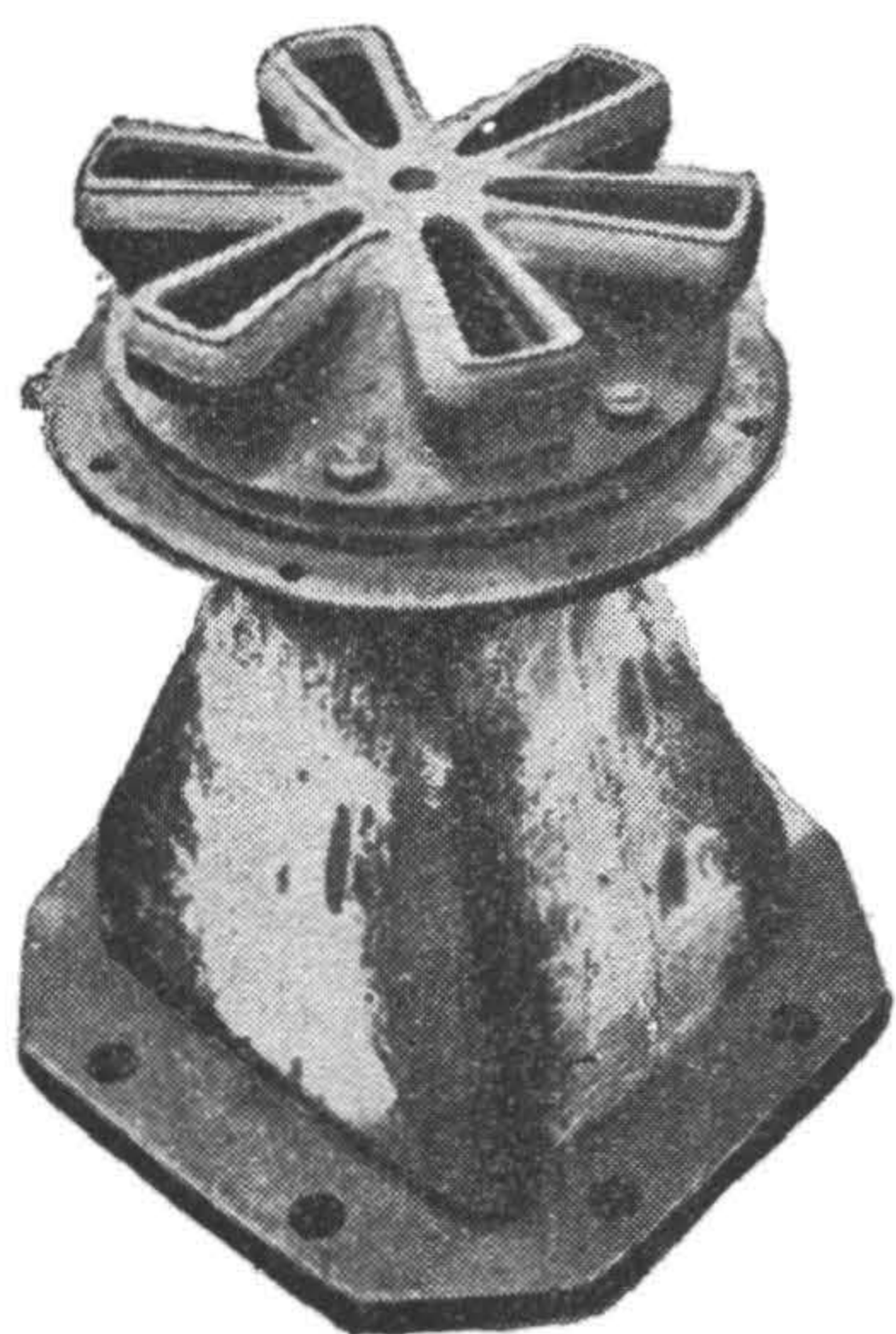
Фиг. 131. Конус паровозов 1—4—2 ИС и 1—5—1 ФД.
