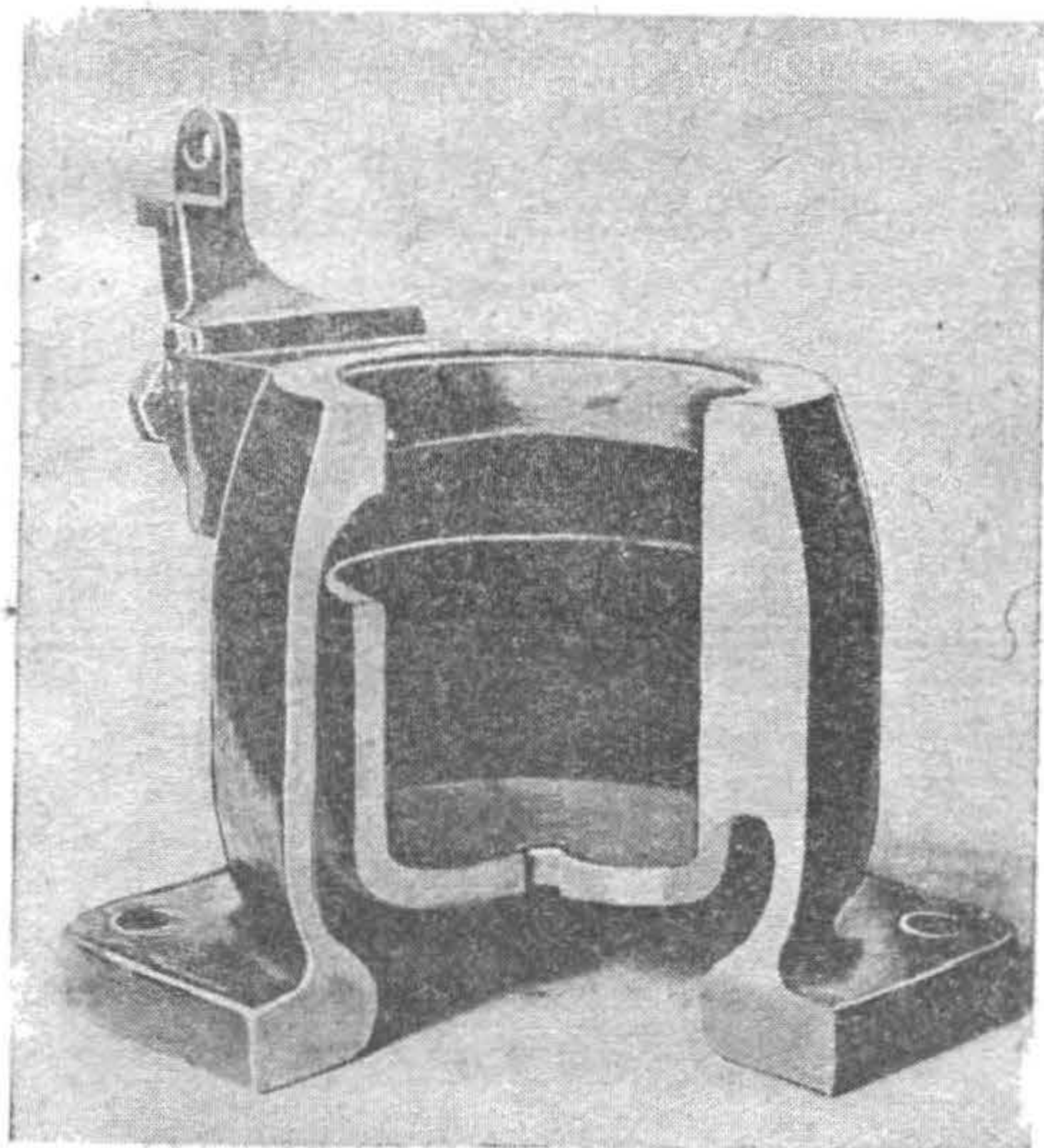
Фиг. 29. Головка регулятора паровоза 1—3—1 С. Фиг. 30. Регулятор паровоза 1—3—1 С. (разрезная модель).
