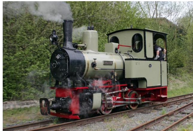
Diese kleine Tenderlok besitzt seitliche Wasserkästen. Der geringe Vorrat an Kohle befindet sich im Führerhaus.
