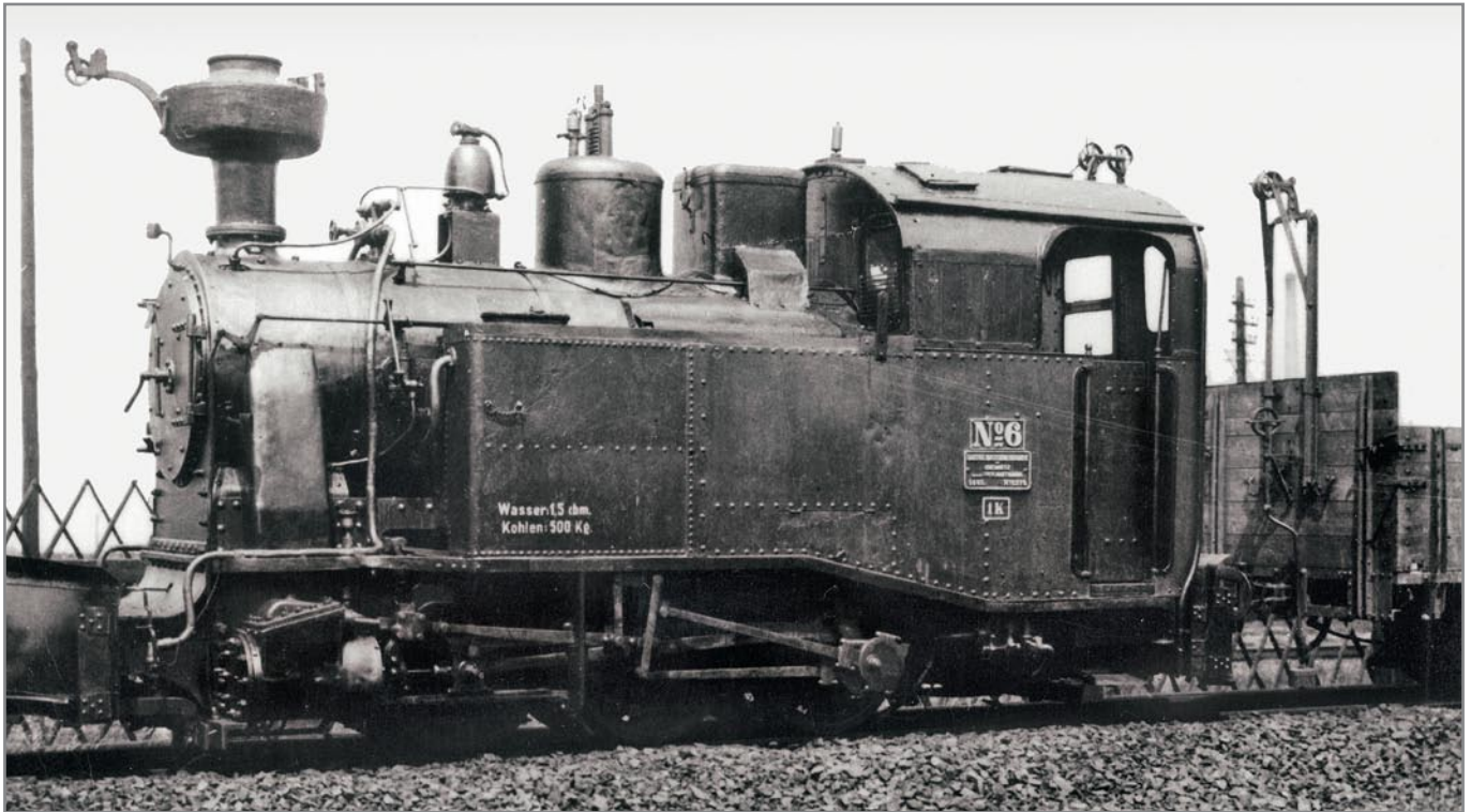
In Chemnitz ließen die Königlich Sächsischen Staatseisenbahnen und die Zittau-Oybin-Jonsdorfer Eisenbahn die dreiachsigen Lokomotiven für ihre Schmalspurstrecken bauen. Sie erhielten die Gattungsbezeichnung V TK, später IK.
