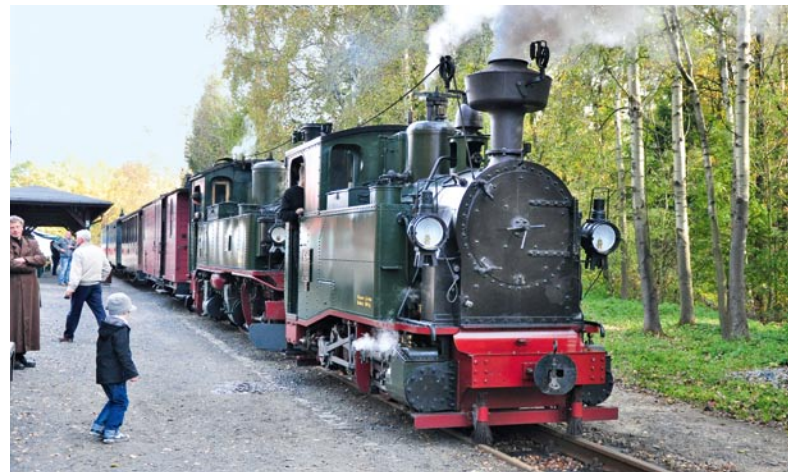
Mit zwei unterschiedlichen Arten von Schornsteinen, Kegel und Kobel führen die IK-Lokomotiven auf den sächsischen Strecken (Bertsdorf 2010).
