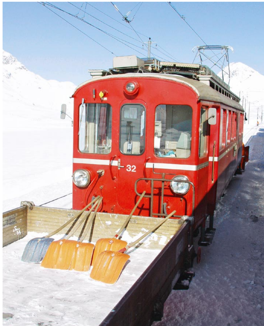
Im Einsatz: Der Arbeitszug, bestehend aus dem ABe 4/4 32 und einem Niederbordwagen, dient zum Abtransport der Schneemassen aus dem Bahnhofsbereich.
