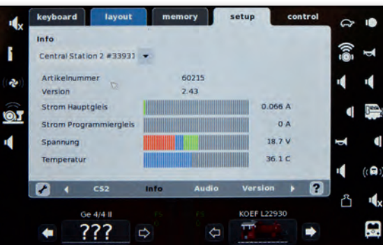
Ampere-Messung: Die Central Station 2 zeigt auf Wunsch den realen Stromverbrauch in Echtzeit an.
