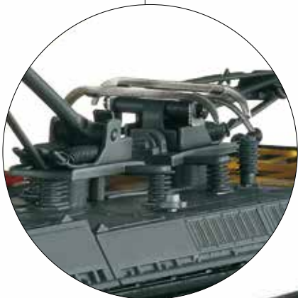
Abgasöffnung mit Krampe im Dach
