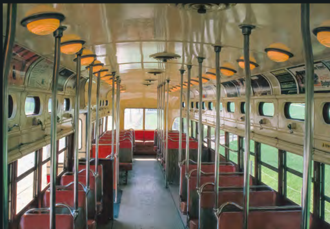
Sehenswert ist das Interieur eines PCC-Wagens: Sitzteilung 1+2, Beleuchtung durch abgedeckte Glühlampen, Lüftungsöffnungen im Dach und die kleinen Kurbeln für die Fenster fallen auf
