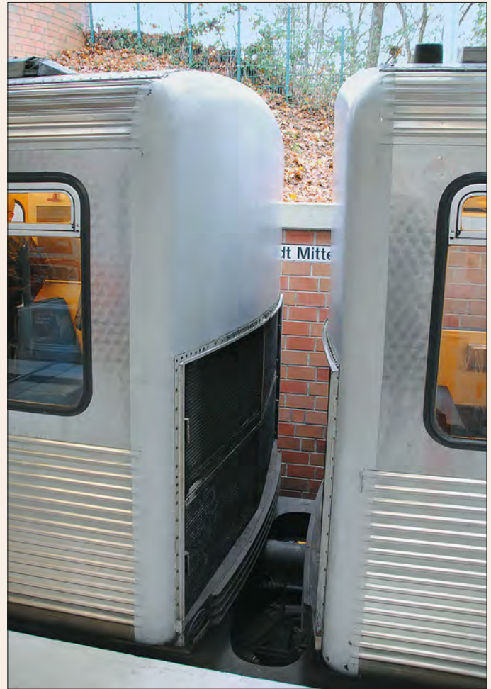
Kein Durchblick und natürlich auch kein Durchgang: die beiden Wagenenden über dem gemeinsamen Mitteldrehgestell
