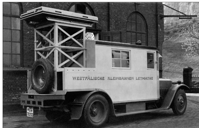
Im eingefahrenem Zustand erreicht die Montagebühne eine Höhe von 2,80 Metern, zwei Turmsegmente weniger als auf Bild links mit voll ausgefahrner Bühne. Die rechte Fahrzeugseite wies keine Tür auf
