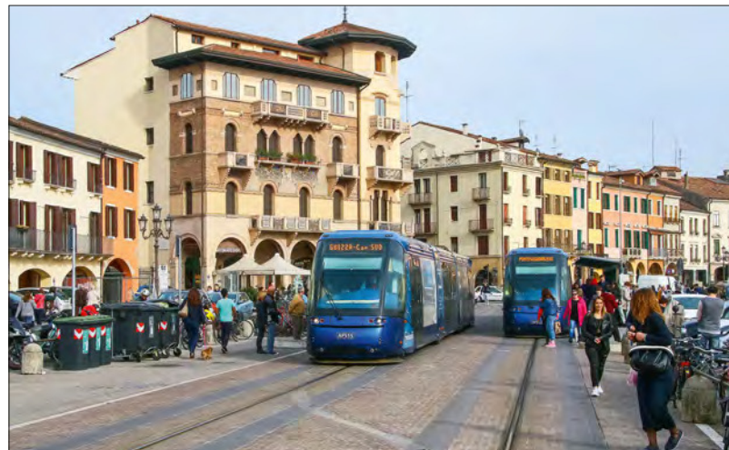
Begegnung zweier Translohr an der Prato della Vale in Padova im oberleitungsfreien Abschnitt, hier sorgen Batterien für Strom
