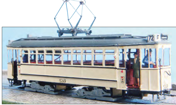
Der TD 07/25 der Ost-Berliner BVG war René Felgentreus erster Eigenbau, den er aus Teilen eines Fröwis-Messingbausatzes (West-BVG) fertigte. Sein Modell bekam ein Tonnendach, Antrieb und Digitalsteuerung
