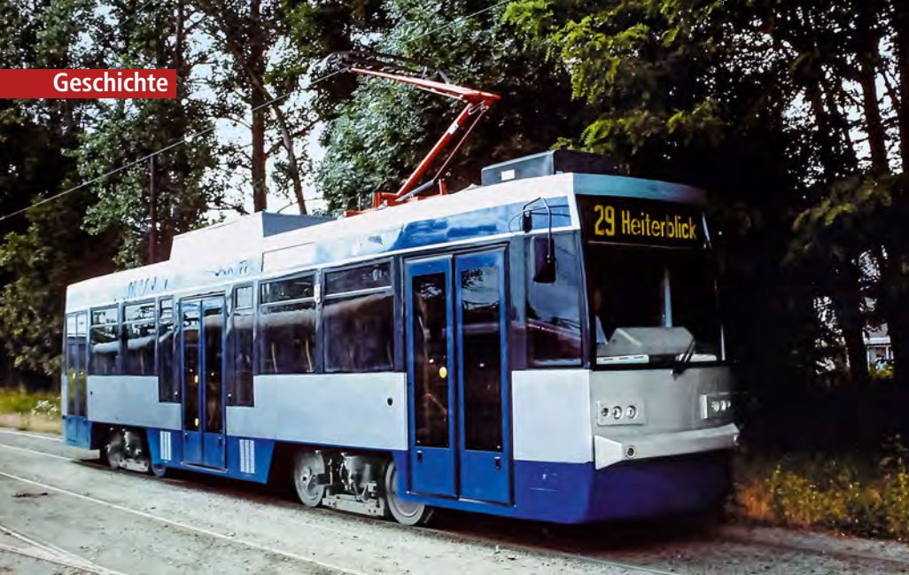
Ganz frisch aus der Generalreparatur kommt dieser Prototyp des modernisierten niederflurigen ehemaligen T4D – heutige Bezeichnung NFTW4. Dieser Wagen war ursprünglich für Stettin gedacht, heute schleift er in Leipzig die Schienen – als modernster Arbeitswagen Europas
