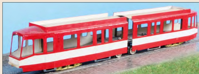
Für den Bau des Stadtbahnwagen-Prototypen Nr. 600 aus Hannover hat Jurkowski einmal Schoellershammer-Aluminiumkarton ausprobiert
