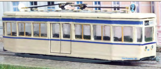
Der zweiachsige Essener „Montos“-Niederflurwagen mit Lenkfahrgestell ist ein über 30 Jahre altes Lindemann-Frühwerk
