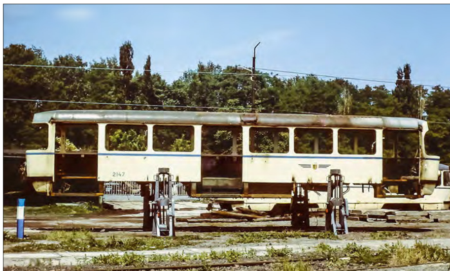
Im Sommer 1991 begann die Modernisierung der zahlreichen Tatrawagen. Hier steht die Hülle des Triebwagens 2147 und wartet auf das Sandstrahlen. Dieser Wagen ist noch heute im Einsatz
