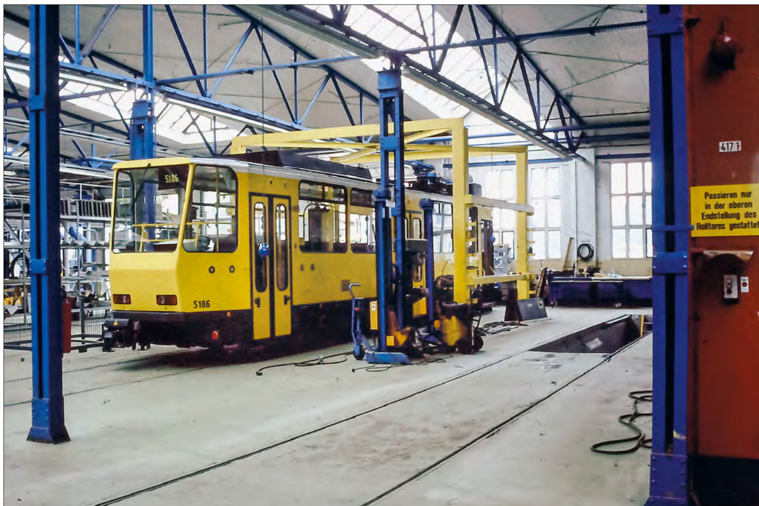
Ein Berliner in Leipzig! Der Triebwagen hatte einen Unfallschaden und wird in Leipzig instandgesetzt. Die Aufnahme entstand im Spätsommer 2003. Solche Arbeiten zählten jahrelang zu den üblichen Aufgaben der Hauptwerkstätte
