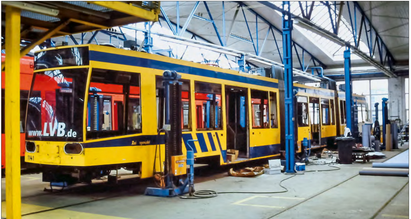
In Hauptuntersuchung befindet sich Tw 1141 des Typs NGT8 aus dem Jahre 1997. Nach nur sechs Jahren Einsatz erfolgte diese Prozedur 2003
