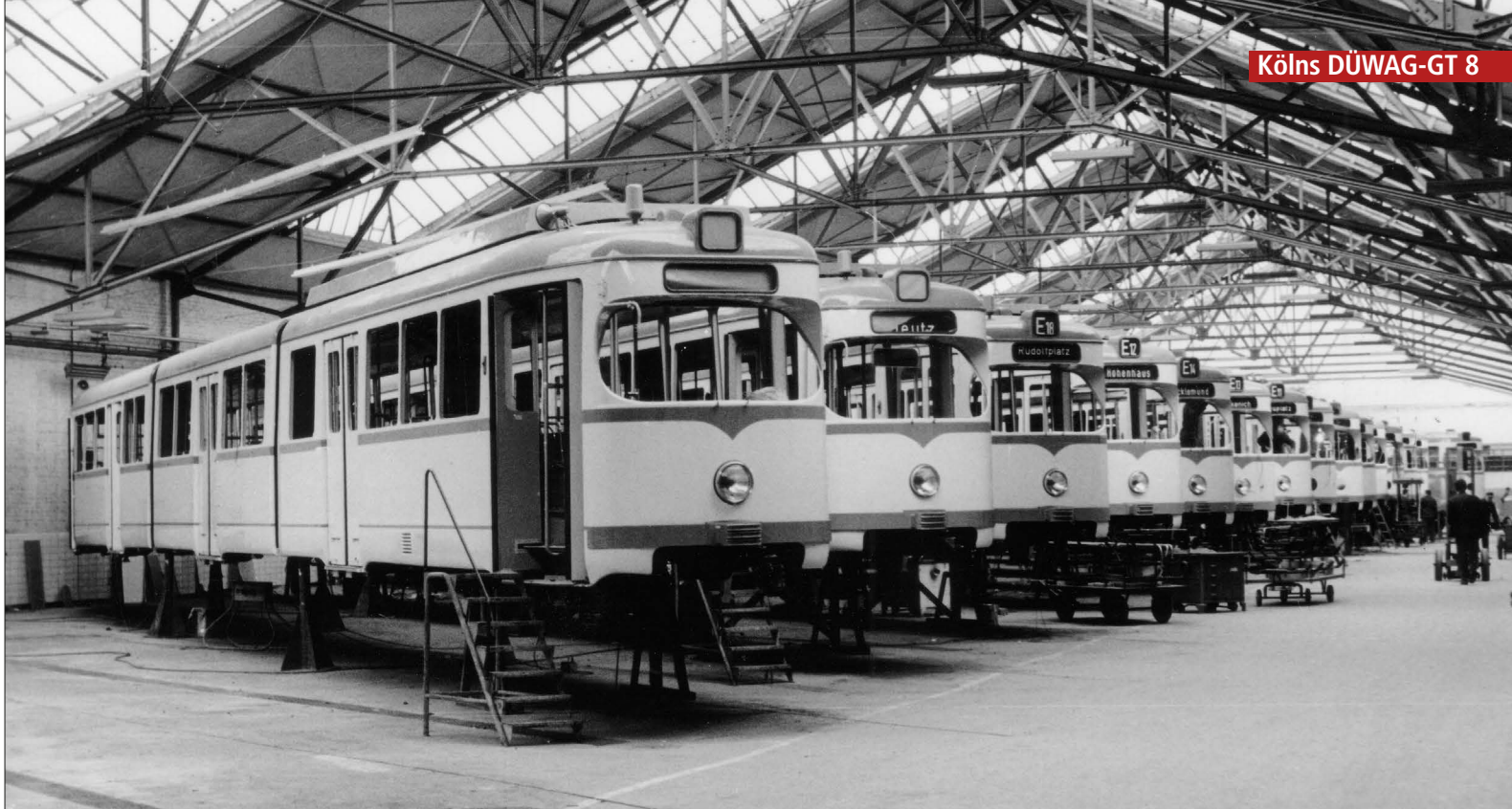
So sah es 1968 in einer Werkhalle der DÜWAG aus: Achtachser der Serie 3000 mit Heckteil aus Beiwagen so weit das Auge reicht – die Umbauarbeiten liefen damals auf Hochtouren
