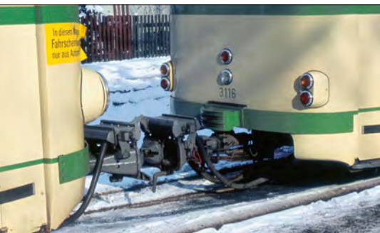
Kuppelvorgang von zwei Wagen der Serie 3100, die hier noch mit den ursprünglichen Scharfenbergkupplungen ausgestattet sind
