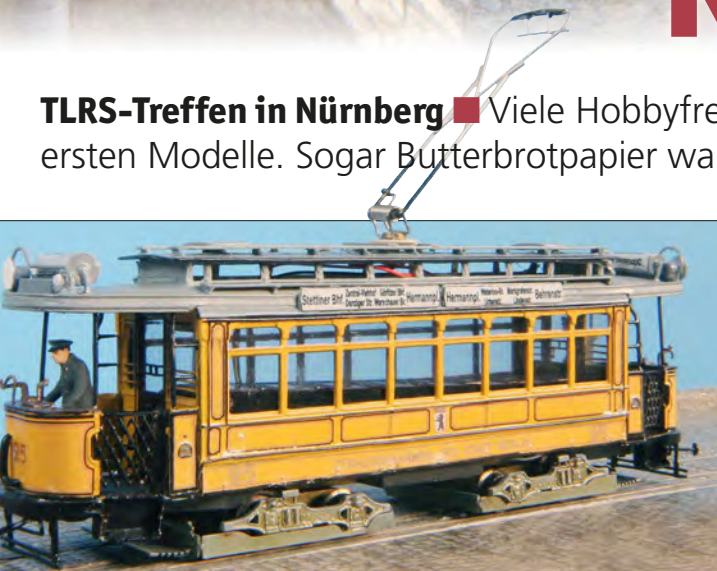
Seinen Berliner TD 08/24 hat René Felgentreu aus Messinggätzteilen von Fröwis gebaut. Motorisiert wurde er mit einem angepassten SB-Antrieb
