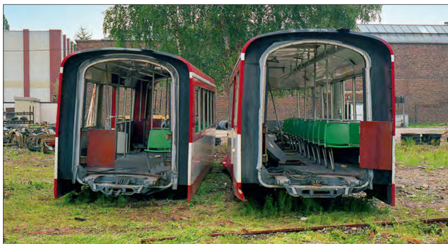
Was nicht verkauft werden konnte, wanderte in den Schrott. Dabei geben 1996 in der Hauptwerkstätte zwei Fahrzeugteile seltene Blicke auf die Gelenkverbindung frei AXEL REUTHER (2)
