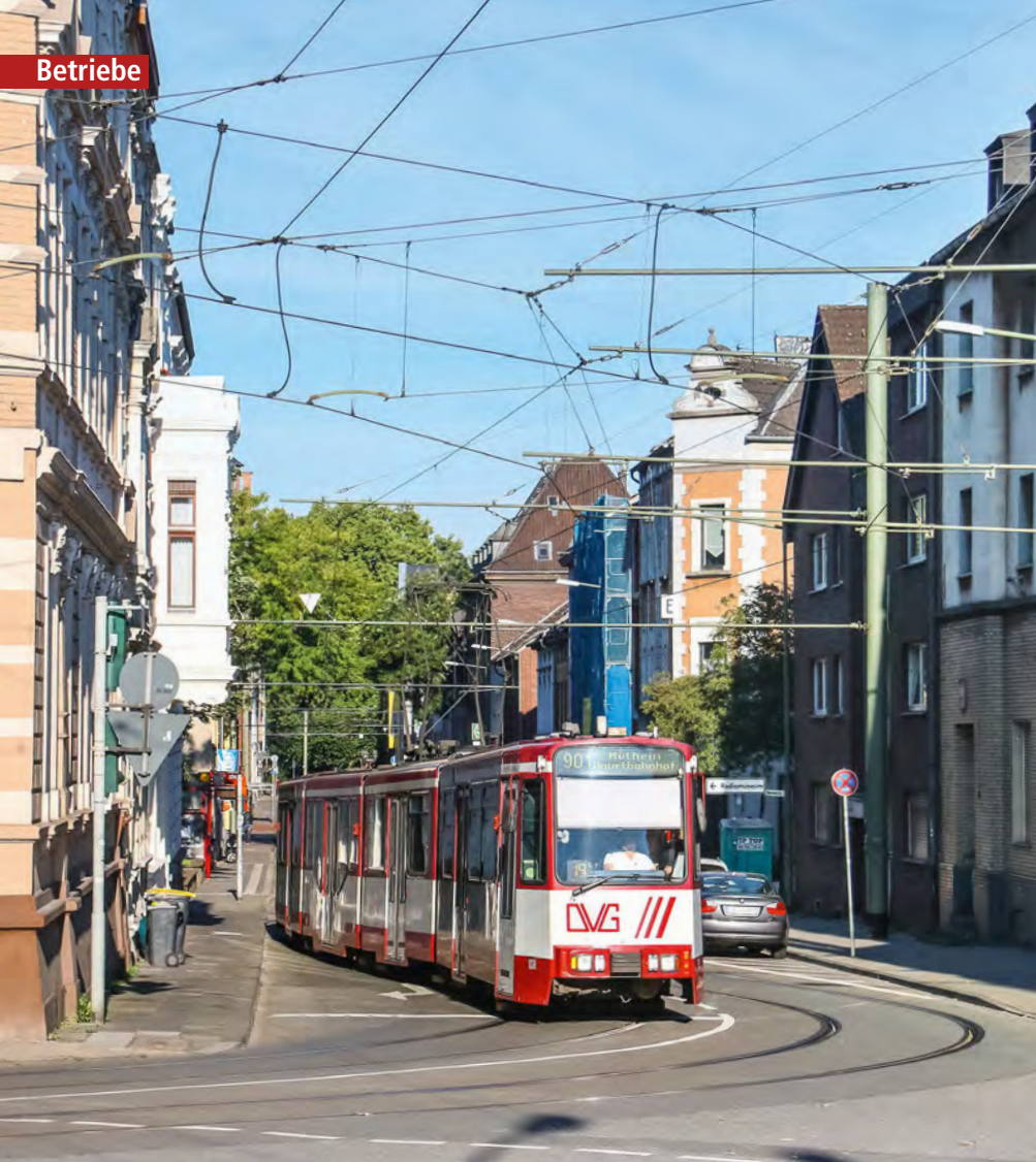
Dieser enge Gleisbogen in Ruhrort ist noch einer der wenigen Knackpunkte im Netz: Ihn dürfen bislang nur 2,20 Meter breite Fahrzeuge durchfahren. Für neue Fahrzeuge müsste hier eine Lösung gefunden werden, zum Beispiel ein Begegnungsverbot
