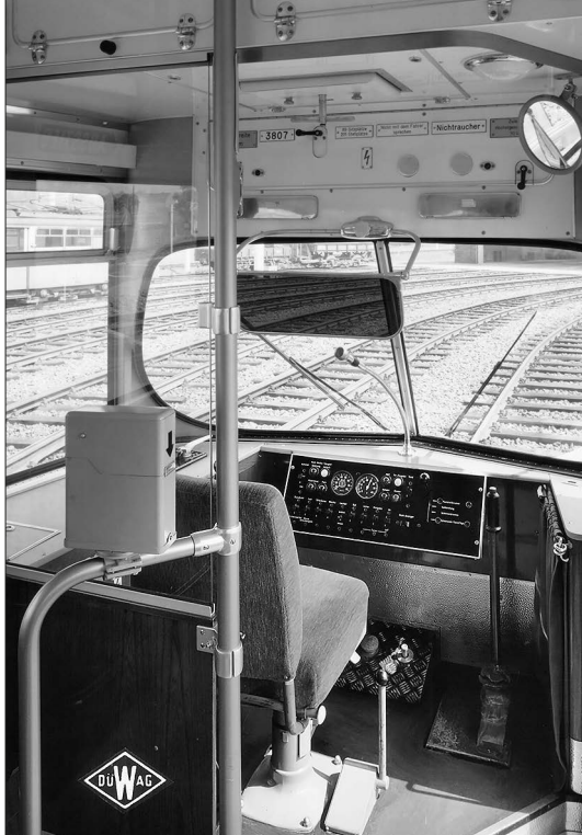
Blick in den recht spartanisch ausgestatteten Führerstand eines Achtachser im Jahre 1965. Links ist einer der ersten Fahrscheinentwerter montiert WERKFOTO DÜWAG, SLG. AXEL REUTHER
