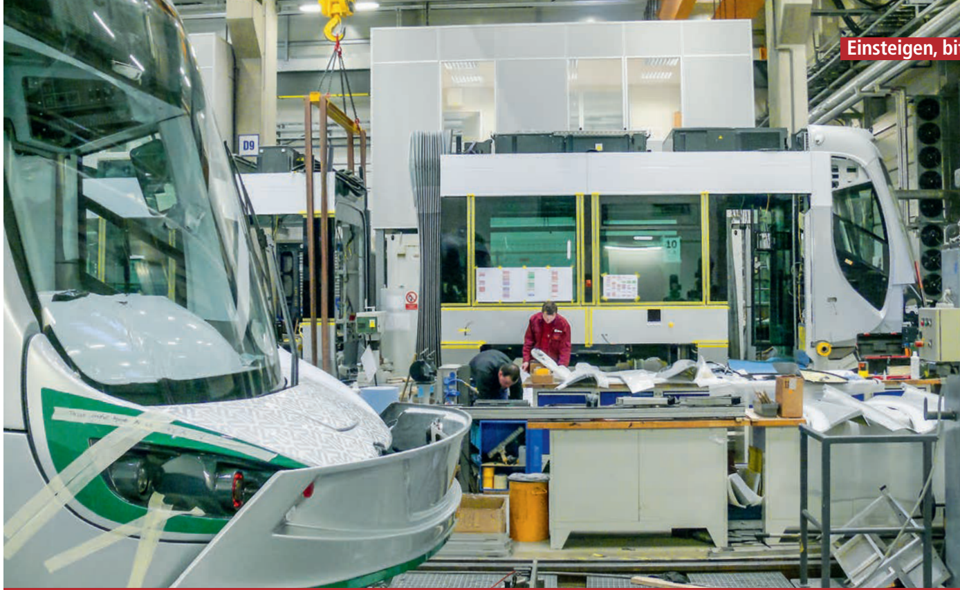
Montage von ForCity-Classic-Wagen für die türkische Stadt Konya im Pilsener Skoda-Werk, wo Lokomotiven und Straßenbahnen gebaut werden. Hier werden auch die weitgehend identischen Bahnen für Chemnitz entstehen
