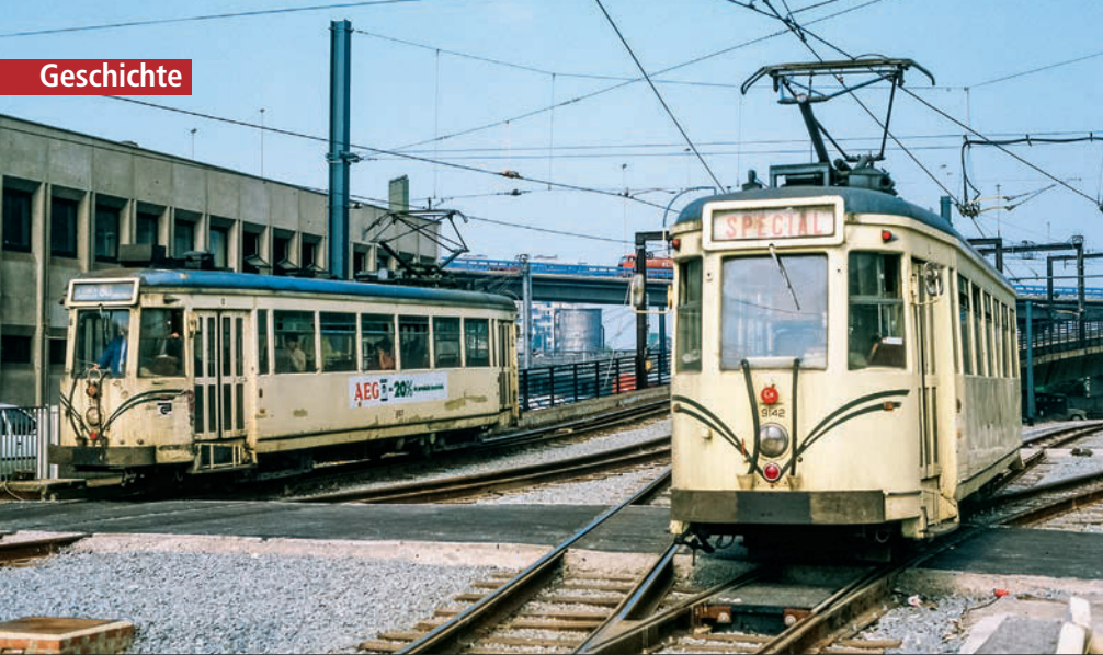
Am „Schnurrbart“ erkennbar sind die Wagen, die für den Stadtbahnbetrieb in Charleroi beispielsweise durch Klapptrittstufen ertüchtigt worden sind, hier gleich zwei Exemplare am Bahnhof Charleroi Sud, Ausgangspunkt der meisten Linien, am 18. Juni 1986
