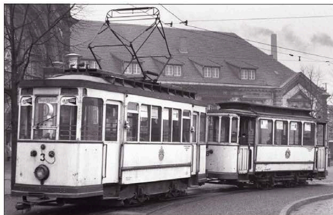
Osnabrücks Tw 3 steht im November 1957 mit der nachgerüsteten Kohlestütze im Stemann-Stromabnehmer „BS 3“ vorm Hauptbahnhof. Die Unterscheren-Verbindungsstange ist bei diesem Fahrzeug gekröpft
