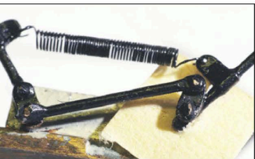
Die Parallelführung der Arme erfolgt wie im Original durch die Stabilisierungsstange. Die Pappe dient als Distanzhalter beim Lötten
