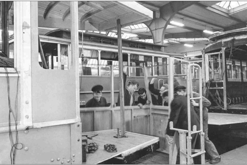
TW 3006 als V2U mit V2 BW besitzt 1956 schon neue Dachlinienkästen
