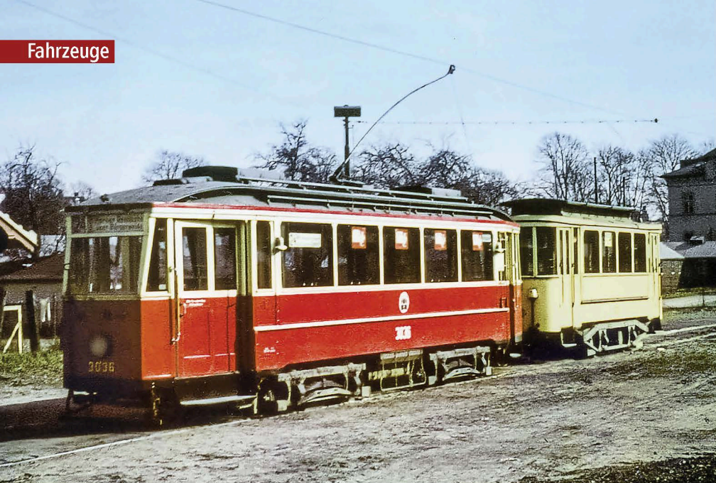
V2U-TW mit Zweiachsanhänger im Jahr 1939 in der Schleife Tarpenbekstraße. Der TW 3036 entstand aus einem ehemaligen Beiwagen mit dreifenstriger Stirnfront
