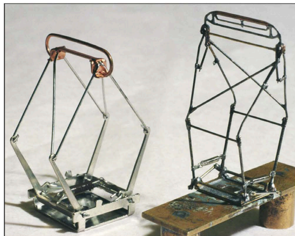
Spühs H0-Stromabnehmer im Vergleich mit Fertigprodukten. Der Sommerfeldt-Pantograf (linkes Bild) ist stark vereinfacht. Der rote Roco-Bügel (rechtes Bild) hat zwar Wippenfedern, aber deren Zug ist so stark, dass sich die Wippe nicht bewegen lässt. Der Bügel drückt viel zu stark nach oben
