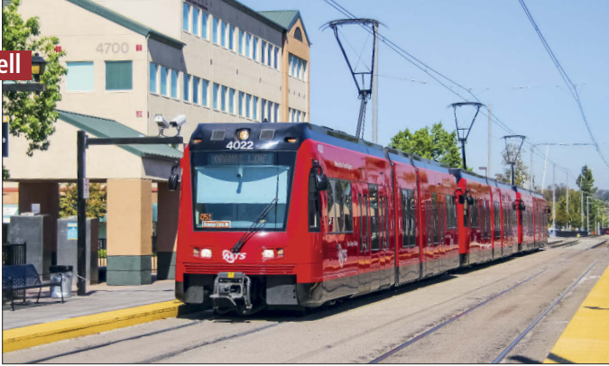
Siemens: Bereits seit 2004 werden in San Diego Fahrzeuge des Typ S70 eingesetzt, die jüngst bestellte Serie erhält ein gegenüber den Bestandsfahrzeugen neu gestaltetes Mittelteil
