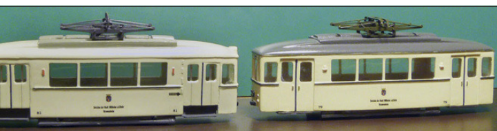
Mülheim erhielt in den 1930er-Jahren moderne Niederflurfahrzeuge, ähnlich den Düsseldorfern (rechts). Nach dem Krieg wurde ein Fahrzeug zum Einrichtungswagen umgebaut (links). Der Triebwagen erhielt dabei moderne elektrische Düwag-Türen GUIDO MANDORF (14), OLGA BANDELOWA (2)
