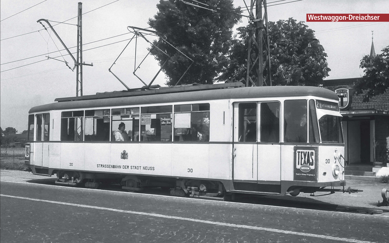
Tw 30 der Straßenbahn in Neuss gehörte zu den ersten Vertretern der fünffenstrigen Großraumtriebswagen der Westwaggon. Sie hatten noch die kantigeren Fronten, die den Wagen förmlich alt aussehen lassen
