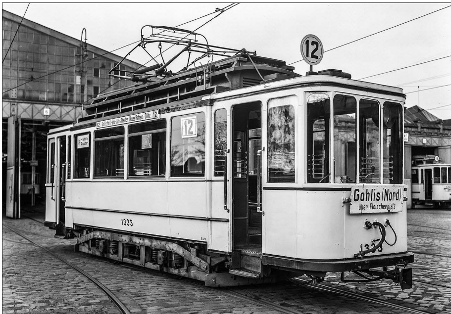
Auf der rechten Zufahrt zum Hallengleis steht nach 1928 ein Triebwagen des Typs 21 (Baujahr 1914) für die auch hier stationierte Linie 12. Im Bild ist gut die vor 1928 bauseitig erfolgte Zusammenfügung der bisher getrennten drei Hallen ersichtlich
