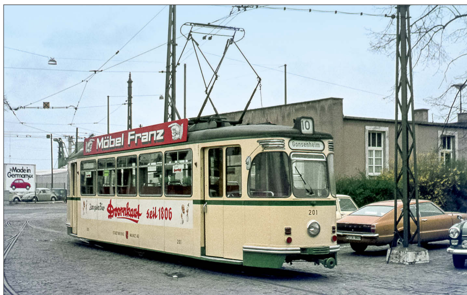
Eine Ende der 1960er-Jahre nachträglich angebrachte grüne Zierleiste unter den Fenstern veränderte das Aussehen der Dreiachser, wobei sie teils auch von der Seitenwerbung überdeckt wurde. Tw 201 zeigt sich so im Juni 1973 vor dem Depot
