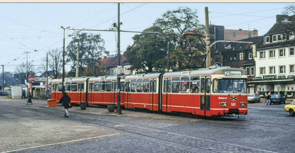
Das vierachsige Ursprungsfahrzeug 561 mit bereits verschweißten Fahrwerksaussparungen in Gröpelingen auf der Linie 2 mitsamt passendem Gelenk-Beiwagen
