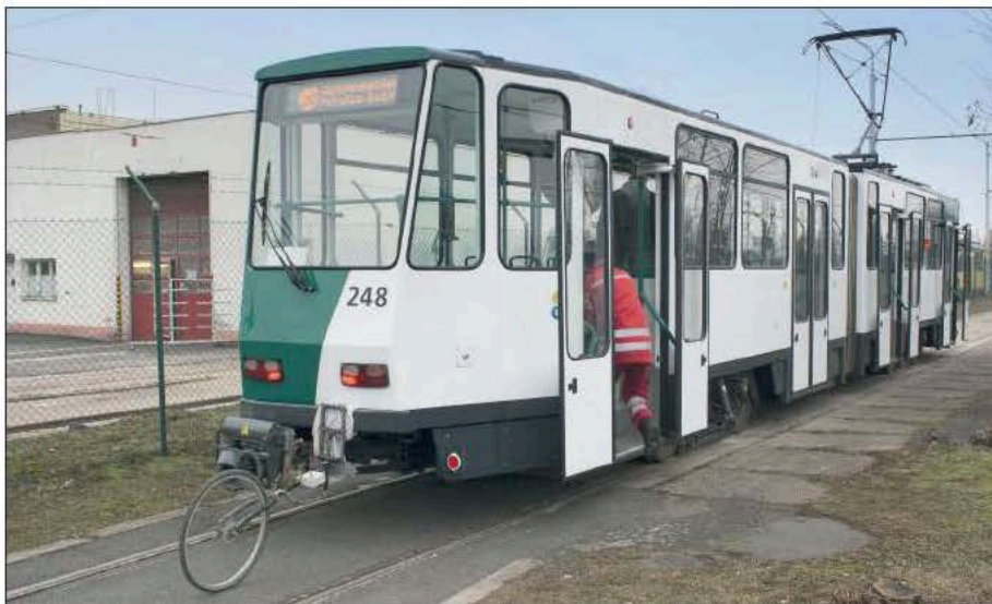
Bremsproben am 22. Dezember 2016 auf dem Prüfgleis der Prager Hauptwerkstatt: Zu sehen ist ein Peiselerrad, mit dem die Geschwindigkeiten und Bremswege ermittelt werden
