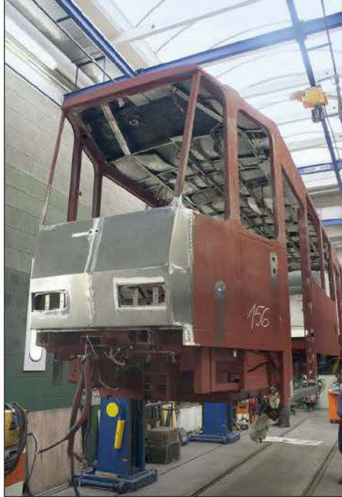
Das B-Teil von 156 nach dem Schweißen. Im Projektverlauf fiel die Entscheidung, alle Front- und Heckbleche auszutauschen. Zu erkennen sind die Bohrungen für die zusätzlichen Türöffner
