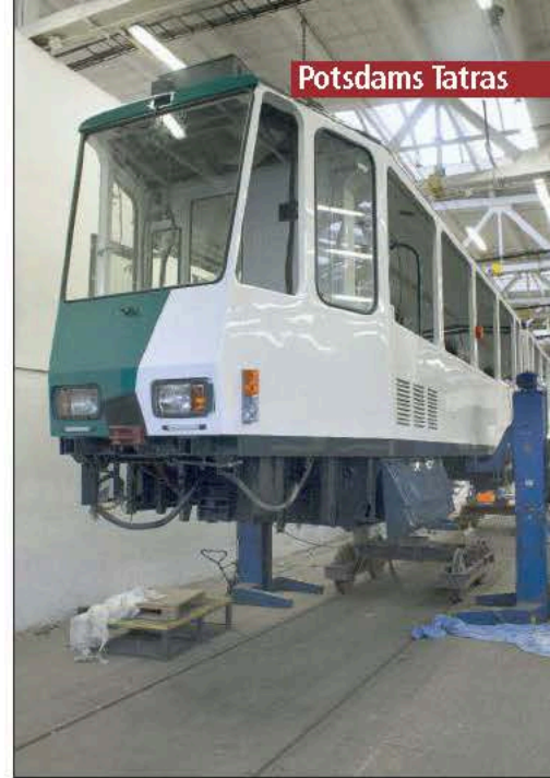
Nummer 148 in der Montage. Die neu hinzugekommenen Tagfahrleuchten sind montiert, und die frische Lackierung glänzt prächtig
