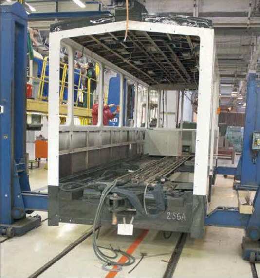
Nach der Lackierung der Wagenkästen wird der neue Fußboden eingebaut, hier steht das A-Teil von 256 für diese Arbeiten bereit
