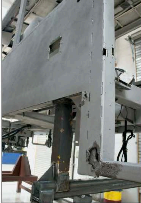
Details an Wagen 248 nach dem Sandstrahlen: Es zeigen sich offensichtlich geschädigte Bereiche, welche einer gründlichen Reparatur bedürfen
