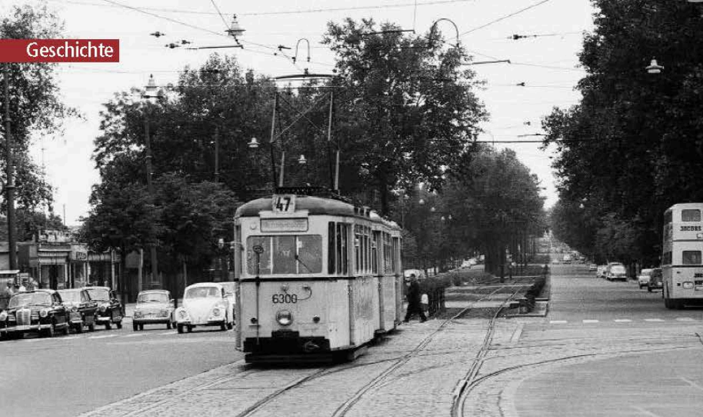
Die Modernisierung des Wagenparks der BVG-West war keine Erfolgsgeschichte. Sechs Aufbau-Tw auf alten Untergestellen und acht Leichtbau-Bw nach Verbandstyp-Normalien kamen ab 1951 zum Einsatz – dabei blieb es (Britz, Buschkrug, Mai 1963)
