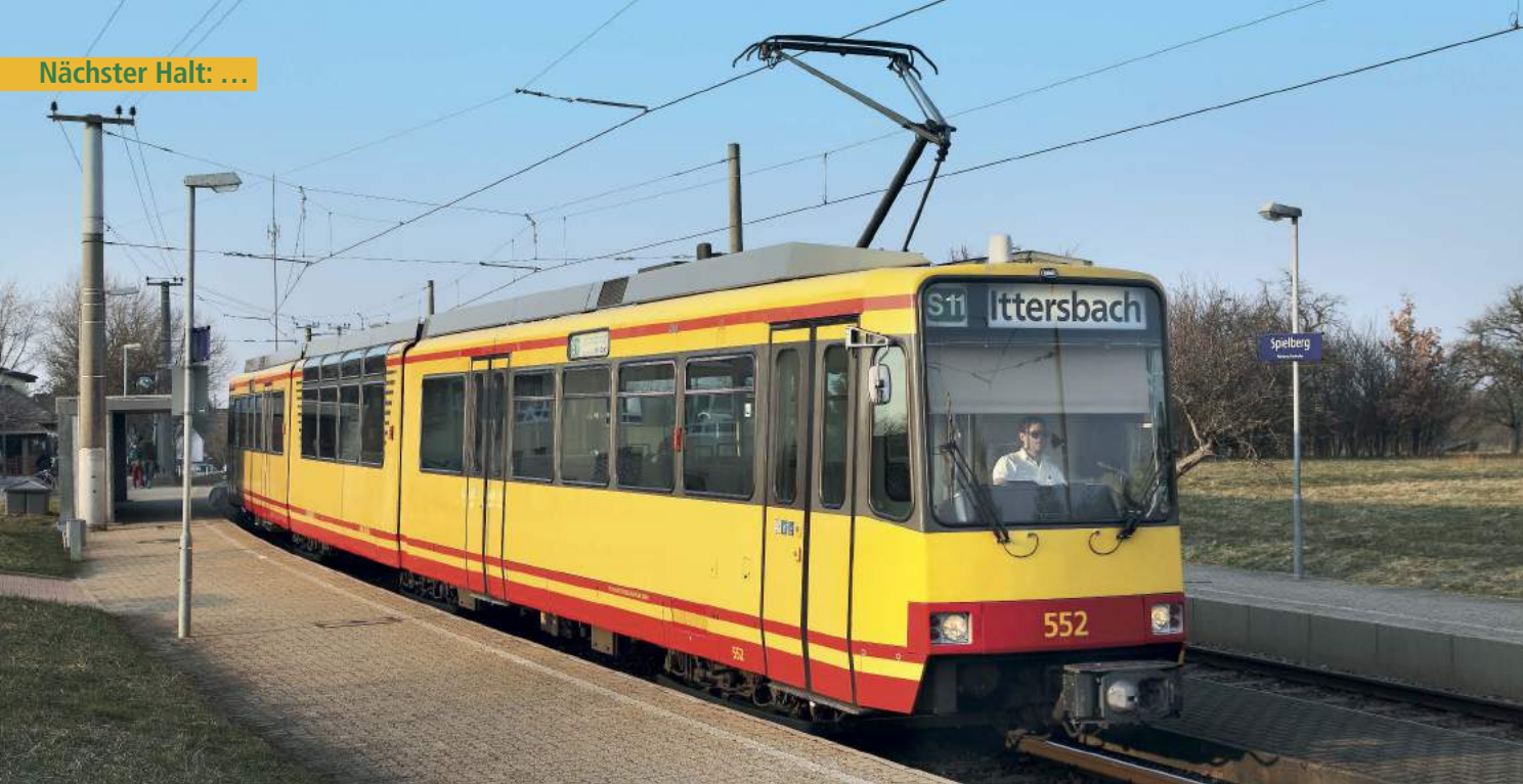
Noch zwei Zwischenhalte, dann hat der Wagen 552 den Endbahnhof Ittersbach erreicht. Der 1989 von Düwag gebaute Achtachser zählt mit seiner großzügigen Verglasung des Mittelteils zu den Panorama-Triebwagen der Albtalbahn
