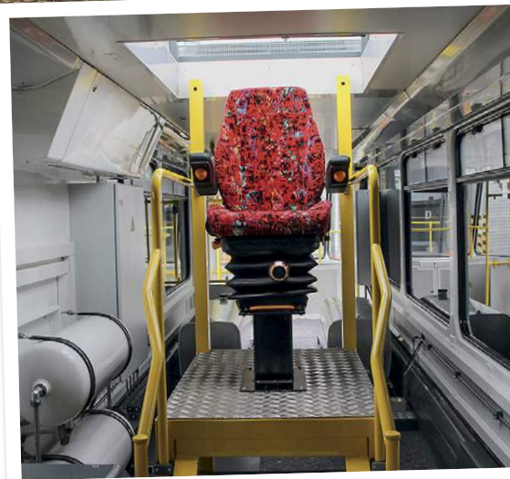
Im Arbeitstriebswagen 703 gibt es einen speziellen Fahrdrabtbeobachtungsplatz
