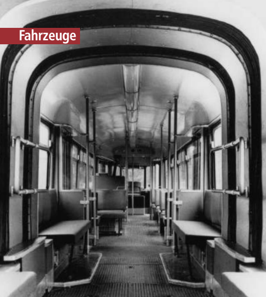
Die Mainzer Wagen von innen: Links erkennt man Quer- und Längssitze sowie den erhöhten Schaffnerplatz, in der Mitte der Fahrerstand und rechts ein Türbereich der nicht genutzten Fahrzeugseite mit Abdeckungen über den Trittstufen
