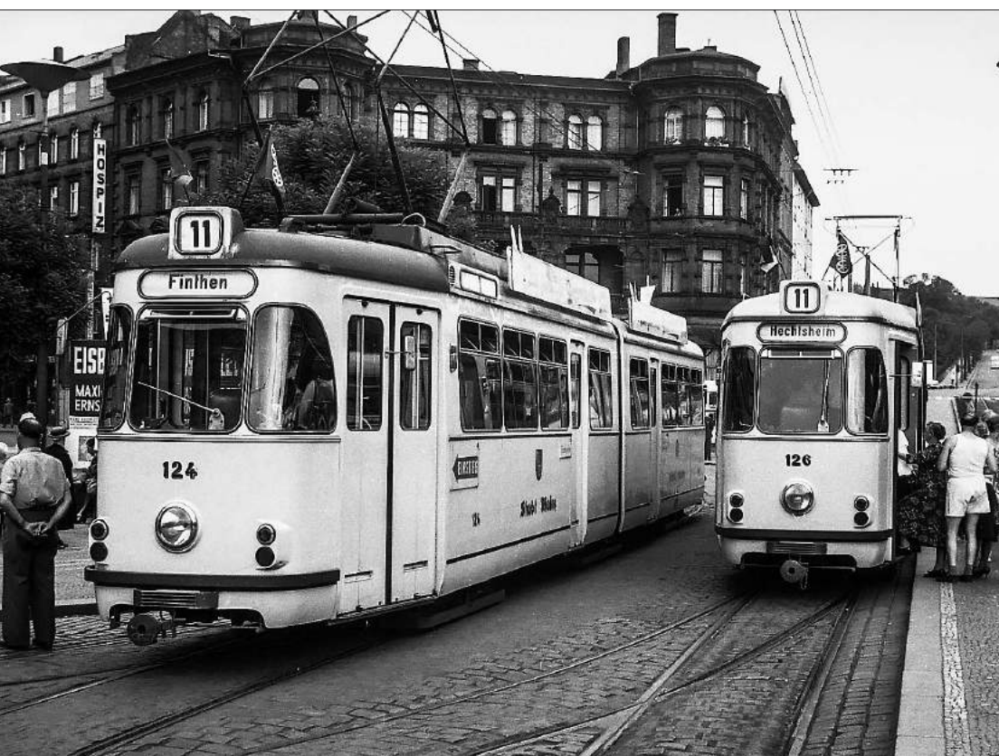
Vor dem Mainzer Hauptbahnhof begegnen sich 1959 die Tw 124 und 126 auf der Linie 11. Die Klapp-schilder neben den Türen zeigten die gültige Abfertigung mit einem oder zwei Schaffnern an. Noch tragen die Wagen lediglich Dachkanten-Werbung
