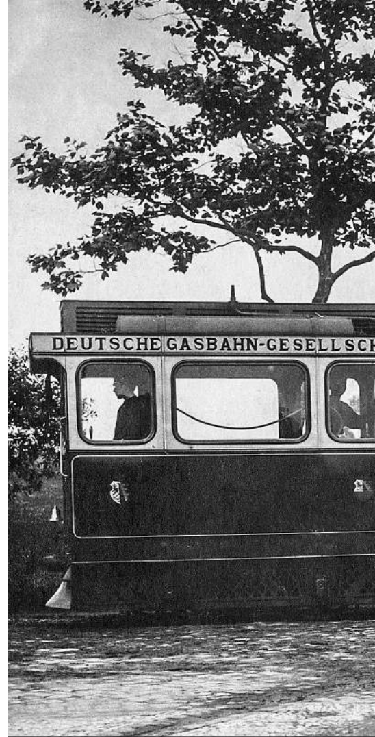
RECHTS Versuchsfahrten von Gaslokomotive 1 der Deutschen Gasbahn-Gesellschaft Dessau als Nr. 24 im Frühjahr 1897 mit einem Zug der Dessauer Straßenbahngesellschaft
