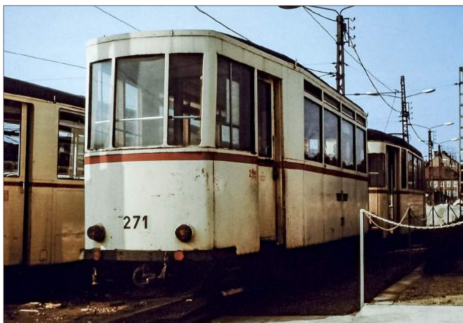
Aus dem ehemaligen Triebwagen 117 wurde der Beiwagen 271 hergestellt. Da dieser Wagen elektrisch verschließbare Türen hatte, wurde er noch bis 1983 eingesetzt
