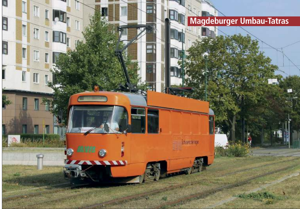
Am 14. September 2016 ist der Schienenschleiftriebwagen 708 am Universitätsplatz im Einsatz, er bleibt auch weiterhin als Winterdienstfahrzeug im Fahrzeugbestand
