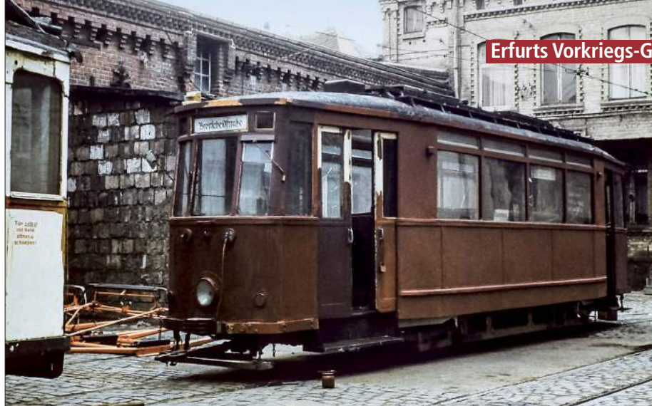
1979 wurde aus Gotha der Arbeitswagen 006 übernommen. Er wird hier mustergültig von Erfurter Nahverkehrsfreunden im Betriebshof Breitscheidstraße (heute Magdeburger Allee) als historisches Fahrzeug 92 restauriert und 1983 fertig gestellt
