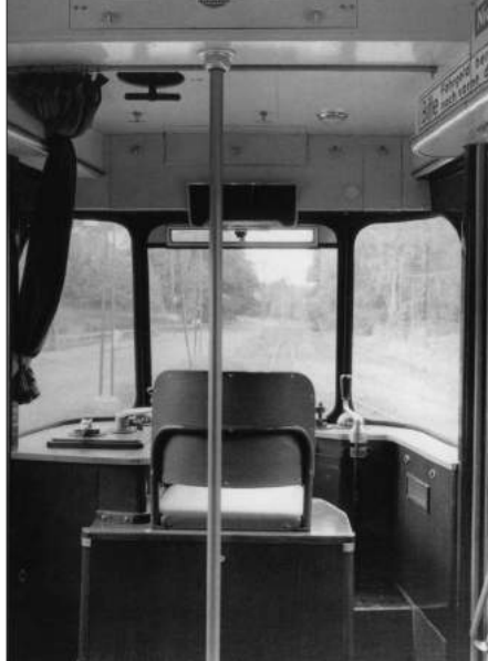
Die Mainzer Wagen von innen: Links erkennt man Quer- und Längssitze sowie den erhöhten Schaffnerplatz, in der Mitte der Fahrerstand und rechts ein Türbereich der nicht genutzten Fahrzeugseite mit Abdeckungen über den Trittstufen
