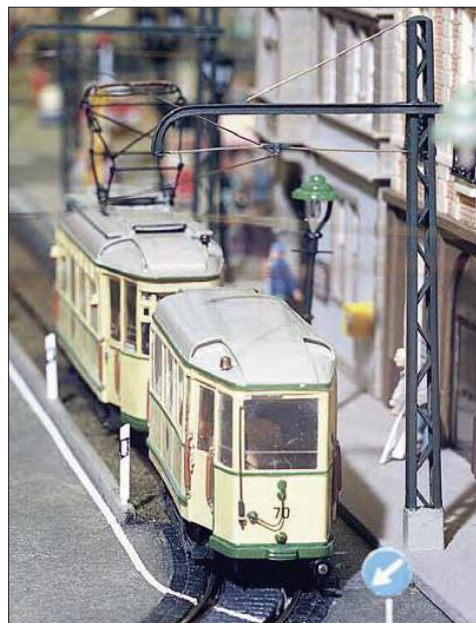
Um die für die am 29. Mai 1960 eingestellte Osnabrücker Straßenbahn typischen Fahrleitungsmasten zu bauen, hat Alfred Spühr Masten von Sommerfeldt gekürzt, die Schraube anschließend wieder mit Stabilit eingeklebt und den Sockel mit einem Pappstreifen dargestellt (kl. Foto). Für die Ausleger wurden Messing-U-Profile (0,75x1,5 mm) gegeneinander gelötet und dann gebogen
