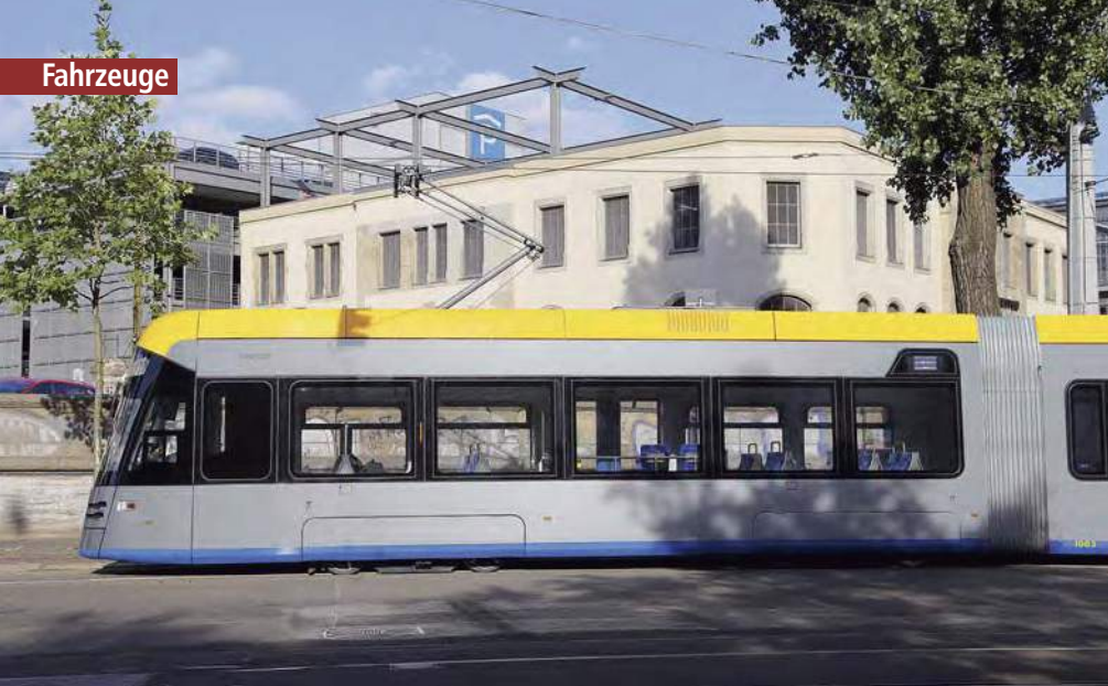
Markante Seitenansicht des Tramino XL von Solaris. In einem Display kurz vor dem Faltenball wird die Liniennummer angezeigt, das Drehgestell ist voll verkleidet
