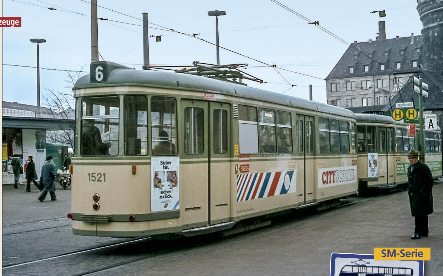
Seitenansicht des Beiwagens 1521 am Hauptbahnhof 1976. Gut sind der Stromabnehmer und das verschlossene Fenster über dem hinteren Drehgestell erkennbar
