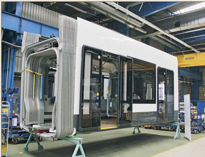
Die erste fertig montierte „Sänfte“ im Werk Wien am 9. Juni 2017, deutlich sind die höheren Dachränder zu sehen
