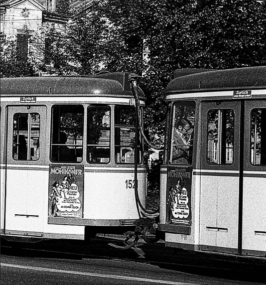
Ein spezielles Starkstromkabel stellte bei Einsatz im Zugverband die Stromversorgung bei Bw 1521 vom Tw her sicher AXEL REUTHER (2)
