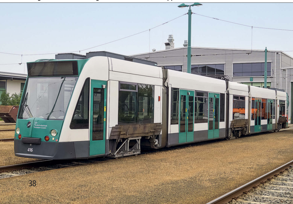
Vor dem Versand zum Umbau erhalten die Wagen in Potsdam eine Hauptuntersuchung, hier Wagen 415. Hinter den geöffneten Fahrwerksklappen befinden sich Hilfsfahrwerke
