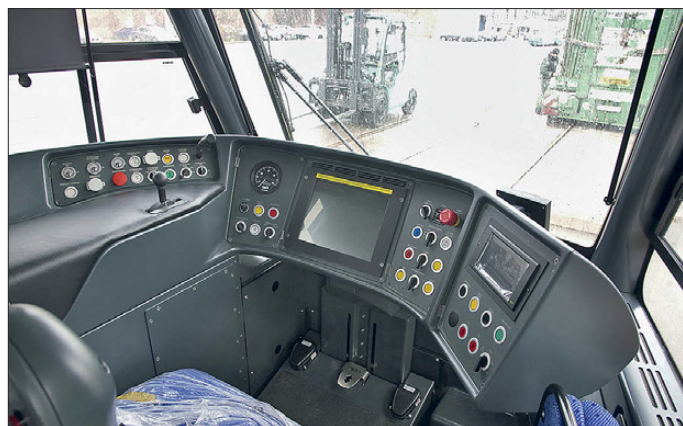
Blick in den Führerstand des Tw 2501. Im Vergleich zur Vorgängerserie wurden nur der Fahrersitz und einzelne Schalter verändert
