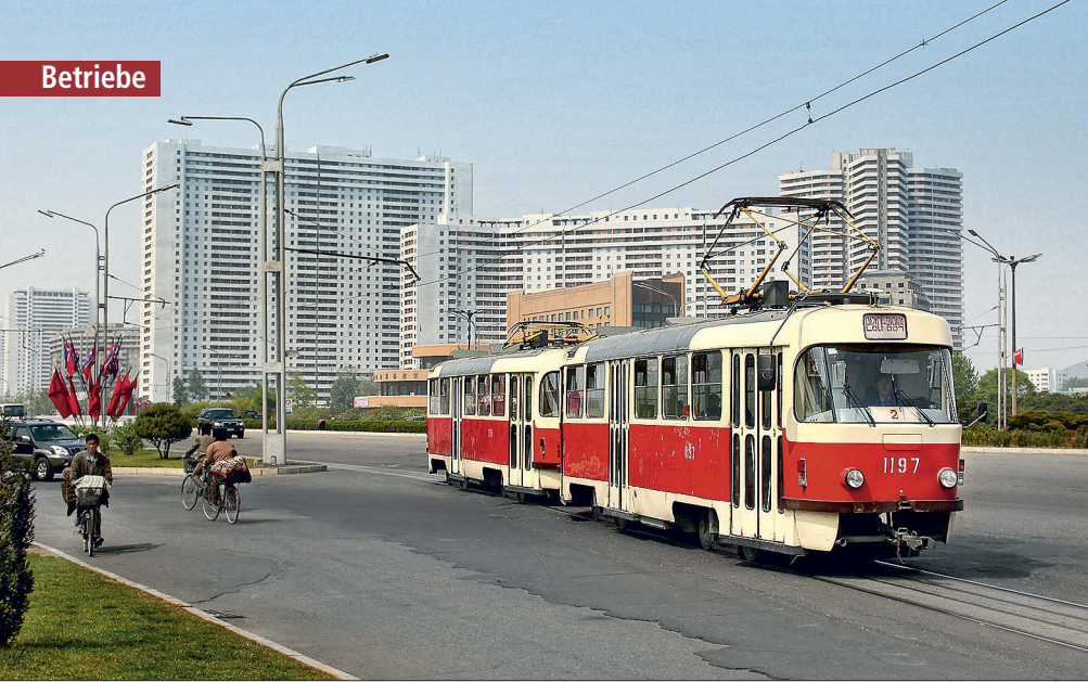
Die westliche Chilgol-Gleisverjüngung ist ähnlich wie die auf der Ostseite aufgebaut – gerade befährt hier diese die T3SUCS-Doppeltraktion 1197+98 anlässlich einer Sonderfahrt. An dieser Stelle werden auch die Stromabnehmer herabgezogen
