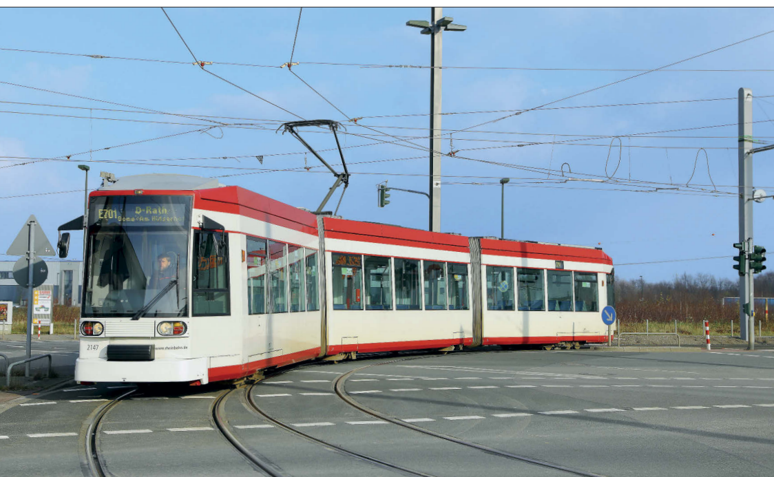
Wagen 2147 auf der Veranstaltungs-Extralinie E701 bei der Einfahrt in die Schleife am Hülserhof. Um Überholungen bei Großveranstaltungen im ISS Dome zu ermöglichen, ist die Endschleife zweigleisig ausgeführt
