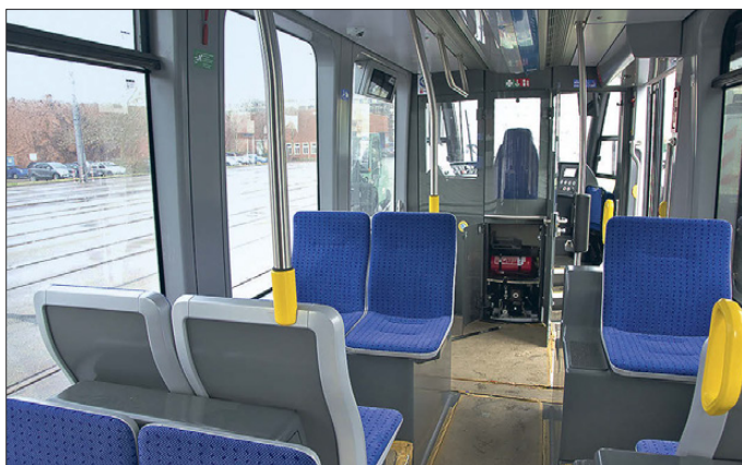
Der enge Durchgang im Drehgestellbereich ist durch einen schmalere Einzelsitz auf der rechten Seite entschärft worden
