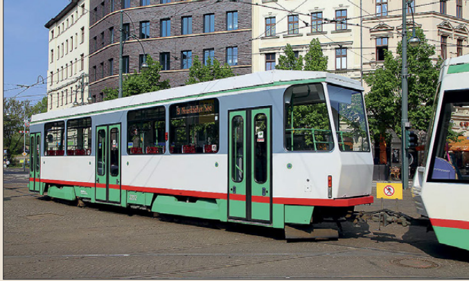
Aus Berlin übernommene und adaptierte B6A2 finden an der Elbe als Beiwagen hinter den Alstom-Niederflurbahnen Verwendung, um die bisherigen Großzüge aus drei Tatravagen zu ersetzen
