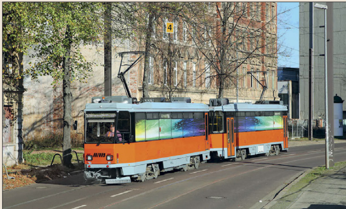
Zweite Karriere: Zum Schienenschleifzug wurden 2017 zwei aus Berlin übernommene modernisierte T6A2 umgebaut. Mit ihrer farbenfrohen Lackierung sind sie auf Magdeburgs Straßen ein echter Hingucker
