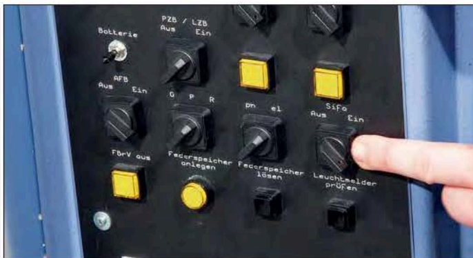
Seitlich unterhalb des Führerstandes befindet sich das zentrale Schaltpanel. Hier befindet sich auch der Hauptschalter der Sifa. Da die Elektronik nicht erkennt, ob sich das gesteuerte Fahrzeug bewegt, muss bei Bahnhofsaufenthalten die Sifa ausgeschaltet werden.
