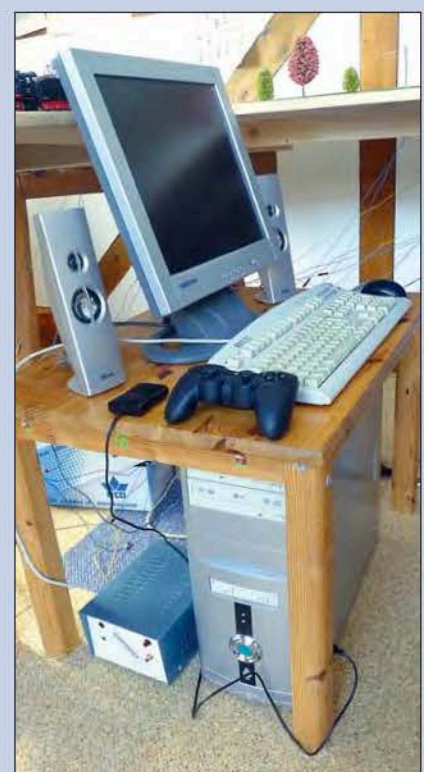
Der kleine graue Kasten neben dem PC ist der selbstgebaute Booster (Bausatz Tams B4 in eigenem Gehäuse). An der Rückseite des Computers befindet sich ein Stecker in der seriellen Schnittstelle, von dem zwei kleine Kabel (gelb und blau) zum Booster führen. Das gelb-braune Doppelkabel, das aus dem Booster herauskommt, geht an die Schienen.
