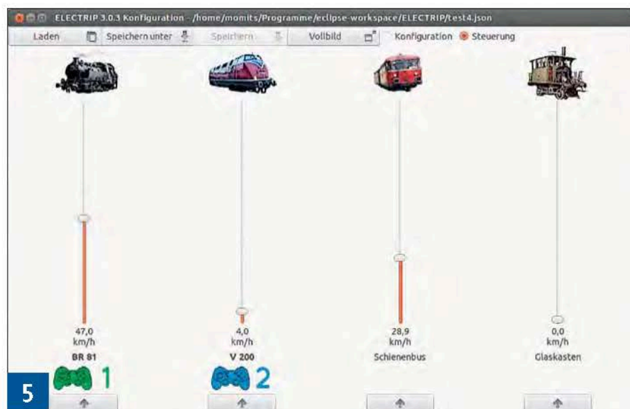
Befindet sich Electríp im Steuerungsmodus, lassen sich den Lokomotiven Gamepads zuweisen. Zudem wird die aktive Sollgeschwindigkeit symbolisiert.
