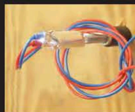
Rechts: Wenn die Lichtabstrahlung der Hülsen im Untergrund stört, lassen sich die Leuchthülsen mittels selbstklebendem Aluband lichtdicht abdecken. Die Lichtausbeute der Lampenköpfe verbessert sich nur unbedeutend.
