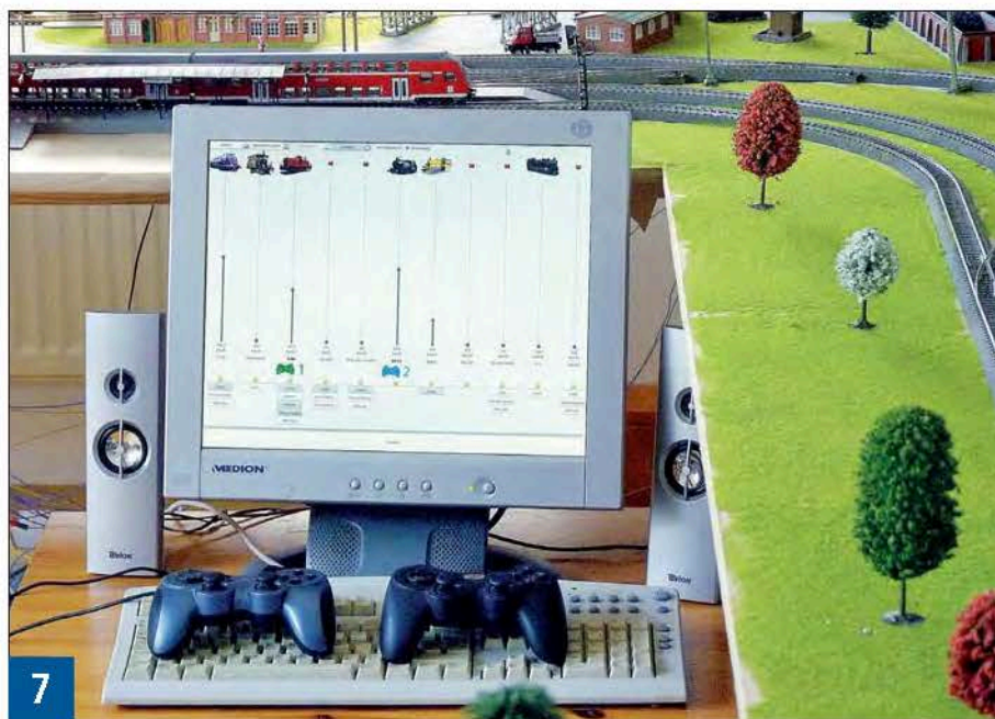
Zwei Gamepads sind an den PC angeschlossen. Hier läuft das Betriebssystem Ubuntu, der SRCP-Server sowie Electrip. Vier Lokomotiven befinden sich aktuell in Bewegung. Die Lautsprecher deuten auf die Weiterentwicklung des Projekts hin: Soundausgabe ohne Decoder.
