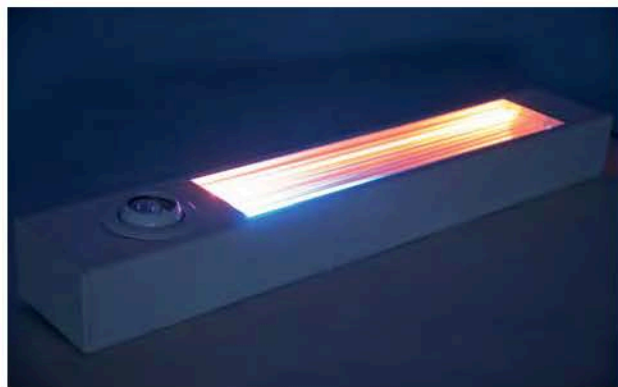
Beim Umschalten zwischen abendlicher und Nachtbeleuchtung „glüht“ die obere rote Röhre nach rechts aus. Die untere blaue beginnt von links ausgehend zu leuchten.
