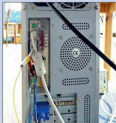
Der kleine graue Kasten neben dem PC ist der selbstgebaute Booster (Bausatz Tams B4 in eigenem Gehäuse). An der Rückseite des Computers befindet sich ein Stecker in der seriellen Schnittstelle, von dem zwei kleine Kabel (gelb und blau) zum Booster führen. Das gelb-braune Doppelkabel, das aus dem Booster herauskommt, geht an die Schienen.
