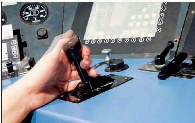
Die Sifa wird wegen ihrer Knopfbedienung umgangssprachlich auch „Totmannknopf“ genannt. Während des Fahrens muss wahlweise der als Druckknopf ausgeführte Knopf des „Gashebels“ oder der Fußschalter niedergehalten und kurzzeitig gelöst werden.
