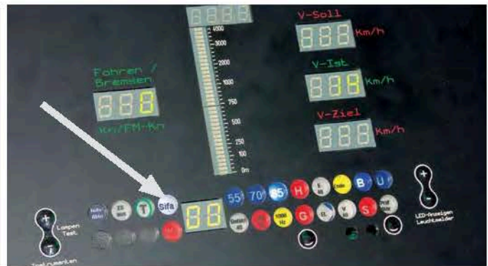
Im „Armaturenbrett“ des Fahrsimulators gibt es neben der Geschwindigkeitsanzeige auch verschiedene Kontrollleuchten. Der Pfeil zeigt auf die Sifa-Leuchte.
