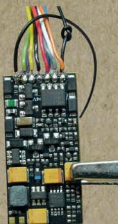
Am von Roco im Taurus verbauten Decoder sind die zusätzlichen Kabel angelötet.
