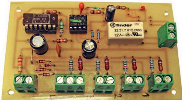
Die Mehrfachüberwachungsversion ist für vier Lichtschranken mit Dauerkontakt ausgeführt.
