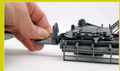
Das Zahnrad greift in den von den Bühnenrandstücken gebildeten Zahnkranz ein.
