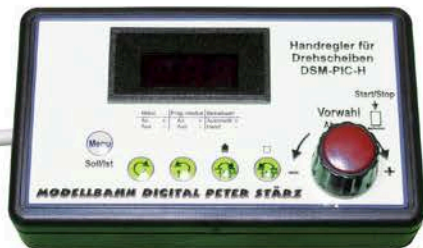
Stärz liefert zu seinem Drehscheibendecoder ein Bedienpult, mit dem man die Scheibe vor Ort in Betrieb nehmen kann.
