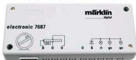
Das Märklin-Zusatzmodul kommt als einfacher grauer Kasten daher. Mit ihm kann man u.a. die Positionen der Gleisanschlüsse erfassen und später gezielt anfahren. Wie die Bühne gerade steht, merkt sich die Elektronik durch Mitzählen.
