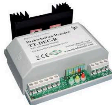
Die Elektronik von Littfinski Datentechnik können über einen Umschalter erweitert werden, sodass die Gleispolung immer richtig ist.
