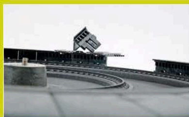
Am einzelnen Bühnenrandstück erkennt man fünf Zähne, der Drehscheibenrand besteht aus 48 Stücken, insgesamt also 240 Zähnen.
