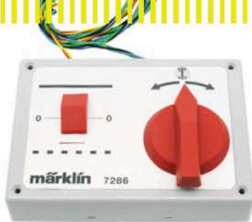
Märklin bietet eine Fahr- oder Einzelschrittvorwahl (links), der Drehrichtungsschalter ist ein Rechts-links-Taster.
