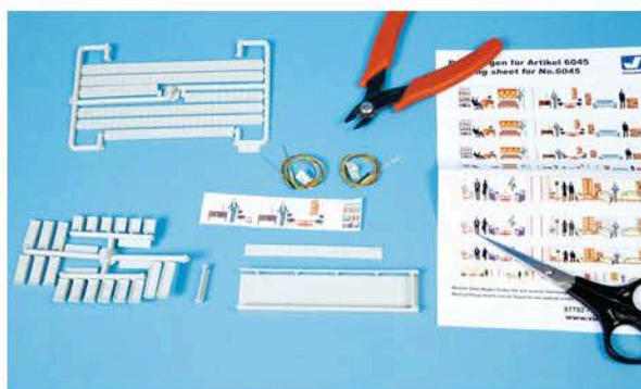
Aus den U-Schienen, Seitenabschlüssen, LEDs und Kopfleisten entstehen die Lichtkästen. Eingeklebte Dekorationen sorgen für das Innenleben.
