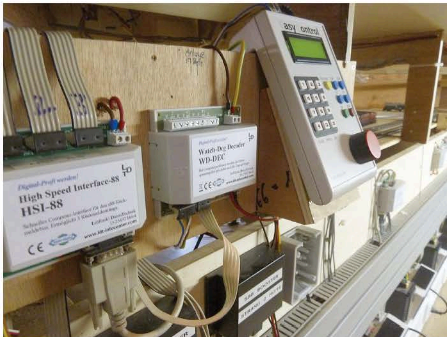
Die Tams EasyControl dient – außer zum Einstellen von Decodern – nur als Gleis-Digital-Signalerzeuger. Nicht mal für die Meldungen von der Anlage ist sie zuständig – die übermittelt ein HSI-88-Baustein von Littfinski Datentechnik.
