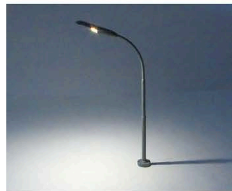
Helligkeitsdemonstration: Die LED wird hier mit einem Strom von nur 3 mA betrieben. Sie ist die einzige Lichtquelle in einem dunklen Raum. Das Bild wurde mit einer Canon PowerShot SX230 HS, Blende 8, Belichtung 1/2 Sek., ISO-1600, ohne Blitz aufgenommen.
