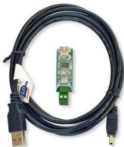
Dies ist der Lieferumfang des S-Nano, dazu kommen noch das Handbuch und die Treiber auf einer Mini-CD. Wie klein der S-Nano ist, wird auf dem Bild deutlich. Bei abgezogenem Stecker hat er eine Grundfläche von gerade einmal 44 x 15 mm. Die Leiterplatte kommt ohne Gehäuse, ist aber ähnlich wie ein Lokdecoder mit Schrumpfschlauch vollständig isoliert. Eine steckbare Klemme (unten) dient zur Abnahme des Gleissignals. Eine Mikro-USB-Buchse stellt die Verbindung zum PC über das mitgelieferte Kabel her.
