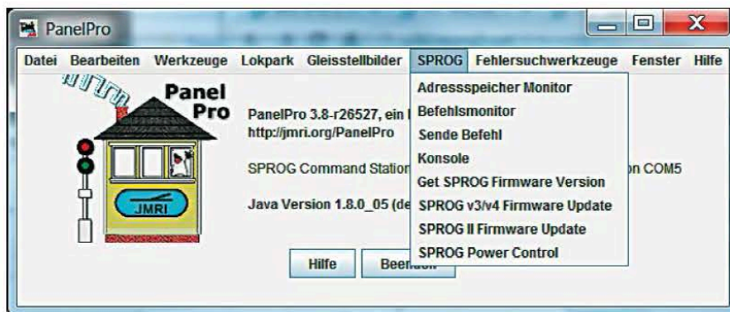
Neben dem Firmware-Update für den SPROG gibt es einige weitere spezielle Funktionen, unter anderem auch eine Konsole (systemnahe Ein- und Ausgabemöglichkeit).
