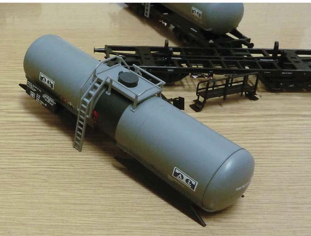
Die Kesselwagen des Ganzzuges werden Stück für Stück zerlegt, um sie zu reinigen und einen geringen Rollwiderstand sicherzustellen.
