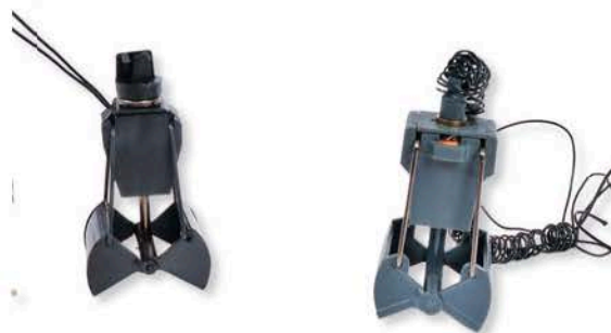
Der Roco- (links) und der Märklin-Greifer sind sehr ähnlich aufgebaut.
