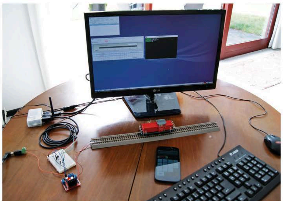
Versuchsaufbau auf dem Wohnzimmertisch: direkte Gleis-Digitalsignalerzeugung per SRCPD/ODROID und Steuerung per Android-Smartphone mit der SRCP-App von Michael Blank – siehe Seite 42 in dieser DiMo.
