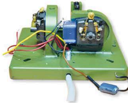
Die Motoren des Krans sind auf Gleichstrom umgebaut und lassen sich so mit normalen Lokdecodern ansteuern.
