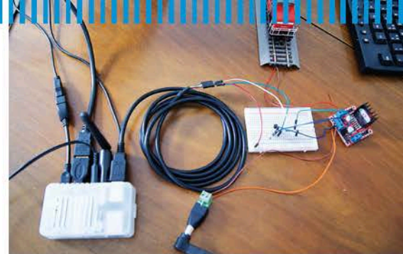
Die Hardware ist komplett: links der ODROID in seinem halbttransparenten Gehäuse, aufgerollt das FTDI-Kabel USB-seriell, daneben das weiße Steckboard mit dem einfachen Inverter, rechts davon der „Booster“: die L298N-Treiberplatine. Unten in der Mitte ist ein Adapter für die Stromversorgung des „Boosters“ zu erkennen.
