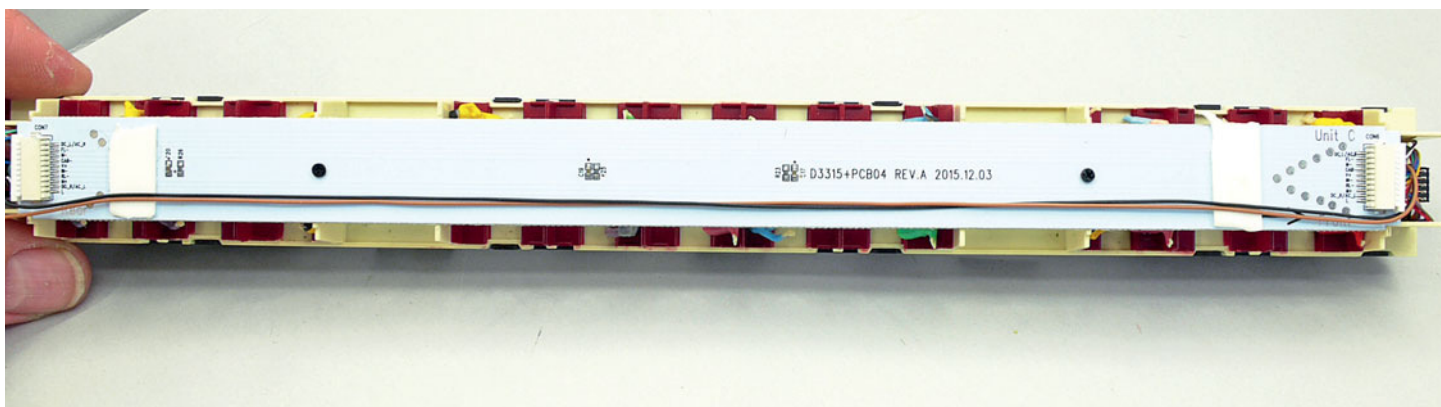
Im antriebslosen Mittelwagen wird die Lautsprecherverbindung nur durchgeschleift.
