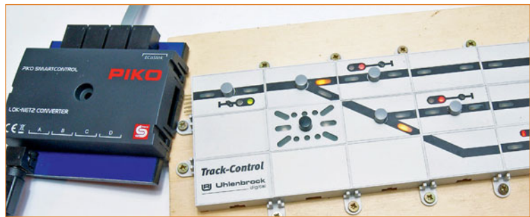
Piko Lok-Netz Converter und Uhlenbrock Track-Control. Zur Inbetriebnahme bei Systemstart muss einmalig die Zubehör-Adresse 2000 auf „grün/gerade“ geschaltet werden.
