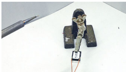
Zum Anlöten der Kabel an die Lautsprecher ist eine „dritte Hand“ sehr nützlich.
