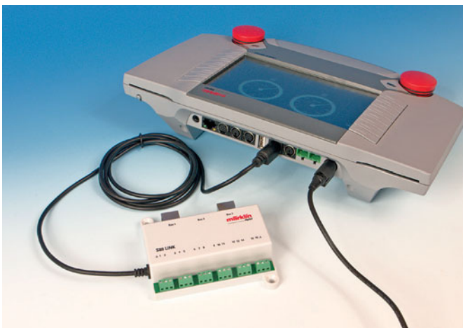
Märklins „versteckter“ CAN-Melder kann für 85,- € UVP 16 Massemelder oder 8 x 8 als Matrix auswertbare Tasten bedienen. Wer Wert darauf legt, kann hier auch alle historischen Varianten von s88 anschließen.
