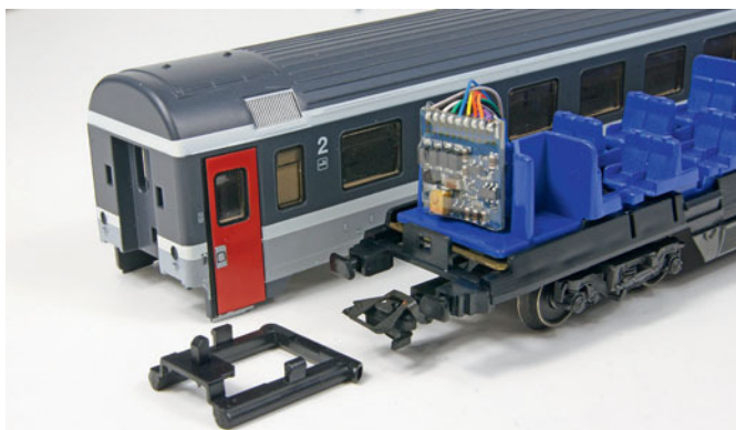
Das Schalten der Innenbeleuchtungen und der Tischlämpchen übernimmt ein Funktionsdecoder von ESU, der LokPilot Fx V4.0 (hier 54620 mit fest angelöteten Leitungen).
