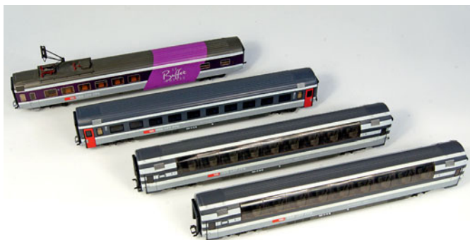
Zwei 1.-Klasse-Panoramawagen, ein Personenwagen für die 2. Klasse und ein Buffet-Wagen mit separatem Pantografen ergänzen die 460er Lokomotive zum (vorerst kleinen) SBB-Zug. Demnächst werden weitere Waggonen und ein Steuerwagen mit Lichtwechsel folgen.
