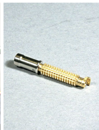
Der Dorn ist ein kompliziertes Stück Feinmechanik. Die „Stachelstruktur“ erlaubt den gleichzeitigen Eingriff von einem waagerechten und einem senkrechten Zahnrad. So kann der Dorn gedreht und gleichzeitig gehoben bzw. gesenkt werden. Beide Zahnräder sind per Rutschkupplung entkoppelt, um ein Blockieren zu verhindern.
