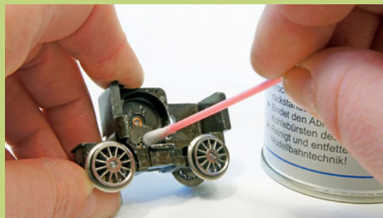
Nach dem Zerlegen des Antriebs werden alle Zahnräder, Radachsen und sonstigen Antriebsteile gut gereinigt. Hier leistet der Viessmann Lokreiniger (6856) gute Dienste.
