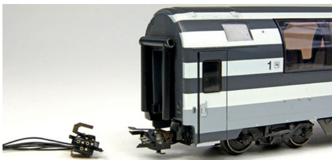
Eine sechspolige Krois-Kupplung verbindet die Waggonen untereinander. Sie passt in den Normschacht und liefert neben der grundsätzlichen Stromversorgung auch die Verbindung der einzelnen Schaltkanäle im weiteren Zugverband.
