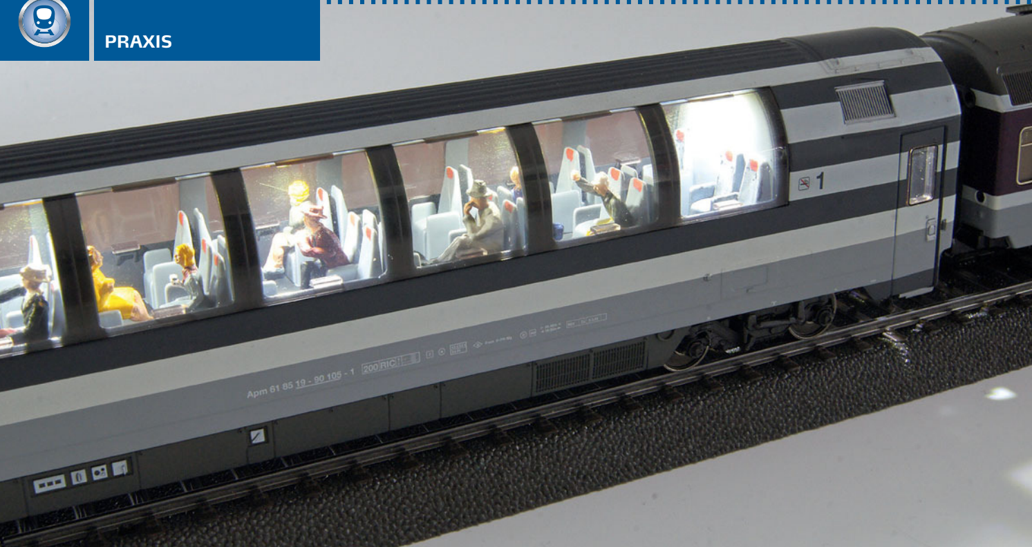
Parallel zum Einbau der LED Innenbeleuchtung (hier Viessmann 5046) wurde die Inneneinrichtung nach Vorbildfotos farblich nachbehandelt. Einige Fahrgäste haben bereits Platz genommen.
