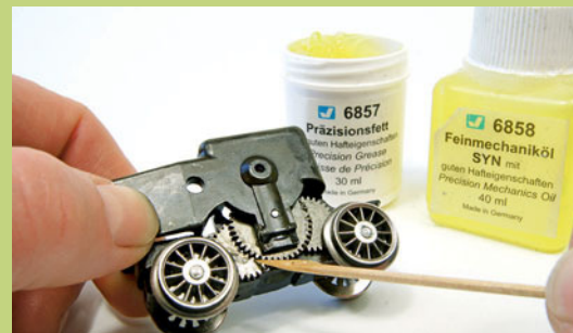
Vor dem Zusammenbau werden alle beweglichen Teile der Lokomotive sparsam geschmiert.
