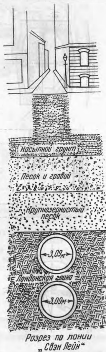
Рис. 6. Двухъярусное расположение лондонских тьюбов при проходке под узкими улицами.
