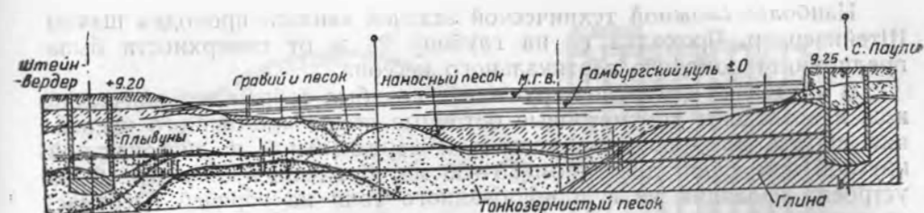
Рис. 432. Геологический продольный профиль по подводному тоннелю Эльбы.
