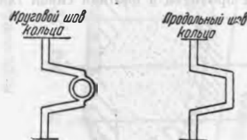
Рис. 363. Туб из железобетонных блоков „Мкалпайн“. По кругу каждого кольца, шириной в 30 см, закладывается круглое железо \varnothing 16 мм
