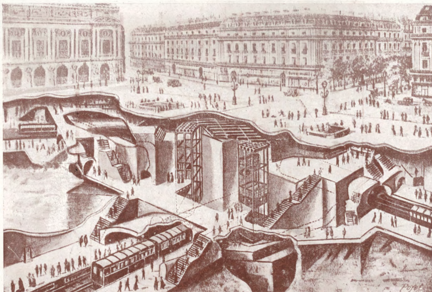
Рис. 102. Условный разрез станции „Опера“ Парижского метрополитена.
