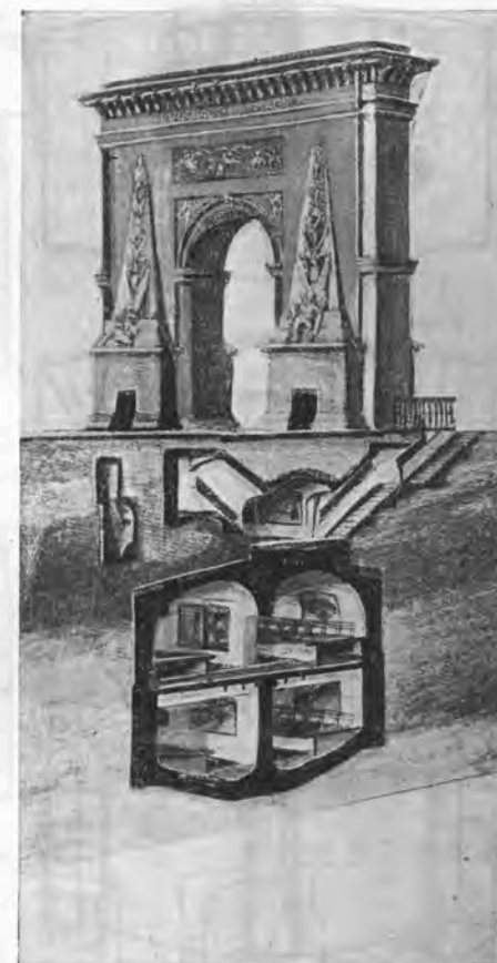
Рис. 168. Схематический разрез станции „Сен-Дени“.
