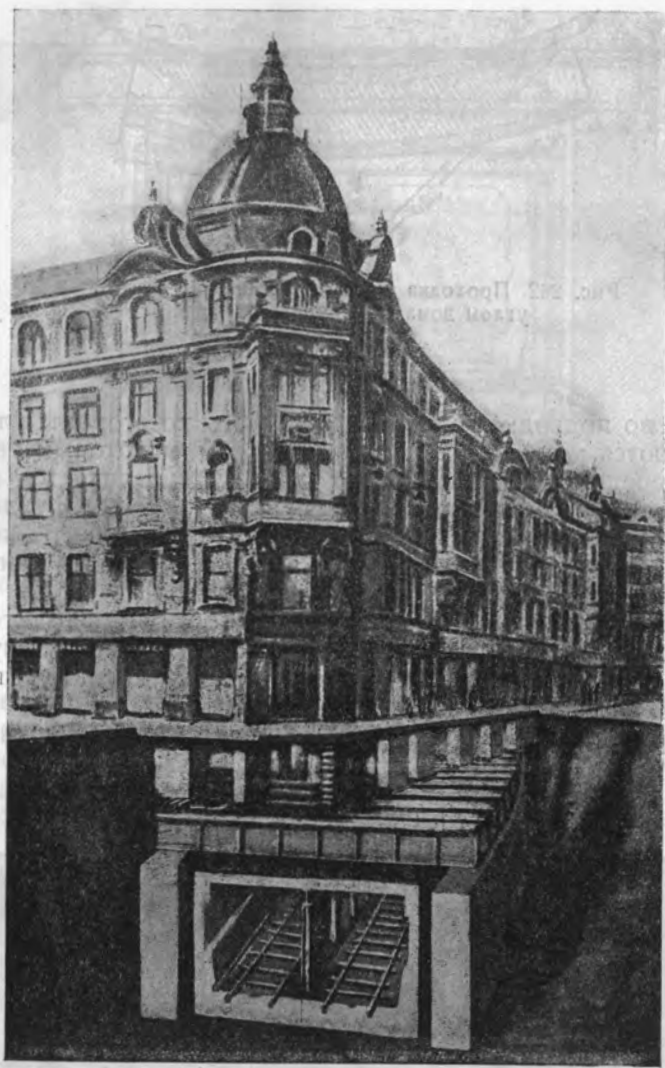
Рис. 264. Схематический вид двухпутного тоннеля метрополитена и обрамляющей его независимой конструкции стен и перекрытия из металлических балок, воспринимающей нагрузку от дома.
