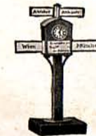
2644 B 3.30 Fahrtrichtungs- anzeiger mit ver- schiebbaren Tafeln, elektrisch beleuch- tet, Birne 20 Volt 0,15 Amp., 1/2 m Kabel mit Metall- steckern. 13 cm hoch
