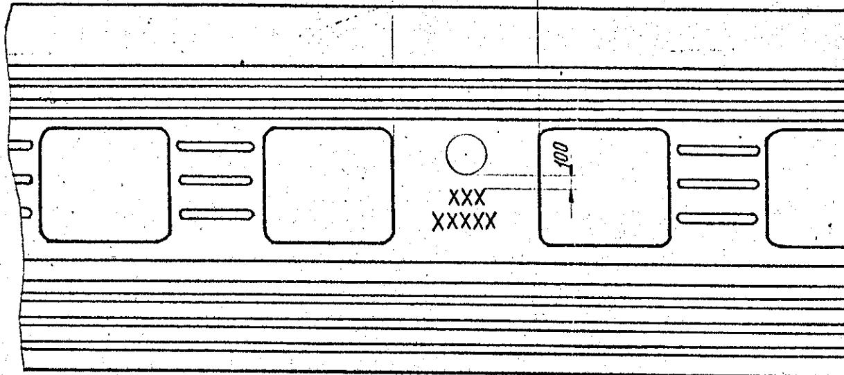
1. Номер вагона располагается на ровной поверхности кузова между 4 и 5 оконными проемами под гербом СССР.
