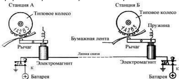
Рисунок 2.18 – Принцип работы буквопечатающего телеграфного аппарата Юза
