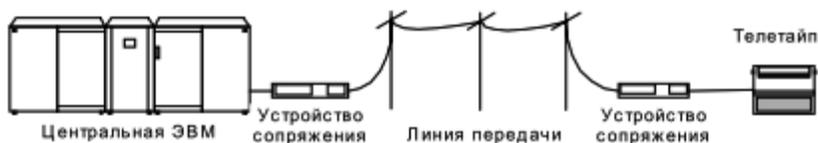
Рисунок 5.3 – Система телеобработки по телеграфному каналу связи
