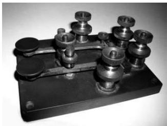
Для передачи сообщений кабельным кодом телеграфные ключи, по сравнению с простейшими телеграфными ключами (см. рисунок 2.11) приобрели другой вид. Они стали по настоящему двухголовыми (рисунок 2.16) [53].
