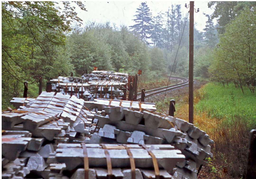
Abb. 31: Aluminium ist relativ leicht, dennoch kommen je nach Packung der Ladung höhere Tonnagen zusammen. Abhängig vom zulässigen Ladegewicht des jeweiligen Wagens wurden die gebündelten Masseln unterschiedlich hoch aufgestapelt. Foto: Peter Schröder
