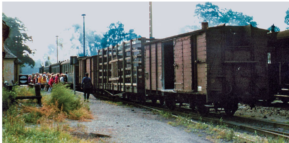
Abb. 26: Ein Personenzug steht abfahrbereit in Gernrode und wird gerade von einer Schulklasse gestürmt. Drei offensichtlich leere Güterwagen sind angehängt, in der Mitte ein SSm-Wagen, der mit einem Gestell aus überlangen Rungen und waagerechten Brettern für den Transport von Fässern hergerichtet ist. So kann man die ultraleichten leeren Fässer ordentlich hoch stapeln. Sein Ziel ist selbstverständlich die Rinkemühle.
