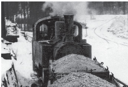
Abb. 36: Und welche Lok ist das? Höchst vermutlich ist es „der andere“ Jung-Vierkupppler, denn die JOHANNE ELISE kann es nicht sein: abgerundete Dachecken, kein Kobel. Es muss die 1922 von Jung gebaute Dn2t mit der Fabriknummer 3193 sein, die normalerweise bei den DBI-Werken in Sontra beheimatet war und nur zeitweise in den 1930er-Jahren in Bad Lauterberg aushalf. Dieser Ausschnitt aus der Abb. 61 wäre zumindest das einzige bekannte Bild dieser Maschine. Slg. Foto Lindenberg, Bad Lauterberg
