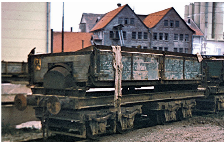
Abb. 41: 54 Exemplare dieser einfachen Zweiseitenkipper besaß die Grubenbahn. Einige wie dieser hier verkehrten nur im Werksgelände mit tropfnasser Schlammladung. Foto: A. Spühr
