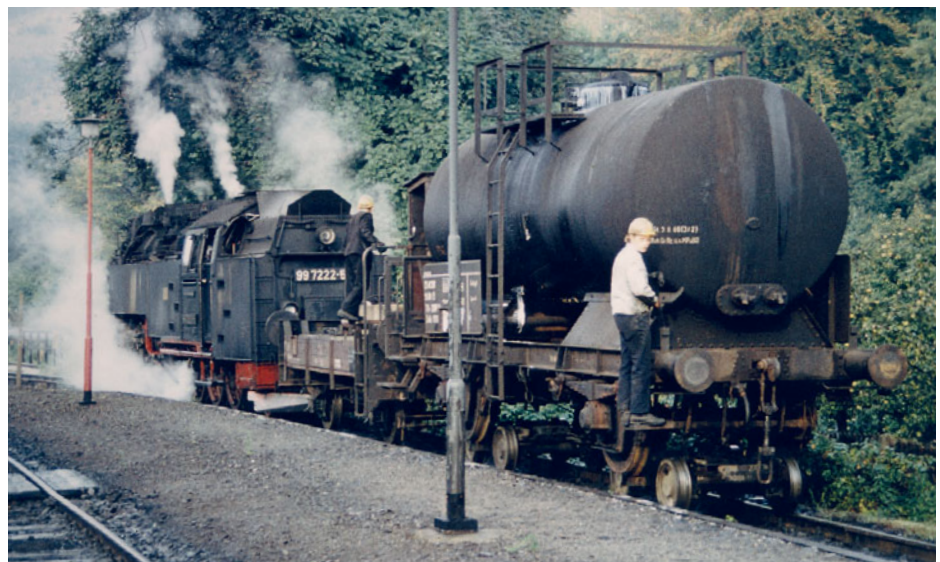
Abb. 21: In dem Kesselwagen, den die 99 7222 in den Argenta-Anschluss schiebt, war Fett oder Dieselöl für das werkseigene Kraftwerk.
