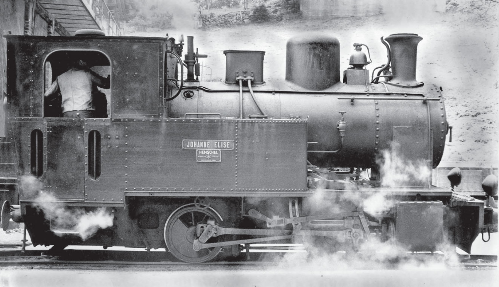
Abb.35: Fast so gut wie eine Typenzeichnung: JOHANNE ELISE II rechtwinklig von der Seite fotografiert. Der wuchtige B-Kuppler, eine Henschel-Baulok vom Typ HELFMANN mit ursprünglich 900 mm Spurweite, war schwerer und stärker als die C-gekuppelte HELENE. Foto: OOK
