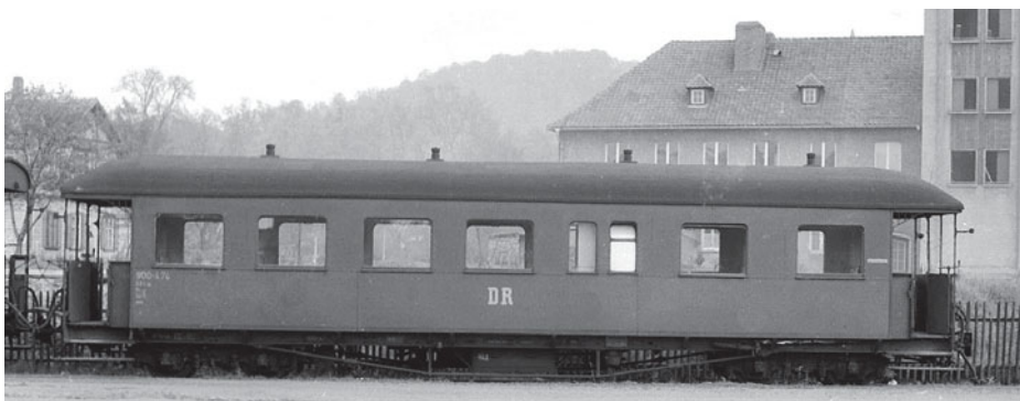
Abb. 8: Die DR baute das Gepäckabteil des 900-474 im November 1954 wieder zurück. Die beiden Flügeltüren wurden verschweißt. Nur die beiden schmalen Fenster zeugen noch von der kurzlebigen Idee. Foto: Kieper (Mai 1967), Slg. Steimecke
