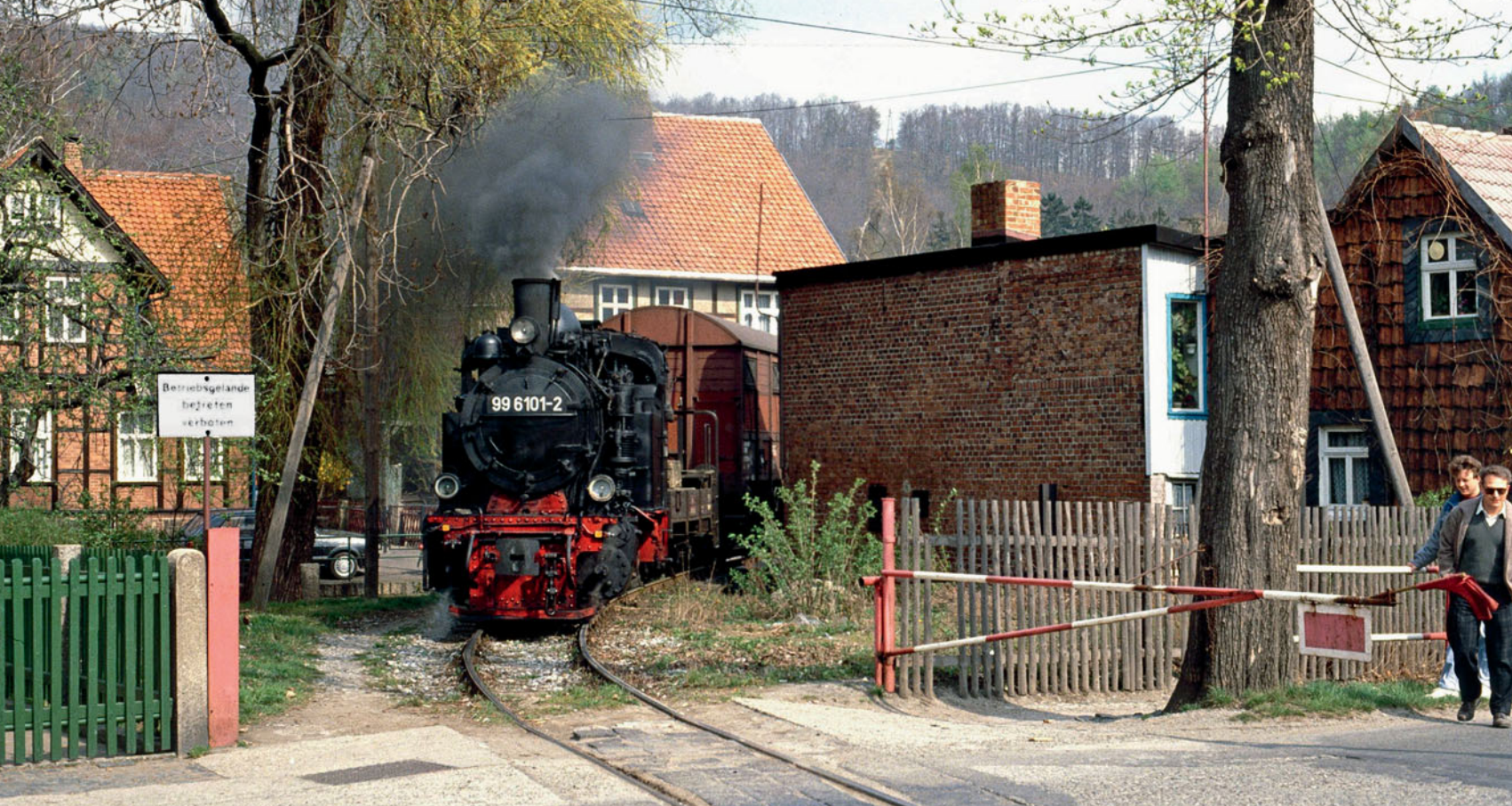
Abb. 9: Eine ganz besondere Schranke sperrte in der einen Stellung den Zugang zum Betriebsgelände, in der anderen den Bürgersteig der Leninstraße (zumindest von der Seite Wernigerode her), wenn Übergabebefahrten diese vielbefahrene Straße kreuzen sollten. Foto: Ralph Steffmann
