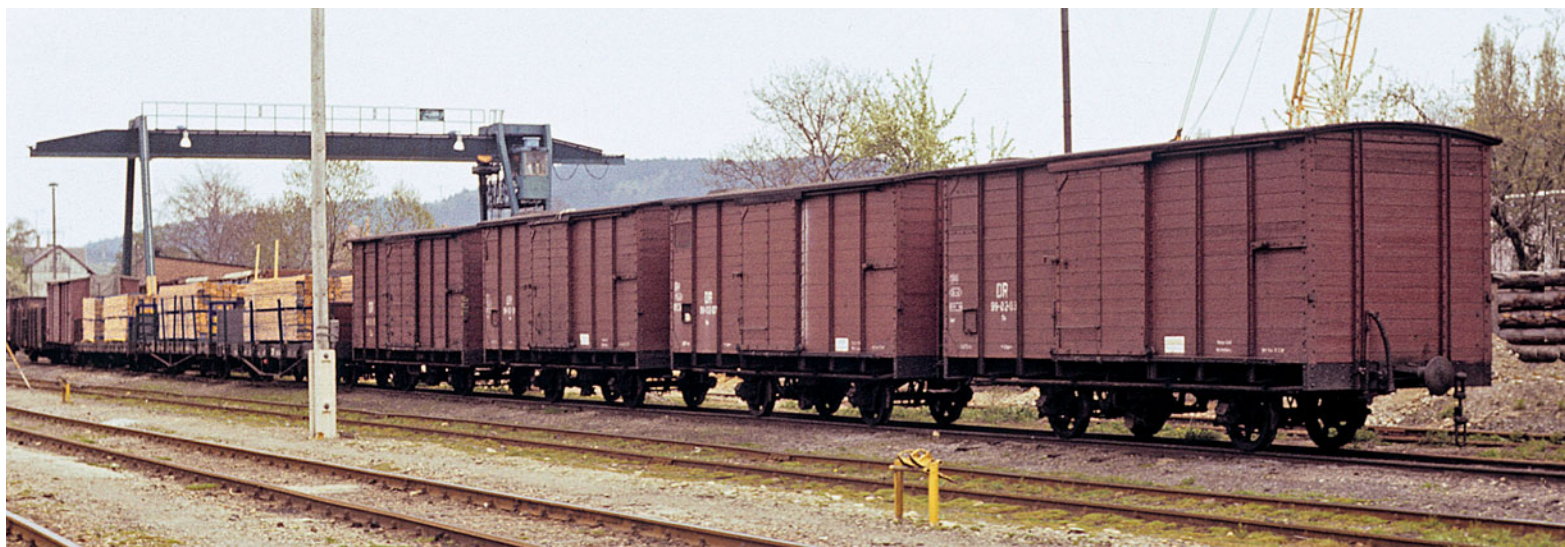
Abb. 27: Zusammengesuchtes Wagenmaterial: ein von der Südharzbahn stammender Blech-Hochbordwagen sowie einer der wenigen original GHE-Bettgestellwagen, die nicht als Reparationsleistung nach Osten abtransportiert worden waren, beide schon abgestellt.
