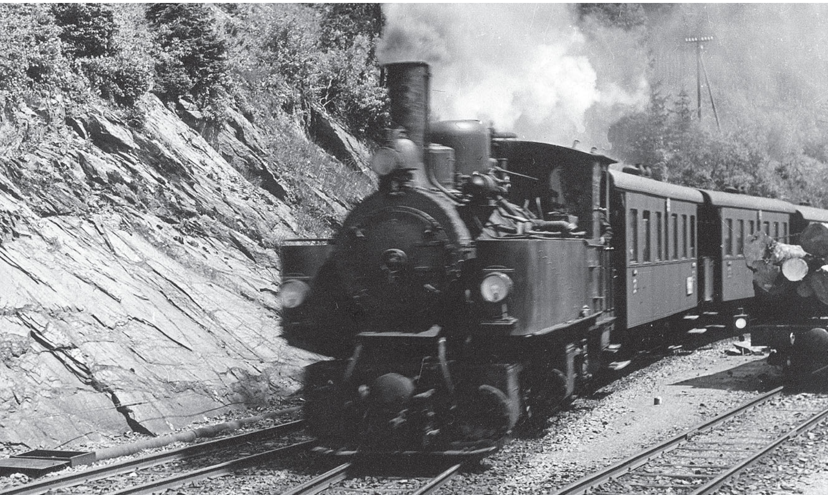
Abb. 28: Der Zug von Nordhausen nach Wernigerode fährt über die Weiche 4 polternd nach Gleis 1 ein, wobei an einem hier mit Stammholz beladenen Güterwagen, der auf seine Abfuhr wartet. Ganz links sichtbar der Drahtzugkanal der Stelleitung zum Einfahrsignal A. Foto: Slg Heinz-Rudolf Ott
