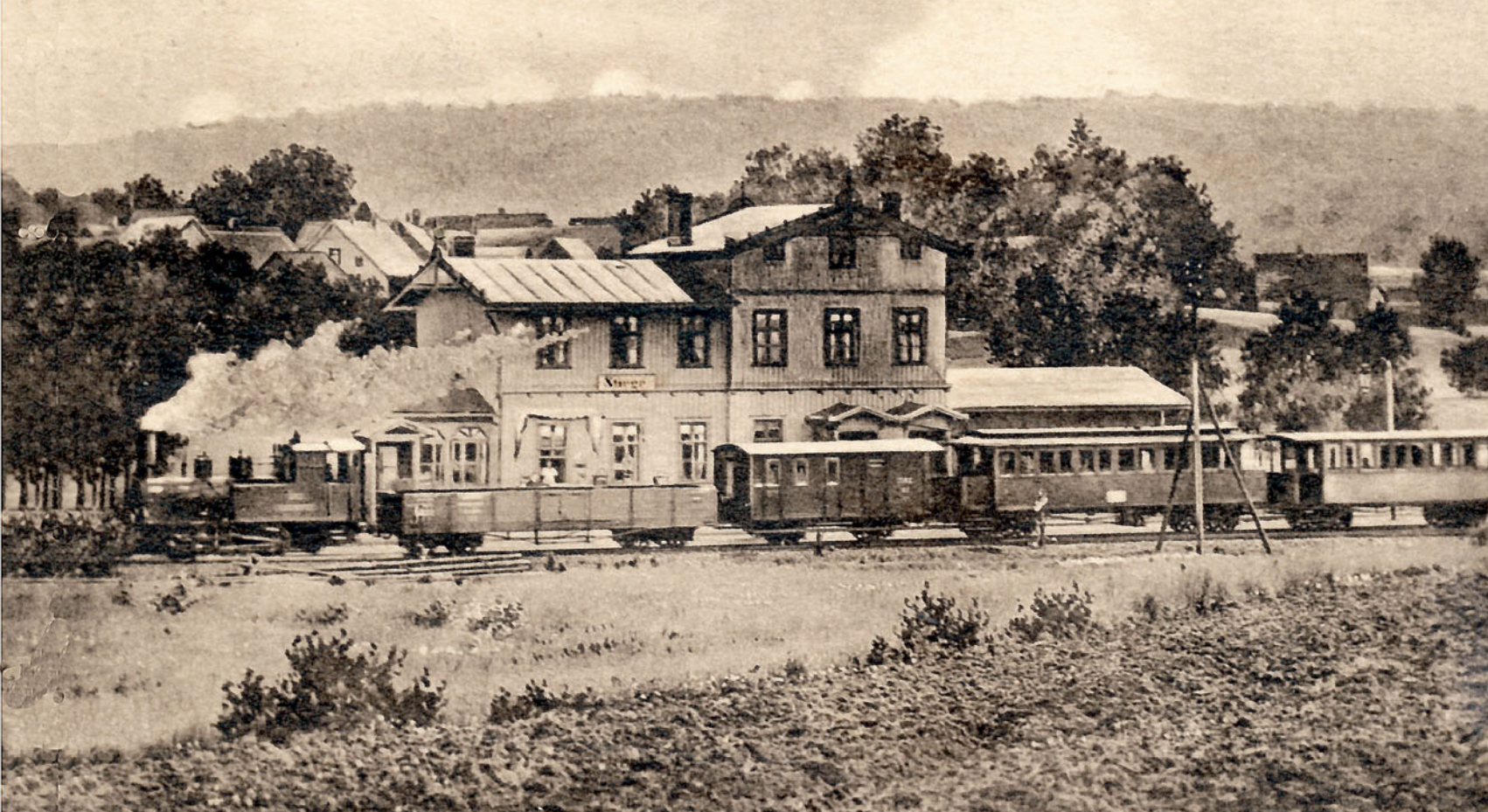
Abb. 2: Die mächtige Abdampfwolke ist hineingemalt, der gemischte Zug, der hier um 1920 in den Bahnhof Stiege der Gernrode-Harzgeroder Eisenbahn einläuft, ist echt: eine Cn2 (vermutlich Lok Güntersberge), OOmI der NWE, PwPost 62 oder 63, BC4 7, 8 oder 9, BC4 22 oder 23. Der Vierachser der Harzquerbahn weist auf Wagenübergang im Wagenladungsverkehr in Eisfelder Talmühle hin. Foto: Slg Zieglgänsberger
