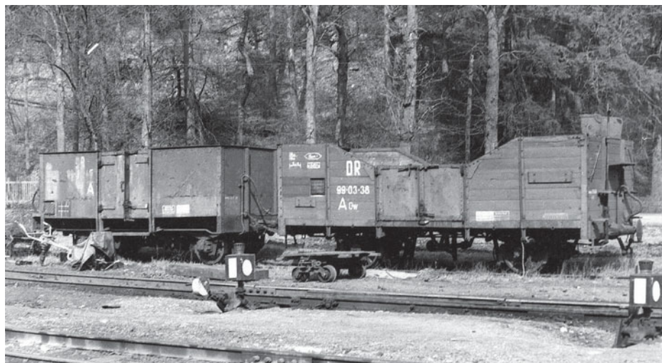
Abb. 27: Zusammengesuchtes Wagenmaterial: ein von der Südharzbahn stammender Blech-Hochbordwagen sowie einer der wenigen original GHE-Bettgestellwagen, die nicht als Reparationsleistung nach Osten abtransportiert worden waren, beide schon abgestellt.
