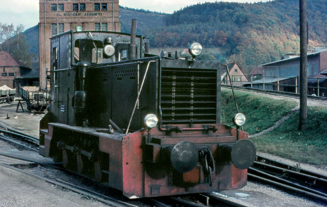
Abb. 40: Eine der beiden HK 130C von Windhoff, die die DBI gebraucht erwerben konnte. Dieser Loktyp entspricht weitgehend den bekannten HF 130C, fällt jedoch durch einen breiteren Rahmen bei gleichbleibend schmalen Aufbauten auf. Foto: Helmut Philipp
