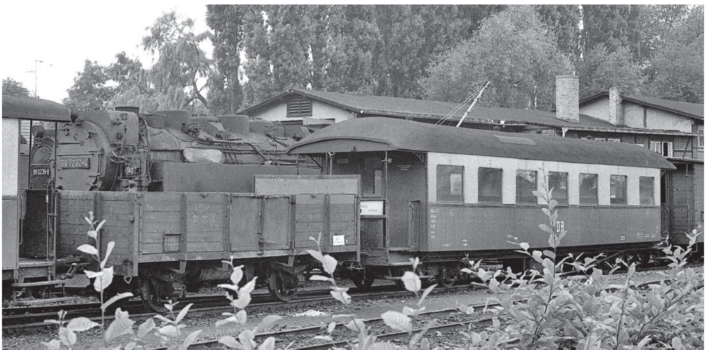
Abb. 8: Die DR baute das Gepäckabteil des 900-474 im November 1954 wieder zurück. Die beiden Flügeltüren wurden verschweißt. Nur die beiden schmalen Fenster zeugen noch von der kurzlebigen Idee. Foto: Kieper (Mai 1967), Slg. Steimecke
