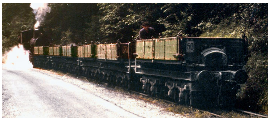
Abb. 42: Ein talfahrender Spatzug auf der oberen Strecke zwischen Wolkenhügel und Hohem Trost, erstaunlicherweise nur mit einem Bremser besetzt, obwohl in diesem Abschnitt das steilste Streckenstück (53‰) liegt. Foto: A. Spühr
