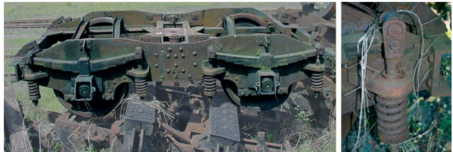
Abb. 4/5: Die Kombination von Blattfedern mit Schraubenfedern sorgte im Zusammenwirken mit der hohen Eigenmasse der Wagen für einen stoßarmen Fahrzeuglauf. Lange Jahre nach dem „Umbau“ der Wagen lagen die Drehgestelle noch in Wernigerode an der Umladung auf dem Schrotthaufen. Fotos: Lammert Boermann (2)
