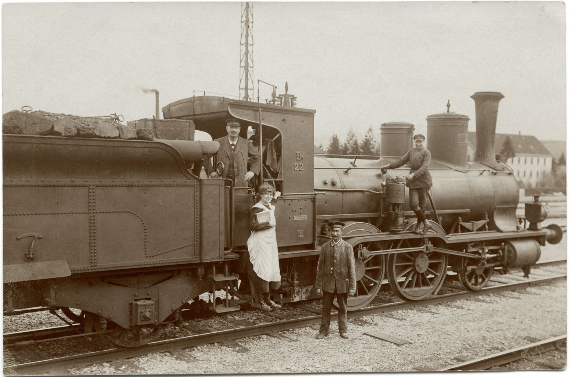
Gruppenbild mit Dame vor der württembergischen B3 Nr. 22 (Esslingen 1848, F.Nr. 181), ehem. Lok „Rechberg“ der Gattung III, ab 1864 Gattung D, umgebaut 1879 zur 1Bn2-Lok. Während Lokführer, Heizer und Rangierer (mit einem „R“ an der Mütze) klar zu identifizieren sind, ist die Dienststellung der Dame nicht bekannt. Ihr Gewand paßt möglicherweise in die Bahnhofsgaststätte. Auch auf dem Umlauf befindet sich eine Dame, die in der rechten Hand Putzwolle hat und offensichtlich mit der Lokpflege betraut ist. An dem über dem Reglerhebel hängenden Tuch, der Kleidung des Meisters und überhaupt am gesamten Zustand der Lokomotive wird recht deutlich, welchen repräsentativen Wert die Sauberkeit seinerzeit hatte. Davon könnte sich heute nahezu jede deutsche Museumsbahn eine kräftige Scheibe abschneiden ...
