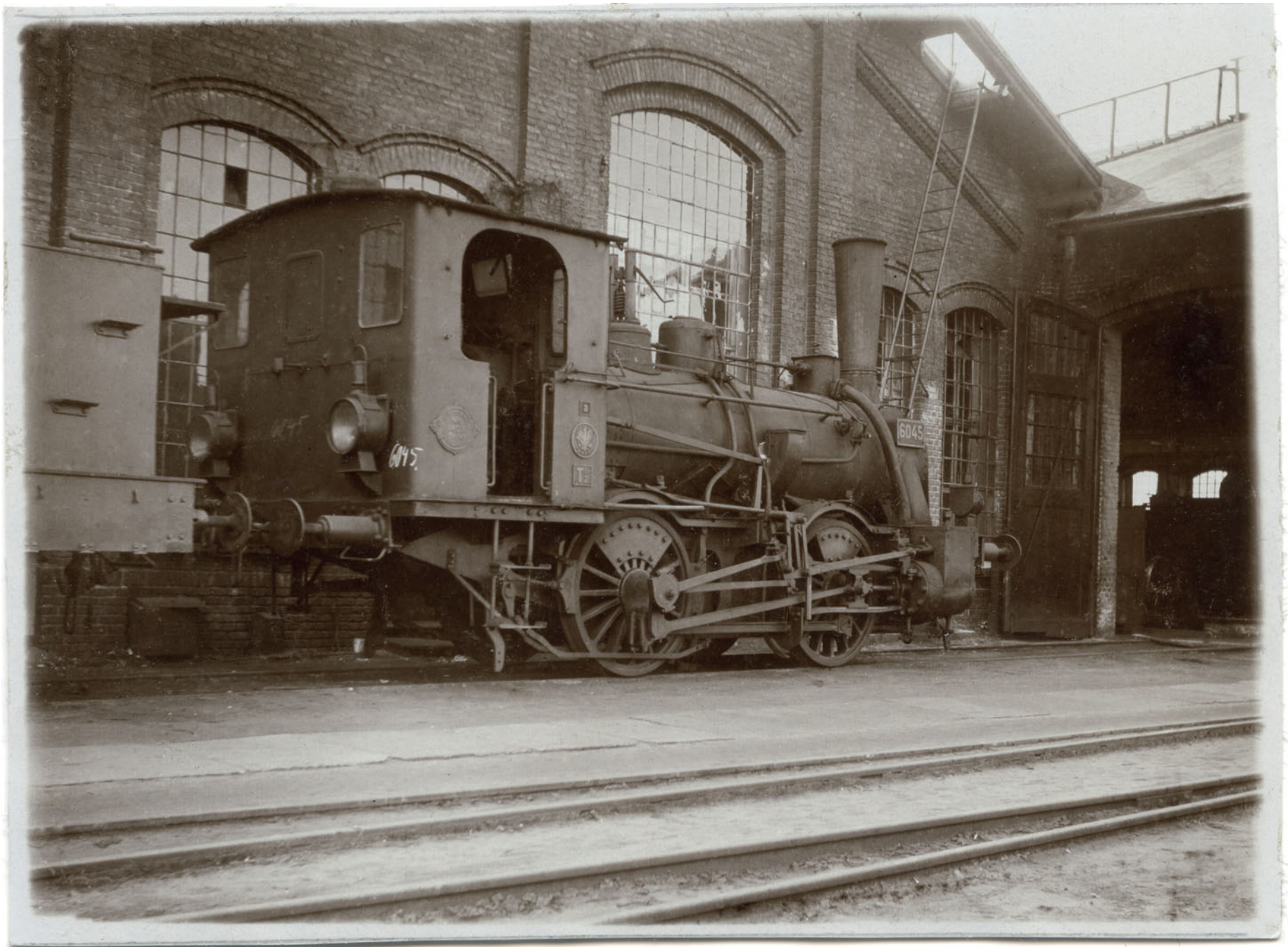
Welche Schätze noch in den Betriebswerkstätten anzutreffen waren, zeigt dieses Photo der preußischen T 2 Berlin 6045 (Hanomag 1878, F.Nr. 1407). Die Führerhausseitenwand bietet kaum Platz für die preußische Beschilderung und das Jugendstil-Fabrikschild der Hanomag. Auffällig sind die noch genieteten Gegengewichte.
