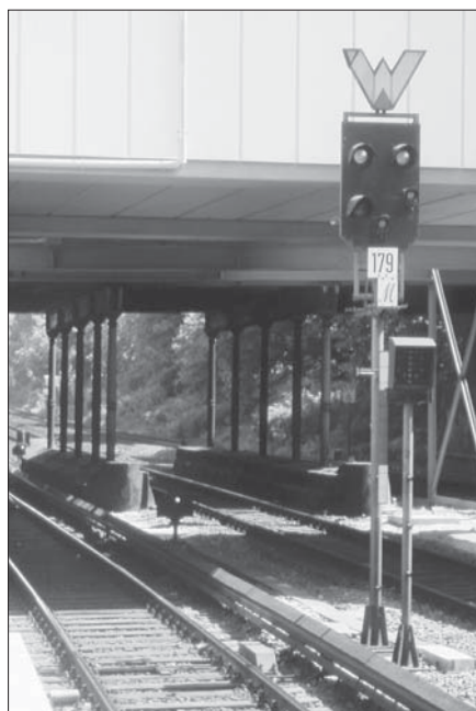
Links: Sv-Signal mit Wartezeichen und Sh 1-Signal vor der Abstellgruppe des Bahnhofs Hasselbrook im Juni 1991. Im Hintergrund sind die Kennlicht zeigenden niedrigen Sperrsignale vor den Weichen zu erkennen.
