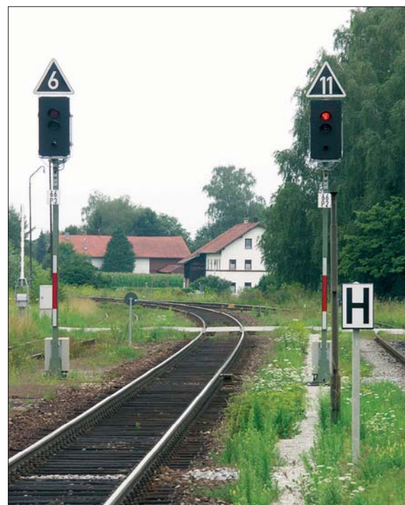
Links: Ausfahrtsignale mit Vorsichtsignalen in einem Kreuzungsbahnhof an der Fernsteuerstrecke Velgast-Stralsund kurz vor Stralsund im September 2005. Das Hauptsignal am Überholungsgleis besitzt einen Geschwindigkeitsanzeiger für 60 km/h.
