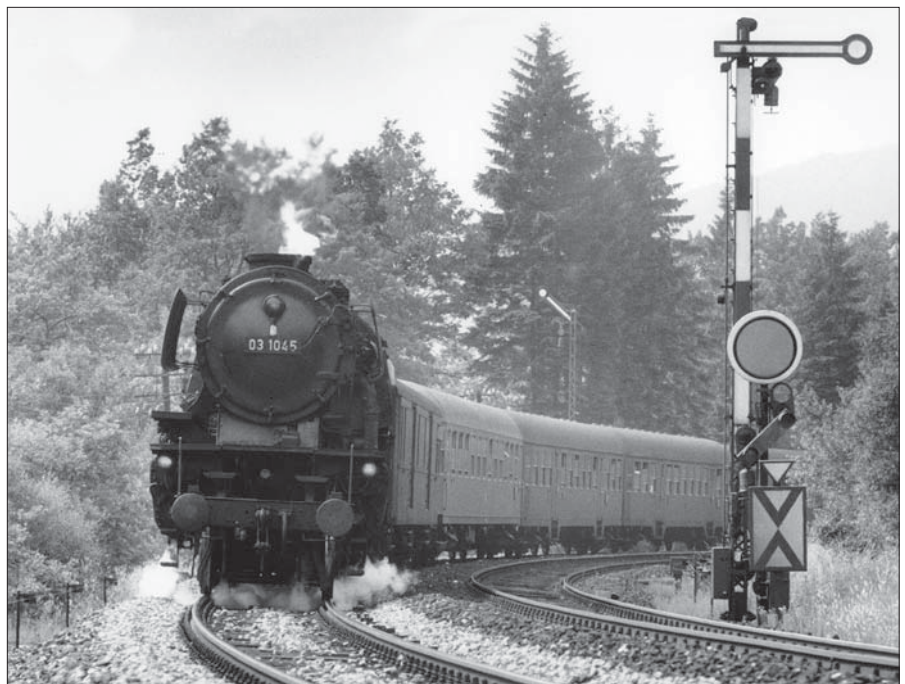
03 1045 mit dem D397 Köln–Kassel auf der Steigung bei Elleringhausen im Juni 1966. Vor dem Blocksignal der Gegenrichtung steht ein Vorsignal mit Lichtlenkkasten. Die Vorsignaltafel besitzt ein Aufsatzdreieck, um anzuzeigen, dass das Vorsignal im verkürzten Bremswegabstand zum nächsten Hauptsignal steht. Foto Ludwig Rotthowe
