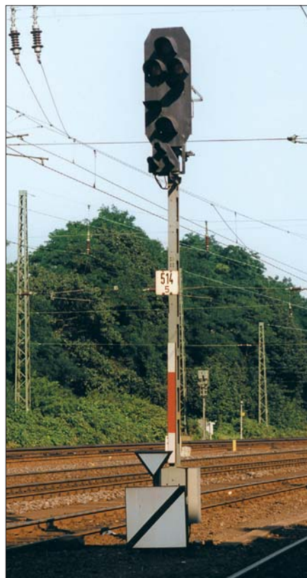
Haupt-/Sperrsignal in Hamburg-Sternschanze im September 1991. Vor dem Signal steht eine Vorsignalbake für das Vorsignal am nächsten Blocksinal.
