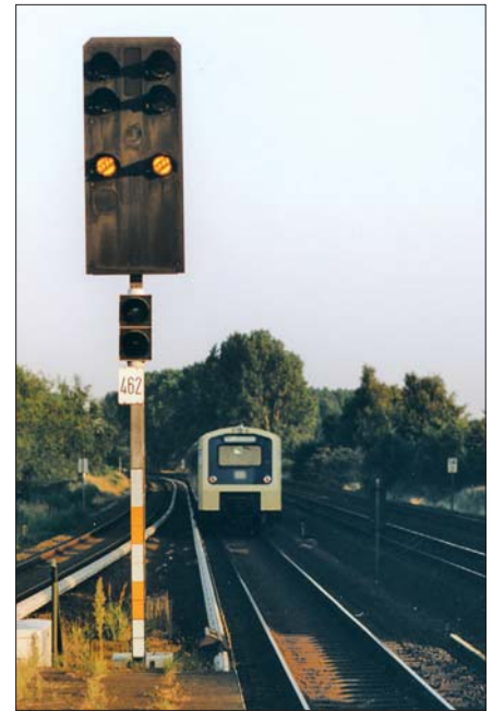
Ausfahrsignal am Hp Thesdorf mit Abfahrtrautragssignal in „Ampelbauweise“ im September 1991. Da das Signal stets als Selbstblocksignal geschaltet ist, ist die Öffnung für die rote Lampe (unten links) verschlossen.
