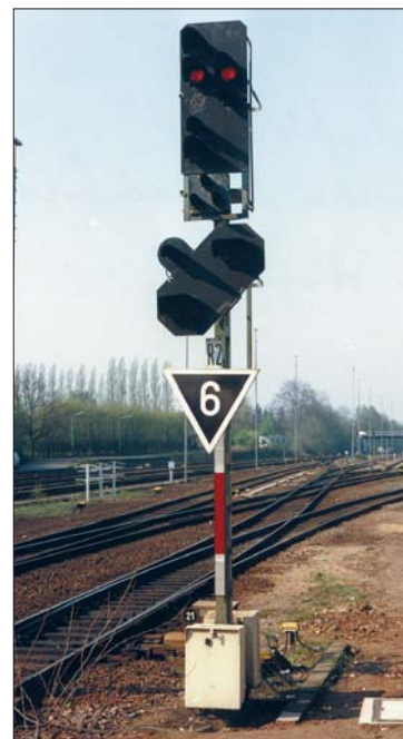
Hinter diesem Zwischensignal bei Ahrensburg führt der Fahrweg über Weichen, die 60 km/h zulassen.
