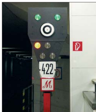
Blendenrelaissignale im Nordsüd-S-Bahn-Tunnel. Links das Blocksignal 112 am Hp Oranienburger Straße im April 2004, rechts das Signal 422 im Bf Potsdamer Platz im Juli 2004. Fotos Alexander Lindner
