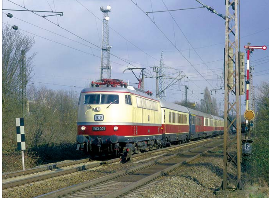
Die DB-Museumslok verlässt mit einem Sonderzug 2003 den Bf Hannover-Ahlem. Vor der Lok das SFB-Einfahrtsignal, dessen Standort mit einer Schachbretttafel gekennzeichnet ist, da das Signal für die Fahrt auf dem falschen Gleis nicht links steht. Foto DB AG, Müller
