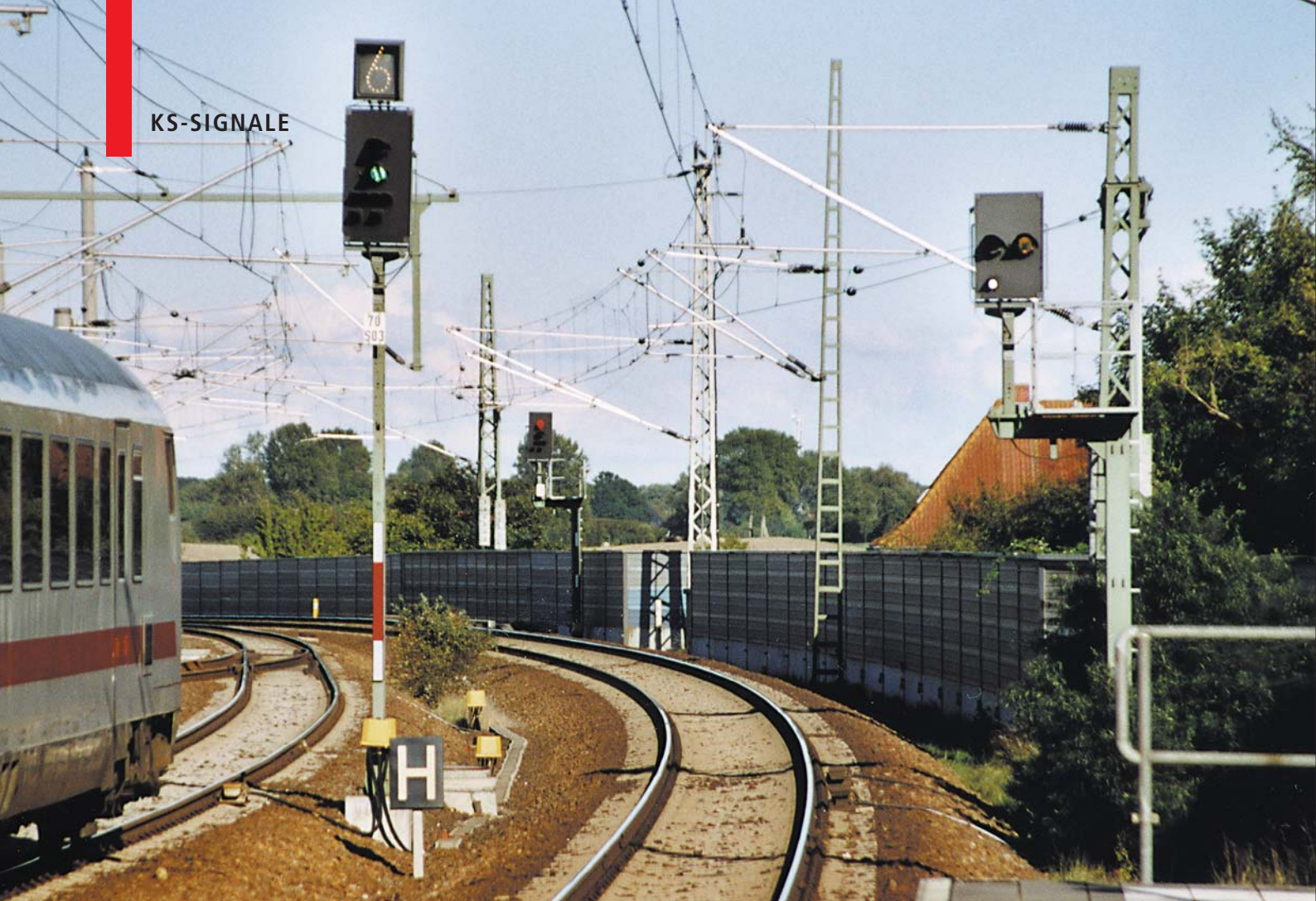
Die drei Signalbilder der Ks-Signale im September 2005 im Bahnhof Velgast. Das Ausfahrtsignal links zeigt Ks 1 in Verbindung mit einem Geschwindigkeitsanzeiger für 60 km/h. Das Hp 0 des Ausfahrtsignals im Hintergrund wird durch den Ks 2 zeigenden Vorsignalwiederholer rechts im Bild angekündigt. Beide haben Signalmaste mit langen Auslegern.
