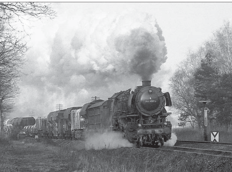
044 456-2 mit dem Dg 6831 Lehrte-Braunschweig am 4. Januar 1974 in der Steigung hinter dem Bf Hämelerwald. Rechts das dreibegriffige Einfahrtsignal der Gegenrichtung. Das Bild verdeutlicht obendrein den Sinn der Vorsignaltafeln. Selbst ein Vorsignal mit Zusatzflügel ist in der Stellung „Fahrt erwarten“ tagsüber nicht sehr auffällig.
