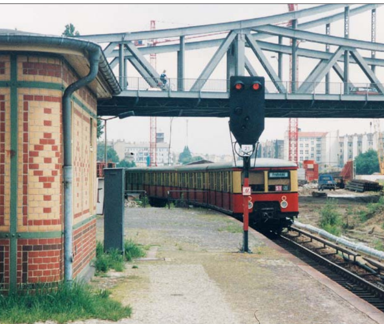
Blendenrelaissignal mit drei großen Laternen und Ra 12-Signal im Bahnhof Gesundbrunnen im August 1996. Foto Alexander Lindner
