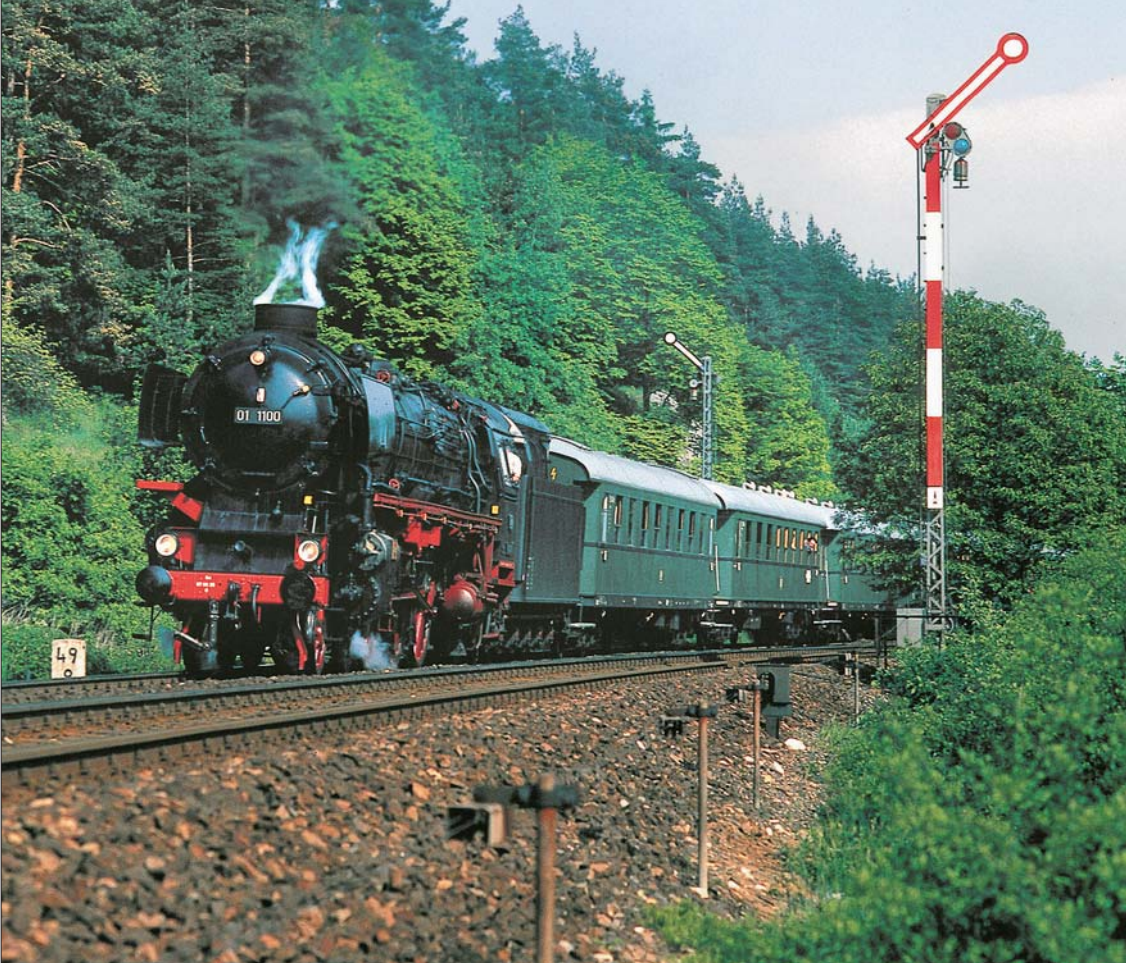
Die DB-Museumslok 01 1100 passiert am 26. Mai 1985 mit dem D 18606 auf der Fahrt von Amberg nach Nürnberg den Block Mainshof. Beide Signale der wegen des geringeren Verkehrsaufkommens an Wochenenden durchgeschalteten, Blockstelle zeigen Hp 1 – „Fahrt“.
