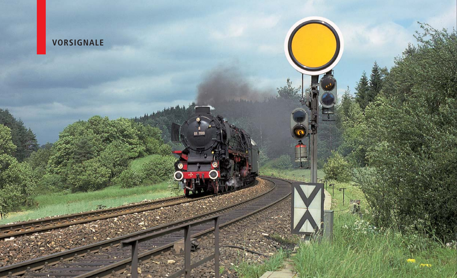
Das in Warnstellung stehende Vorsignal der Blockstelle Etzelwang, ein zweibegriffiges Vorsignal der Einheitsbauform am 13. Juni 1985 fotografiert. Daneben rollt 01 1100 mit dem E 19192 Amberg–Nürnberg talwärts.
