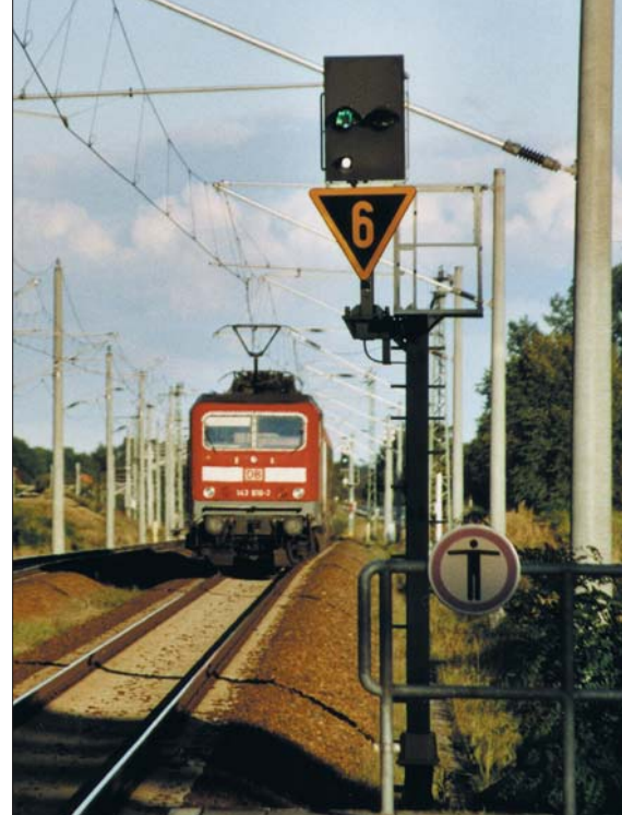
Ausfahrsvorsignalwiederholer im Bahnhof Martensdorf mit einem von 143 818-3 geschobenen Regionalbahnzug nach Stralsund am 17. September 2005. Da das Signal mit einem Geschwindigkeitsvoranzeiger verbunden ist, blinkt das grüne Licht des Ks 1.
