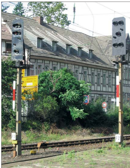
HI-Signale der Bauform 1962 mit Doppellaternen (links) und der Einheitsbauform mit Einzellaternen (rechts) im direkten Vergleich im Bahnhof Rübeland im August 2004. Foto Niels Kunick
