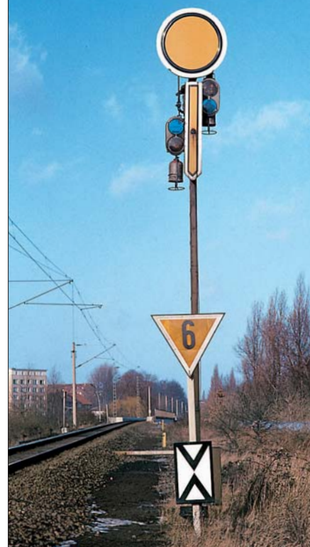
Das Einfahrersignal des Bahnhofs Hamburg-Horn aus Richtung Rothenburgsort im Dezember 1985. Damit es schon von weitem erkennbar ist, besitzt es einen hohen Signalmast.
