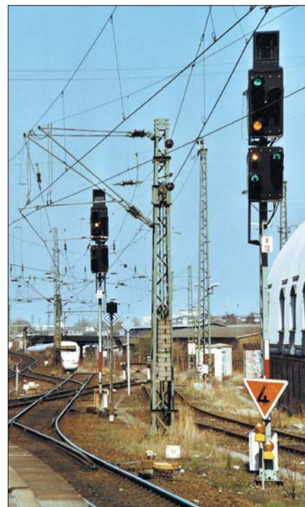
Rechts: Hp 2 und Vr 1 im Bf Hamburg-Altona für eine Ausfahrt in Richtung Hamburg Hbf im April 2004. Das hintere Signal ist hierbei betrieblich ausgeschaltet und zeigt Kennlicht.
