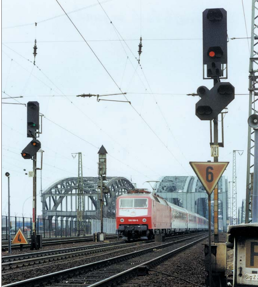
120 156-5 verlässt mit einem IC 1990 die Norderelbbrücke. Vorn rechts ein Selbstblocksignal an den zum Hamburger Hbf führenden Pz-Gleisen, links am Gz-Gleis das Einfahrtsignal des Bahnhofs Hamburg Hgbf. Wegen der anschließenden engen Gleisbögen stehen vor beiden Lichtsignalen Geschwindigkeits-Ankündesignale. Fotos auf dieser Seite Benno Wiesmüller
