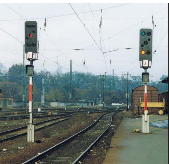
Magdeburg Hbf im November 1991. Die Signale im Nordkopf haben Schirme der Einheitsbauform. Das linke zeigt HI 100, das rechte HI 102.
