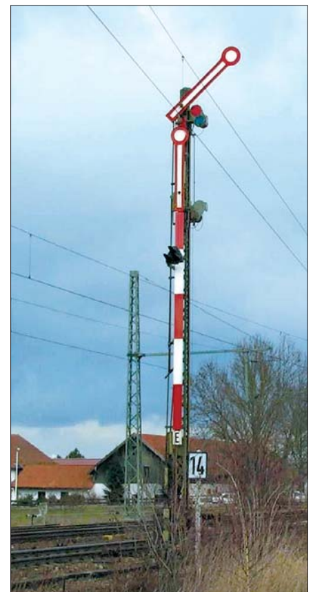
Rechts: Zweiflügeliges Ausfahrtsignal des Bahnhofs Langenbach im Dezember 2003 in der Stellung Hp 1 fotografiert. Neben dem Hauptsignal ein Geschwindigkeitssignal für 140 km/h. Foto Alexander Lindner
