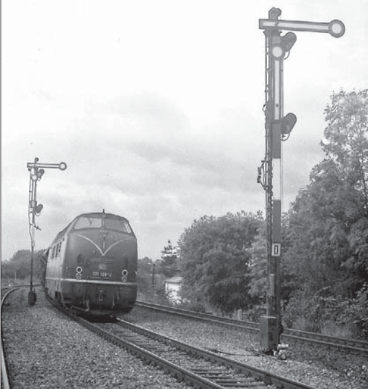
Ausfahrtsignale des Bahnhofs Reinfeld im Sommer 1983. Neben 221 128-2 ein Schmalmast-Signal, rechts ein Gittermastsignal.
