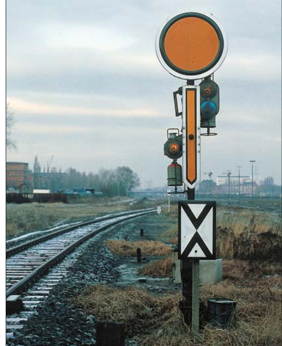
Links: Das Einfahrvorsignal des Bf Blankenese mit einer nach Poppenbüttel fahrenden S-Bahn im Mai 1985. Da Blankenese Kopfbahnhof ist, kann das Signal nur „Halt erwarten“ und „Langsamfahrt erwarten“ anzeigen.
