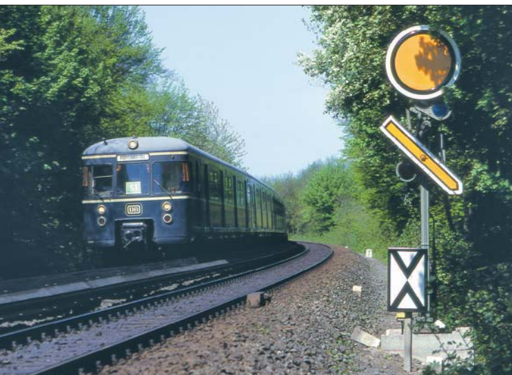
Links: Das Einfahrvorsignal des Bf Blankenese mit einer nach Poppenbüttel fahrenden S-Bahn im Mai 1985. Da Blankenese Kopfbahnhof ist, kann das Signal nur „Halt erwarten“ und „Langsamfahrt erwarten“ anzeigen.
