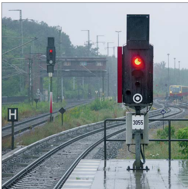
Ks-Signale im Bf Berlin-Wannsee im Juli 2005. Das niedrige Signal auf dem Bahnsteig im Vordergrund besitzt ein Mastschild, das bei Störung die Vorbeifahrt und permissives Fahren erlaubt, das Signal links im Hintergrund hat ein Hauptsignalmastschild der Ursprungsausführung. Rechts: Vorsignalwiederholer mit einem weißen Ring im Bahnhof Griebnitzsee im Dezember 2005. Fotos Alexander Lindner
