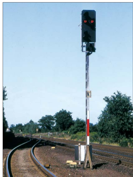
Haupt-/Sperrsignal ohne Zusatzanzeiger als Ausfahrtsignal an einem Überholungsgleis des Bahnhofs Wrist im August 1991
