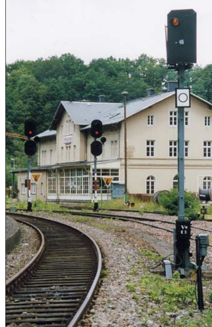
Links: Hp 0 – ehemals HI 13 – „Halt“ an den Ausfahrtsignalen des Bahnhof Waren im Juli 2004
