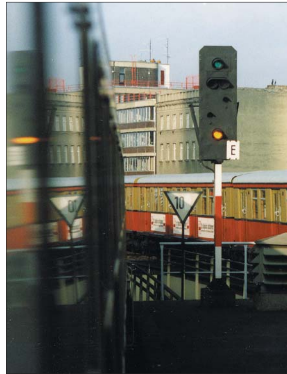
Das am 16. November 1991 für einen IC nach Hannover HI 3a zeigende Ausfahrtsignal des Bahnhofs Berlin-Friedrichstraße entspricht der Bauform 1962 (mit einer einfachen Laterne oben).
