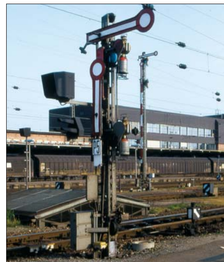
Niedriges Ausfahrtsignal mit Ersatzsignal und Abfahrtrafagsignal sowie 12 m hohes Signal im Hintergrund im Juli 1982 im Bahnhof Offenburg. Foto Günter Berg
