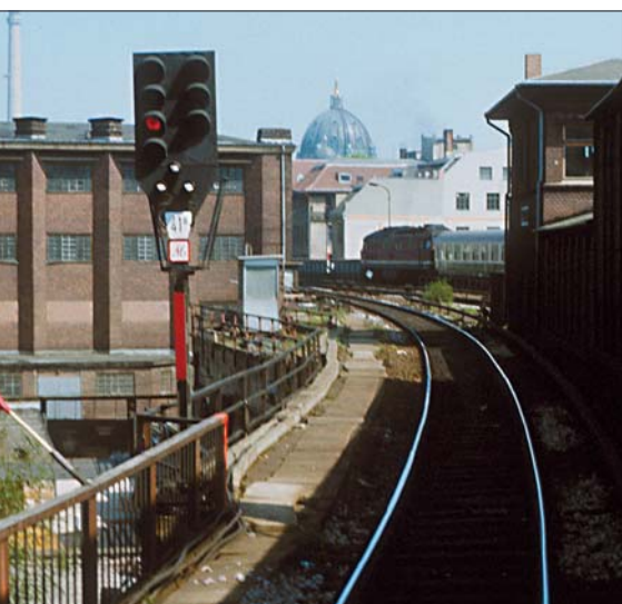
Ausfahrtsignal des Bf Friedrichstraße mit sieben Signallampen und einem Mastschild, das bei Störungen nach der Vorbeifahrt auf Ersatzsignal, wie auf dem Foto, permissives Fahren gebietet. Foto Sigrid Mörschel
