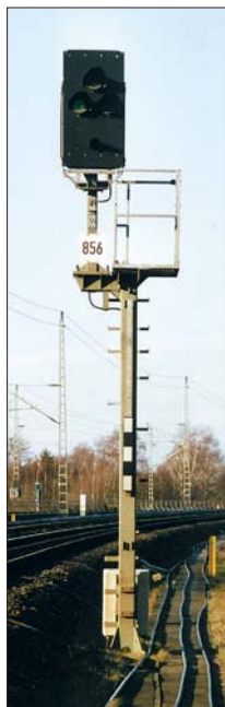
Ganz links: Sv-Signal der Hamburger Gleichstrom-S-Bahn (GSB) mit weiß/gelb/weiß/gelb/weißem Mastschild im Juni 2004 in Hamburg-Altona.
