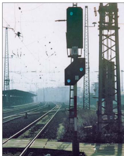
Im Südkopf des Magdeburger Hbf standen zu dem Zeitpunkt z. T. noch die Lichtsignale der ursprünglichen Bauart, die auf diesem Foto HI 101 und VI 101 zeigen.
