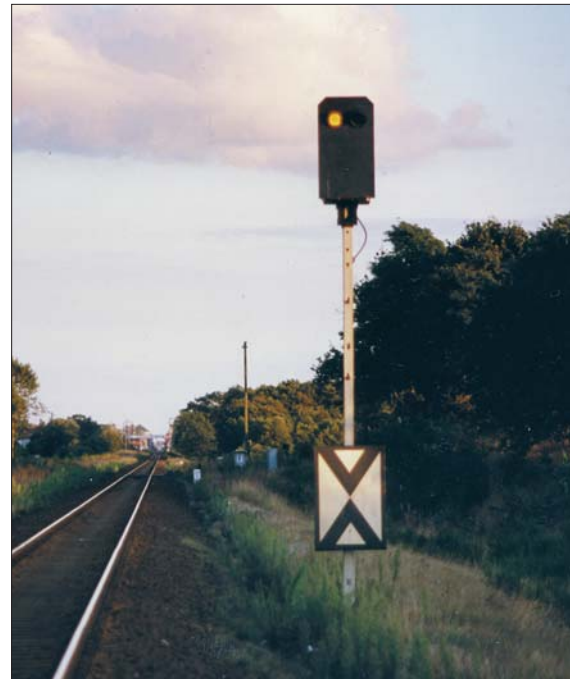
Die häufigsten Belegungen des niedrigen Signalschirms: das Einfahrtvorsignal des Bahnhofs Schwanheide im September 1991
