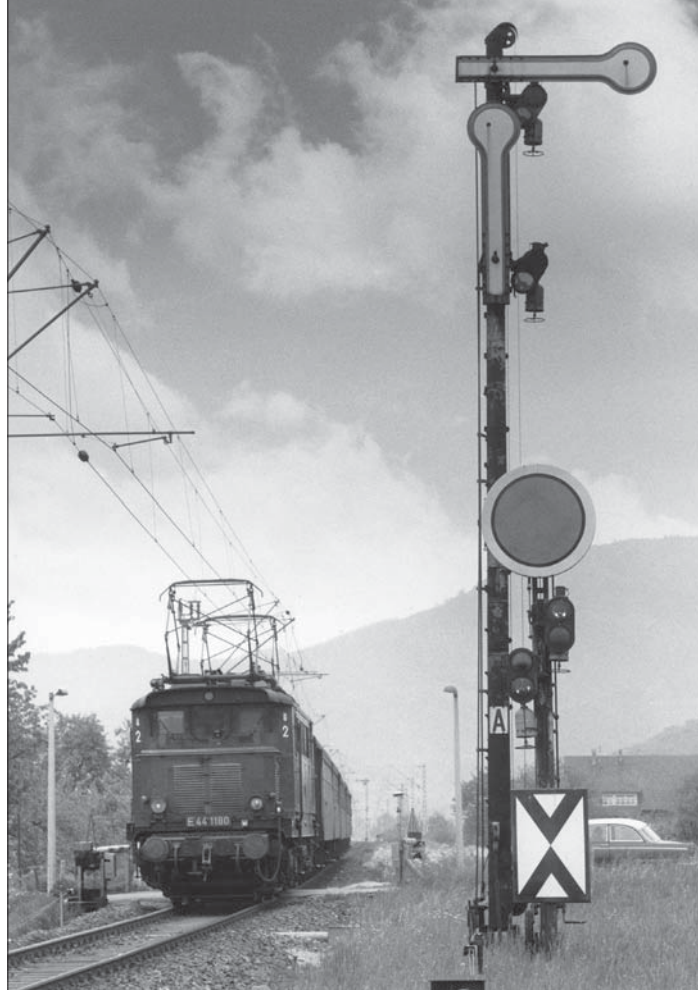
E 44 1180 verlässt im Mai 1967 mit einem Personenzug nach Basel den Bahnhof Fahrenau. Das Einfahr- und Ausfahrsvorsignal für die Gegenrichtung sind ebenfalls beide badischen Ursprungs. Fotos Ludwig Rotthowe
