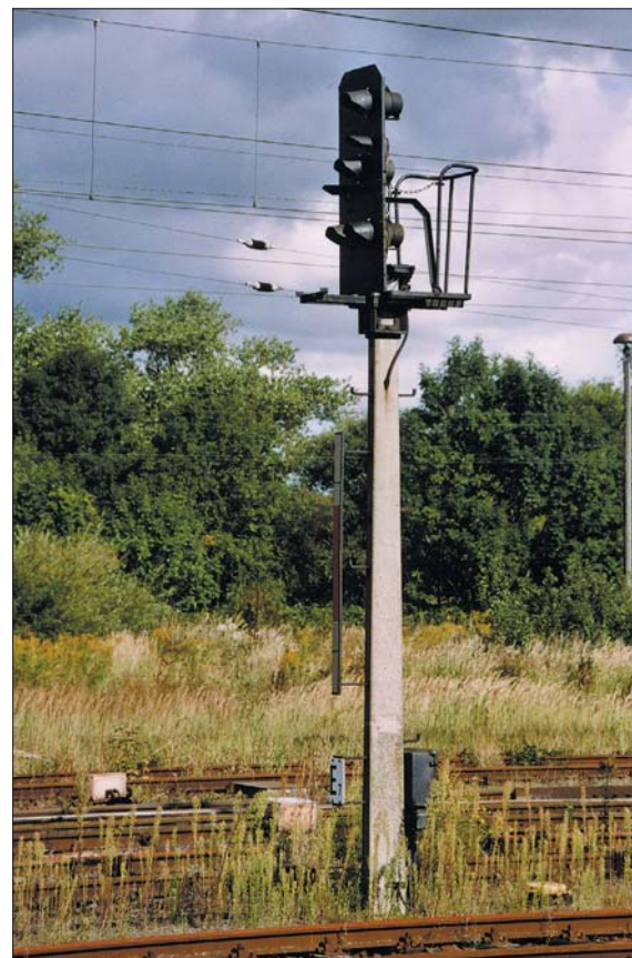
HI-Signal der Einheitsbauform mit 5,70 m langem Schleuderbetonmast im September 2005 im Bahnhof Wismar
