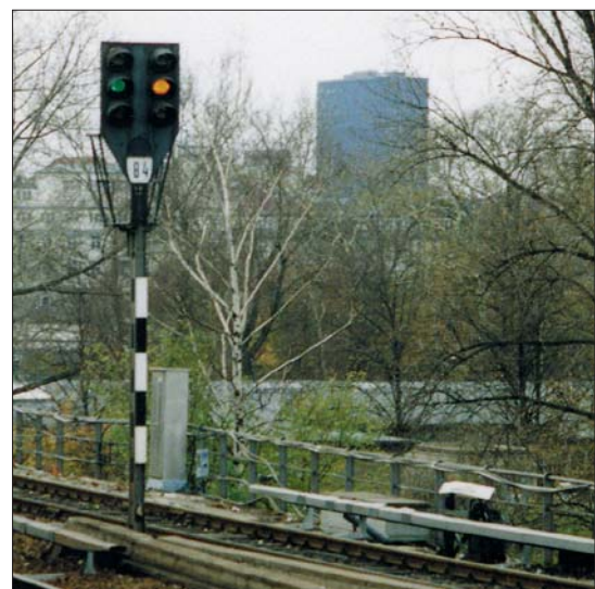
Das Selbstblocksignal 84 vor dem Bahnhof Berlin-Zoo im November 1991. Bei Störungen darf hier auf Sicht weitergefahren werden. Rechts im Bild die abliegende Fahrsperr, hinter dem Signalmast der Schaltschrank.
