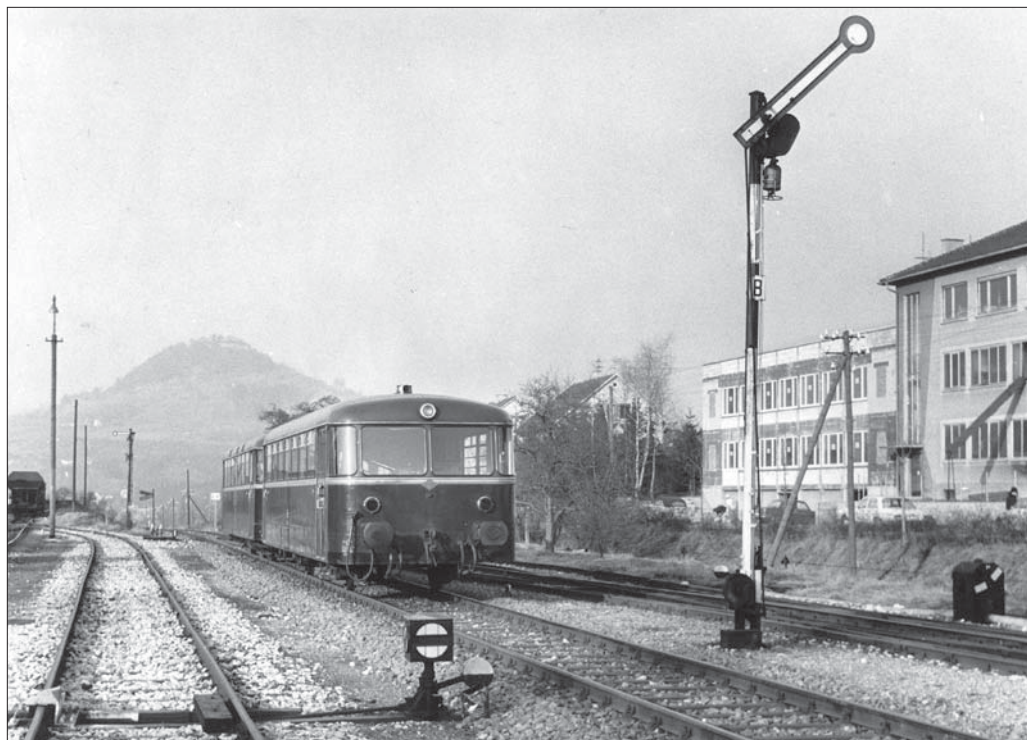
Ein Schienenbus verlässt am 7. Februar 1969 den Bahnhof Pfullingen. Während das Einfahrtsignal im Bildhintergrund ein Signal der Einheitsbauart ist, ist das Ausfahrtsignal noch württembergischen Ursprungs. Foto Herbert Stemmler
