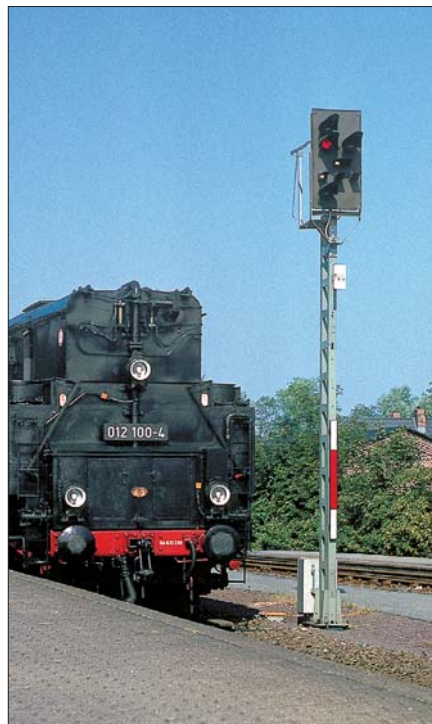
Hp 0 und Sh 1 (als Rangierauftrag für 01 1100 am 28. Juli 1971) an einem Kompaktsignal im Bf Husum. Kompaktsignale sind nach Signalen der Bauformen 51 (rechts) und Einheitsignalen Bauform 69 (links) die jüngste Generation konventioneller Lichtsignale der DB.
