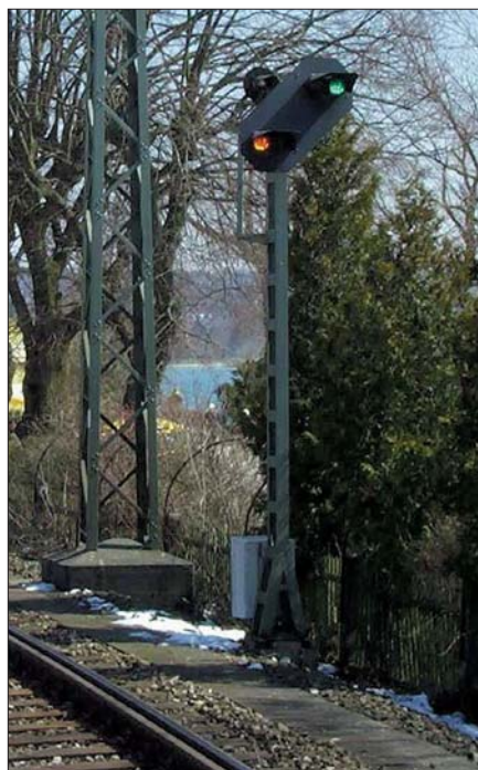
Vorsignalwiederholer der Einheitsbauform im März 2004 im Bahnhof Starnberg. Foto Alexander Lindner
