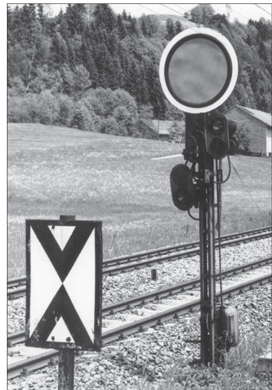
Rechts: Vorsignal der Einheitsbauform mit genietetem Signalmast, elektrischem Antrieb und elektrischer Laternenbeleuchtung 1956 bei Ratholz. Foto BD Augsburg, Sammlung SC
