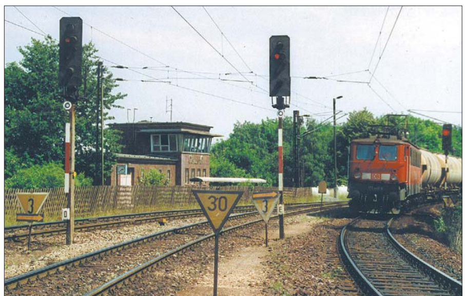
HL-Lichtsignale der Bauform 1962 im Bahnhof Michaelstein am 9. Juli 1972. Rechts fährt 171 013-6 mit einem Güterzug aus Blankenburg ein. Interessant sind die vor den HL-Signalen stehenden Langsamfahrtsignale. Die Geschwindigkeitstafel im Vordergrund und die nur für den abzweigenden Strang geltenden Langsamfahrtscheiben signalisieren 30 km/h. Foto Niels Kunick
