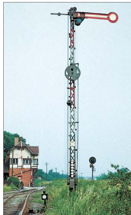
Ein Signal preußischer Bauart, noch mit einer Hubscheibe am Signalmast „irgendwo“ am Südharz. Sammlung Wolfgang List
