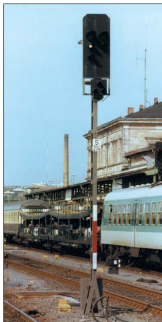
Zwischensignal mit Kennlicht – da betrieblich abgeschaltet – im Bf Hof. Für Kurzeinfahrten zeigt das Signal Hp 00. Für eine Ausfahrt zeigt nur das Signal am Bahnsteigende Hp 2. Foto Gerhard Scholtis
