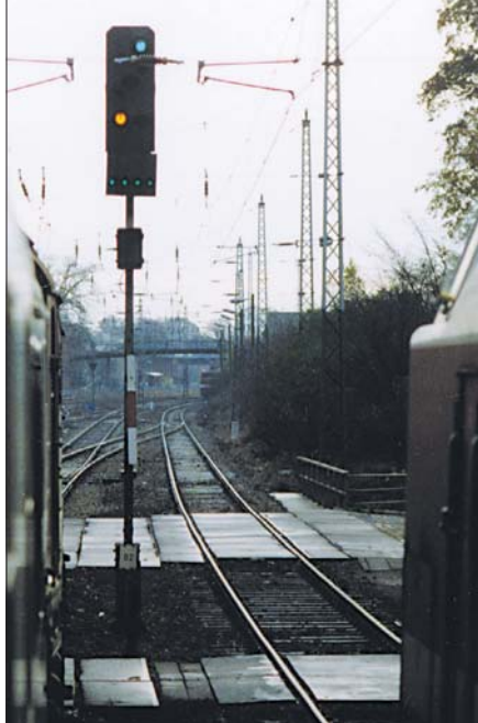
Weichen, die im abzweigenden Strang mit 100 km/h befahren werden können, waren im Netz der DR relativ selten. Dementsprechend besaßen nur wenige HI-Signale einen grünen Zusatzstreifen. Das Foto zeigt ein solches Signal im Bf Ludwigslust, das am 14. November 1991 für einen IC nach Berlin HI 2 zeigt.
