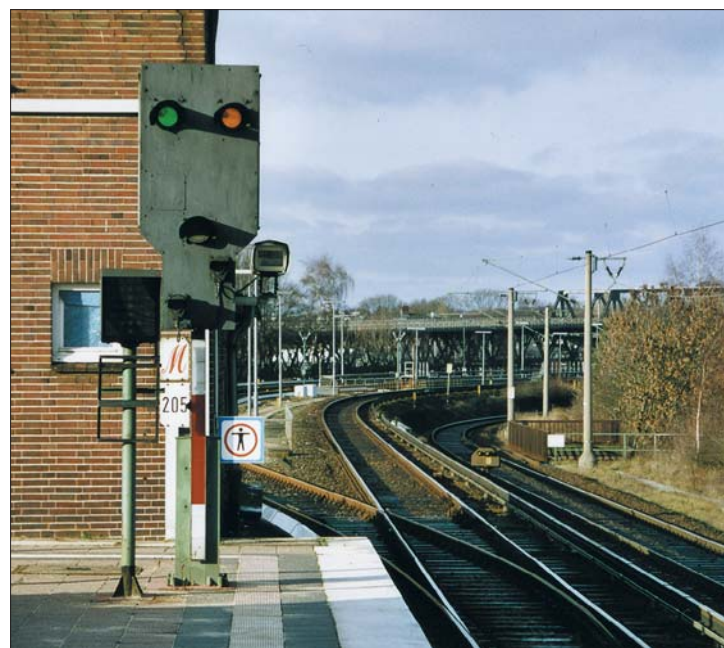
Rechts: Sv-Signal im Bahnhof Barmbek im Frühjahr 2004. Das Signal kann sowohl als Selbstblocksignal geschaltet als auch manuell bedient werden. Es zeigt dann in der Grundstellung Hp 0; zum Aussetzen von Zügen als Rangierfahrt befindet sich das Sh 1-Signal hier unterhalb des Hauptschirms.
