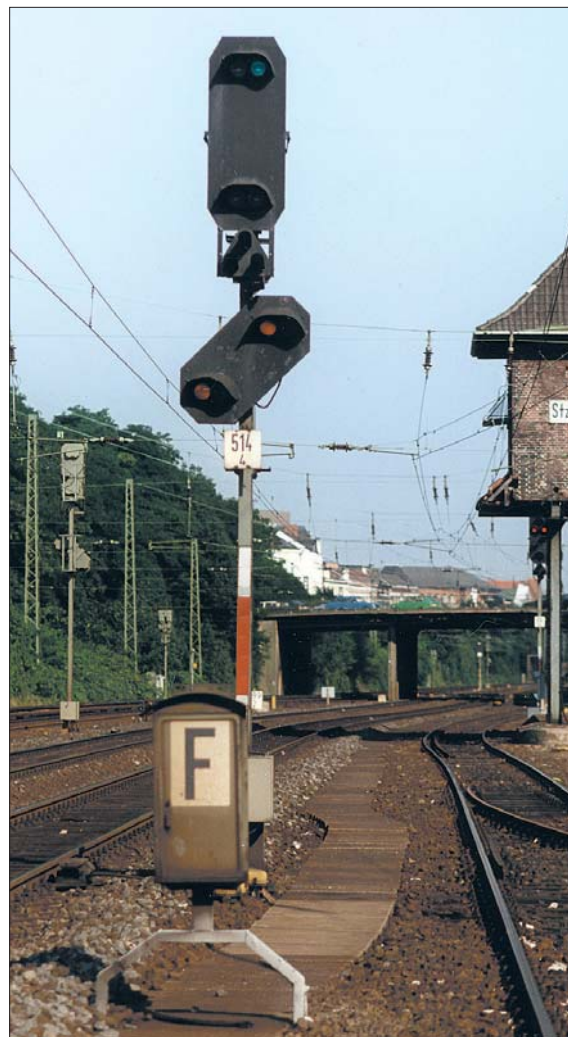
Rechts: Ausfahrtsignal und Vorsignal der Bauform 1951 in der Stellung Hp 1/Vr 0 für das folgende Selbstblocksignal im Bahnhof Hamburg-Sternschanze im September 1991. Das Signal konnte sowohl als Selbstblocksignal geschaltet werden als auch von dem inzwischen nicht mehr vorhandenen Stellwerk „Stz“ bedient werden.
