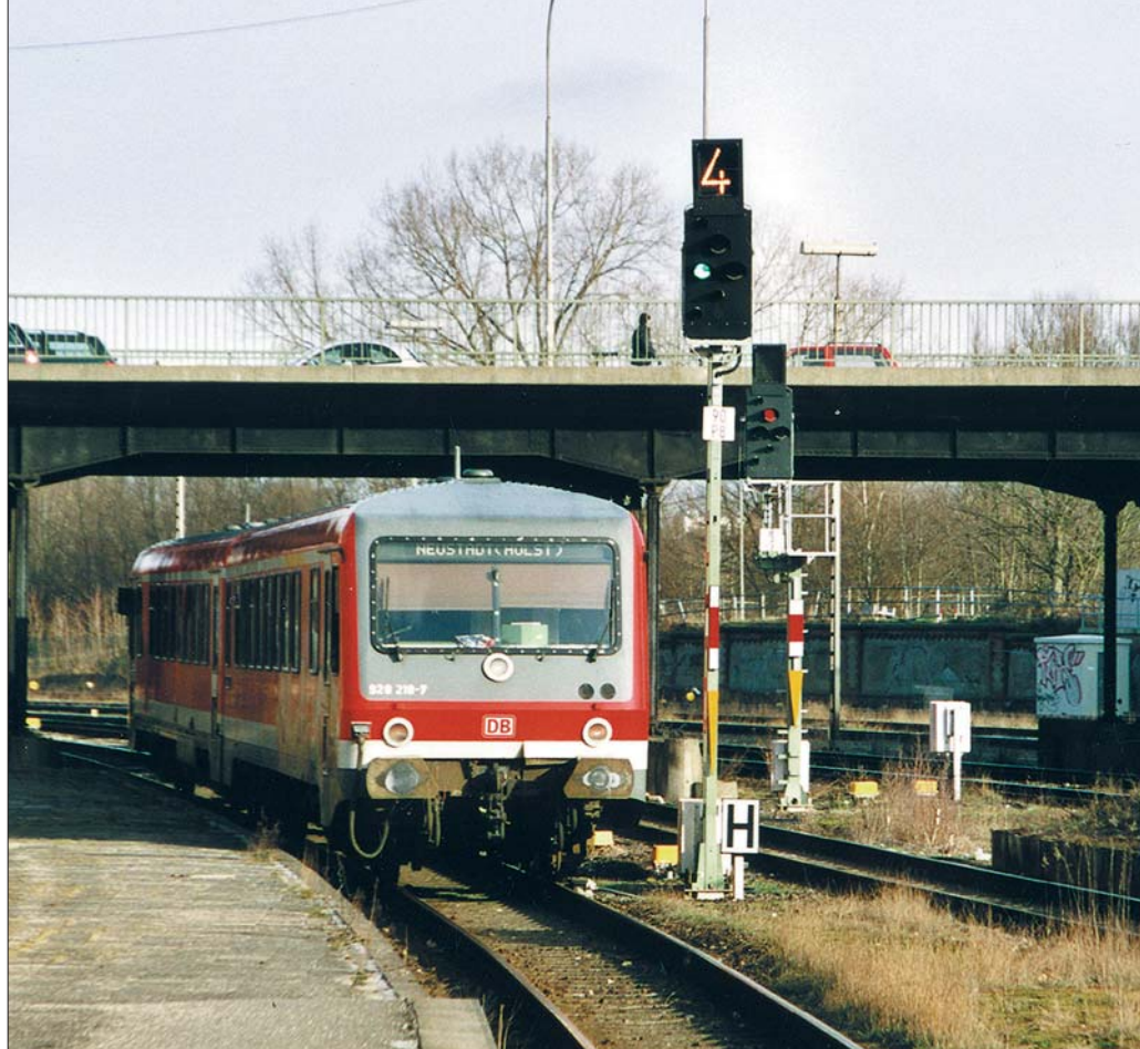
Ks 1 mit Zusatzanzeiger für 40 km/h am 28. April 2004 für einen aus Lübeck Hbf ausfahrenden 628 der Regionalbahn Schleswig-Holstein
