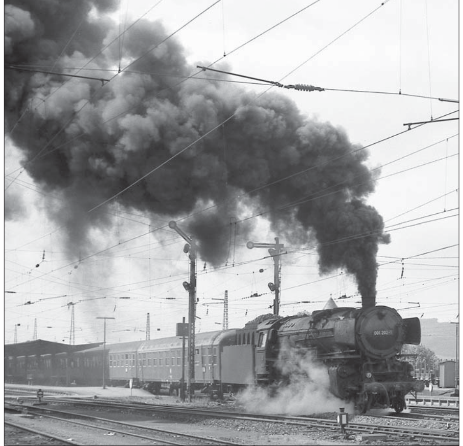
001 202-1 fährt am 4. August 1972 mit dem D 853 nach Hof aus Lichtenfels aus. Das zweiflügelige Ausfahrtsignal zeigt für diesen Fahrweg Hp 1.
