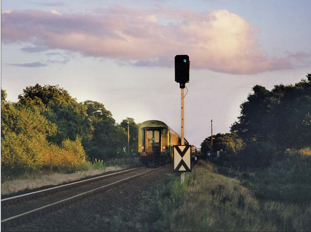
HL 1 „Fahrt mit Höchstgeschwindigkeit“ für den E 2837 Hamburg Hbf–Schwerin am Einfahrvorsignal des Bahnhofs Schwanheide am Abend des 12. September 1991.
