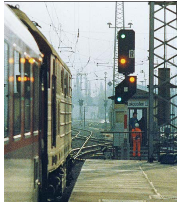
Im November 1991 zeigt das Ausfahrtsignal in Magdeburg Hbf für einen IC nach Braunschweig HI 102 und VI 102.
