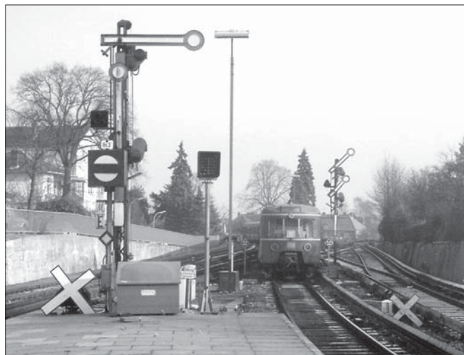
1991 wurden die Formsperrsignale des Bahnhofs Blankenese durch Lichtsignale ersetzt. Die noch nicht in Betrieb befindlichen Signale sind durch weiße Kreuze ungültig gemacht. Im Hintergrund eine nach Wedel ausfahrende S-Bahn.
