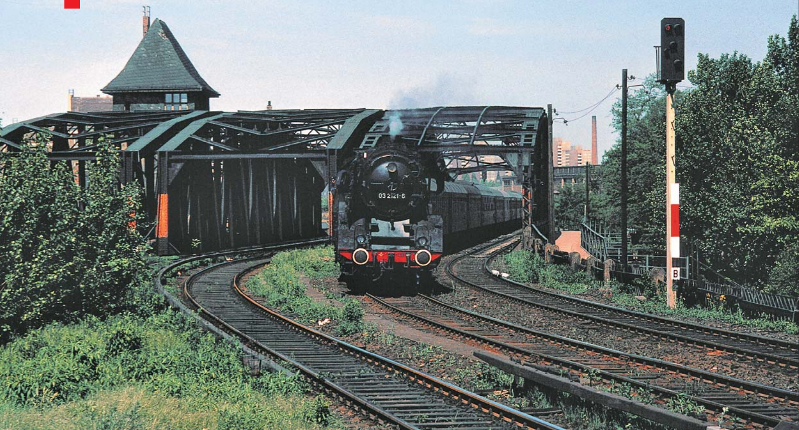
03 2121-6 vom Bw Leipzig Hbf-West rollt am 29. Mai 1977 mit dem Leerpark für den D 562 von Berlin-Lichtenberg nach Schöneweide über die Spreebrücke kurz vor dem S-Bahn-Haltepunkt Treptower Park. Neben der Lok ein HL-Signal in der Stellung HL 10 „Halt erwarten“.
