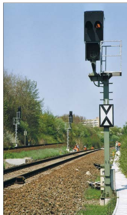
Links: Zwei Mehrabschnittssignale in Lübeck Hbf im April 2004. Das linke Signal hat einen einfachen Mast. Das rechte, Ks 2 (mit 60 km/h) anzeigende Signal hat einen 3,48 m langen Auslegermast.
