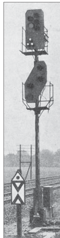
Teilweise retuschierte Fotos der Signale an der Strecke Düsseldorf–Duisburg: Links im Ursprungszustand mit aufleuchtendem Ersatzsignal, rechts in der Form ab 1943.
