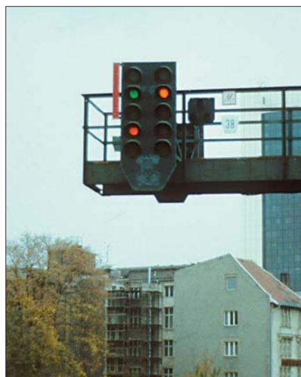
Der Schirm des Signals 38 bildete mit zehn Signallaternen eher eine Ausnahme. Das Signal konnte sowohl als Selbstblocksignal geschaltet sein, als auch manuell bedient werden. Foto Sigrid Mörschel
