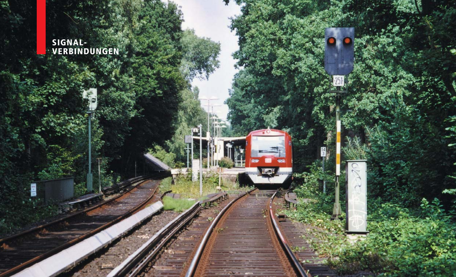
Auch 2005 noch im Netz der Hamburger Gleichstrom-S-Bahn zu finden: Blendenrelaissignale der ersten Generation, hier in der Stellung Sv 0 (früher Sv 3) vor dem Haltepunkt Hoheneichen. Vor dem Signal der Schaltkasten, dahinter ein gerade eingefahrener S-Bahn-Zug.
