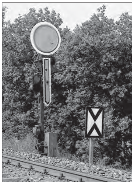
Heute übliche Ausführung der Vorsignaltafel am Einfahrvorsignal des Bahnhofs Lübeck-Blankensee im Juni 1979
