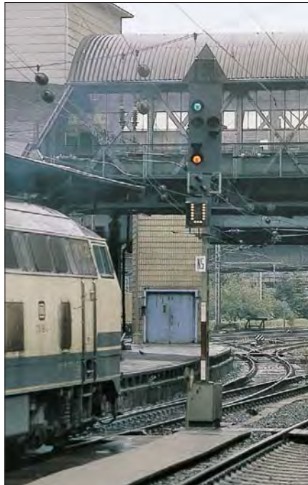
Geschwindigkeits- und Richtungsanzeiger mit 7 x 5 Lichtpunkten an einem Ausfahrtsignal der Einheitsbauart des Bahnhofs Hamburg-Harburg. Das aufleuchtende „U“ zeigt an, dass die Fahrstraße für den von einer 218 gezogenen Nahverkehrszug am 10. Juni 1991 in Richtung Unterelbe führt.
