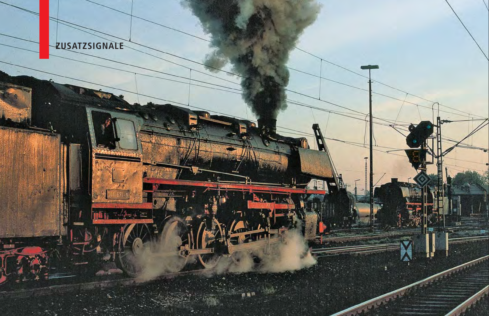
044 671-6 vom Bw Ottbergen fährt am Abend des 11. Mai 1976 mit dem Gdg 57456 nach Rheine aus dem Rbf Löhne aus. Unter dem im verkürzten Bremsweg stehenden Vorsignal leuchtet ein Geschwindigkeitsvoranzeiger mit der Kennziffer „8“ auf, um anzuzeigen, dass der Fahrweg am Hauptsignal auf Hp 1 mit 80 km/h über den abzweigenden Strang von Weichen führt. Im Hintergrund wartet 044 334-1 auf den nächsten Einsatz. Foto – sowie alle folgenden ohne Urheberangabe – SC
