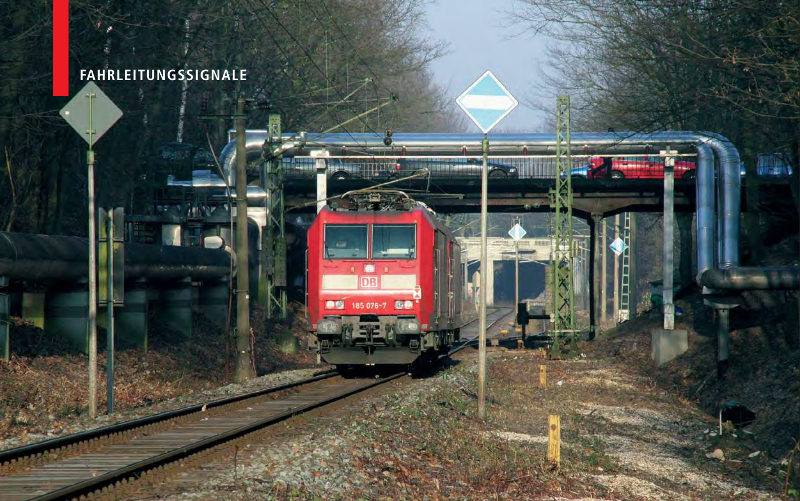
185 076-7 rollt mit einer weiteren 185 als Lz am 6. Januar 2006 mit abgesenkten Stromabnehmern unter einer niedrigen Straßenbrücke im Bahnhof Hamburg-Horn hindurch, unter der wegen der zu geringen lichten Höhe keine stromführende Fahrleitung durchgeführt werden konnte. Vorn das „Bügel ab“-Signal und links das „Bügel an“-Signal für die Gegenrichtung, im Hintergrund die „Bügel an“-Signale hinter der Brücke.
