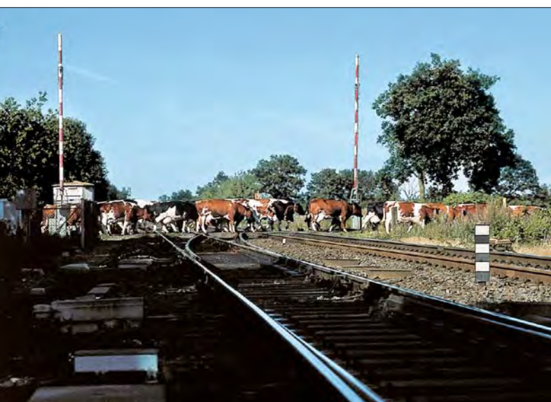
Nichtreflektierende, niedrige Merktafel vor einem Feldwegübergang im Bahnhof Wrist im August 1991
