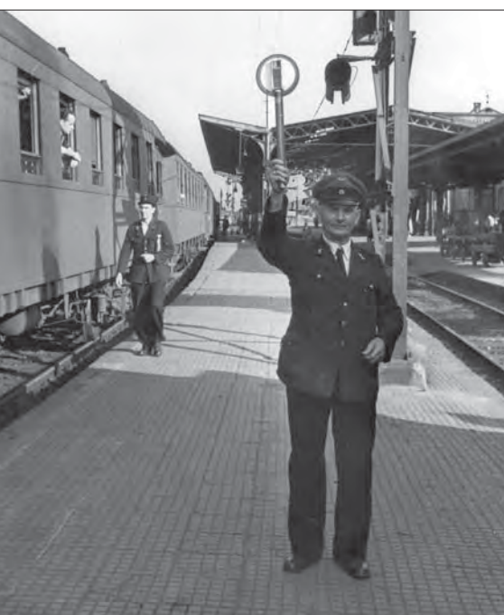
„Türen schließen“ und „Abfahren“ als Lichtsignale der DB (links) und DR (Mitte) sowie der Befehlsstab
