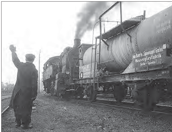
Zwei Bilder aus dem Rbf Hamburg-Rothenburgsort vom 19. November 1951. Links gibt der Rangierleiter für eine Rangierabteilung das Signal Ra 1 „Wegfahren“, rechts signalisiert er durch das Signal Ra 2 „Herkommen“ vom ersten Wagen der geschobenen Rangierabteilung aus, dass der Fahrweg frei ist. Fotos Hollnagel, Sammlung SC
