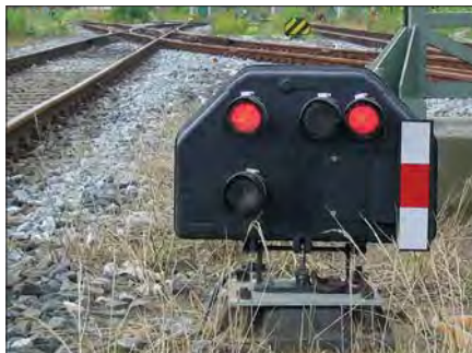
Sh 0 an einem niedrigen Gleissperrsignal im Bahnhof Hamburg-Langenfelde im Juli 2004
