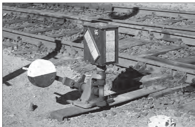
Rechts: Weichensignal mit Reflektorschildern an einer ortsgestellten Weiche in Büchen im Februar 1974
