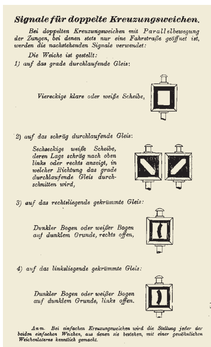
Oldenburgische Weichensignale, oben für symmetrische Weichen, rechts für DKW mit Parallelschaltung
