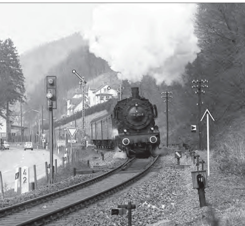
038 328-8 fährt am 28. Februar 1974 mit dem P 3977 Freudenstadt–Hausach aus Wolfach aus. Im Vordergrund die Rückansicht eines Blinklichtüberwachungssignals sowie eine Schneepflugtafel und dahinter eine Neigungswechseltafel.
