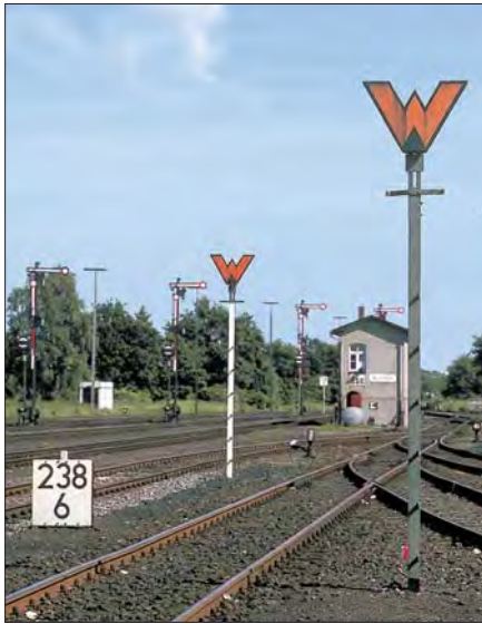
Wartezeichen an Lokabstellgleisen im Bahnhof Büchen im Juni 1983. Da bei dem linken Wartezeichen der Gleisabstand weniger als 4,50 m beträgt, ist es mit einem Gefahranstrich versehen.
