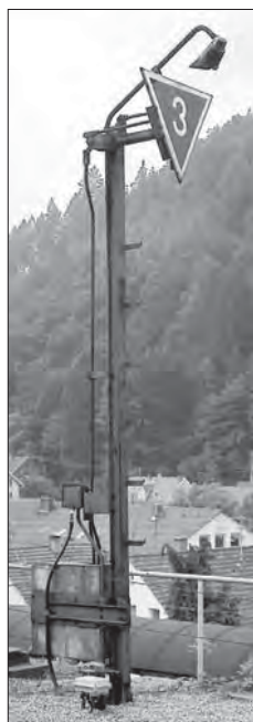
Verstellbarer Geschwindigkeitsanzeiger (vor dem Einfahrsignal aus Richtung Stuttgart) im Bahnhof Calw im August 1981
