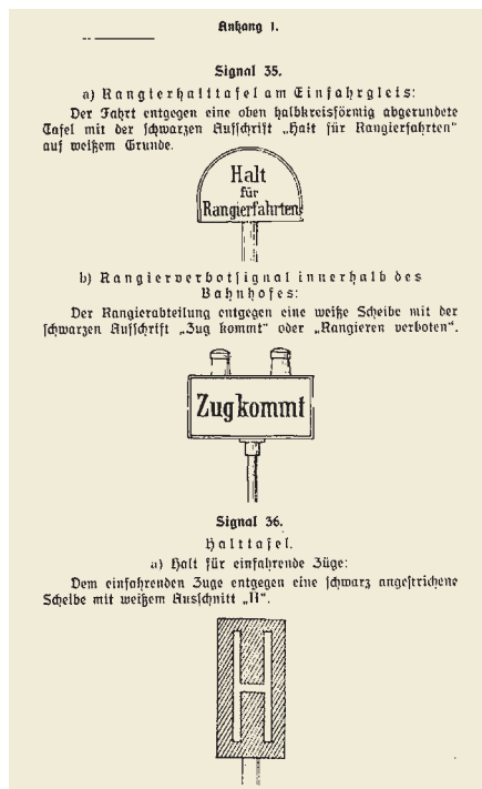
Darstellung der Signale 35a, 35b sowie 36a in dem Preußischen Signalbuch der Direktion Schwerin aus dem Jahr 1912
