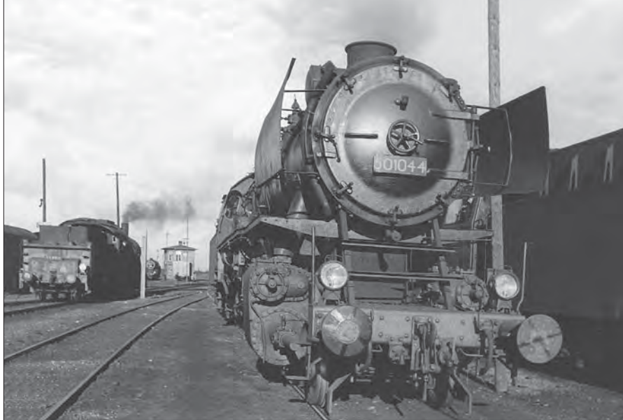
Bw Göttingen Vbf am 16. Januar 1951. Vorn 50 1044 mit dem damals noch üblichen Spitzensignal, hinten links eine für den Verschub eingesetzte Lok der Baureihe 55 25 , die „nur“ das Rangierlokomotivsignal führt. Foto Bustorff, Sammlung SC
