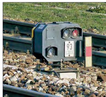
Rechts: SEL-Sperrsignal mit nur einem Rotlicht im November 2004 im Bahnhof Neufahrn/Niederbayern.
