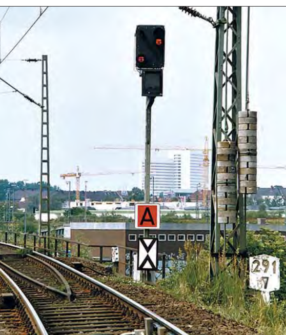
Während früher auch die Abmessungen der Signaltafeln vorgeschrieben waren, gilt dies heute nur noch für die Signalbilder. Links: Eine quadratische Anfangstafel an einem Vorsignal im Juni 2004 in Hamburg-Altona
