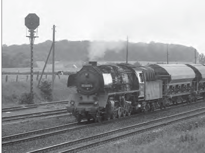
50 0005-4 vom Bw Wittenberge fährt am 30. Juni 1977 mit einem Getreidezug Wittenberge–Wismar aus Richtung Schwerin kommend in den Bahnhof Bad Kleinen ein. Neben der Lok ein Lichtabdrücksignal der bei der DR üblichen Bauform.
