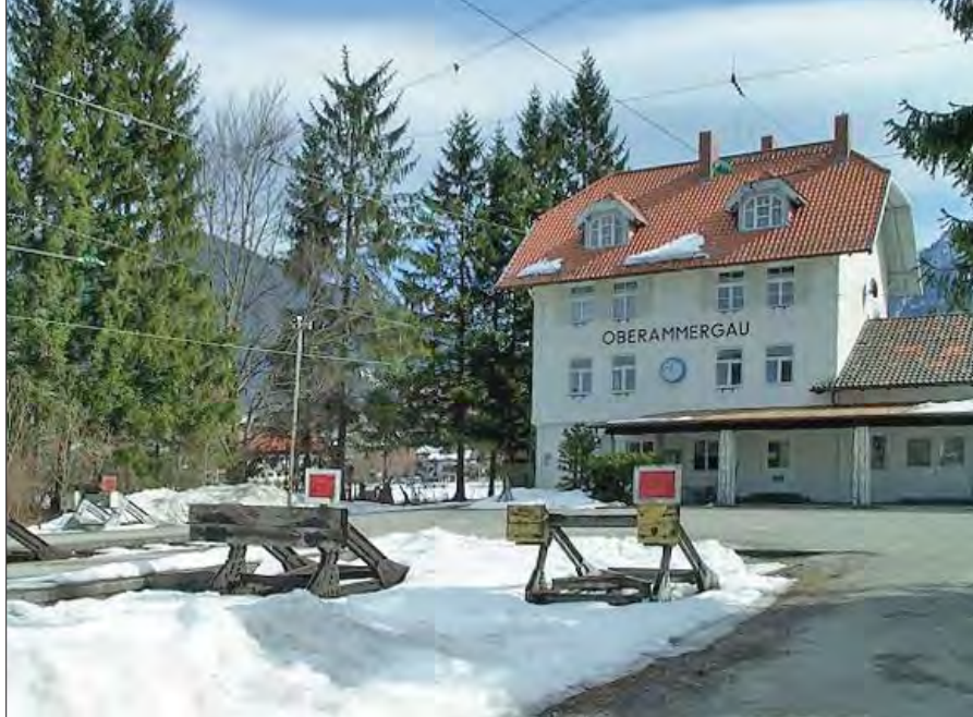
Sh 2-Scheiben an den Prellböcken der Einfahrstumpfgleise des Bahnhofs Oberammergau im März 2003. Foto Alexander Lindner
