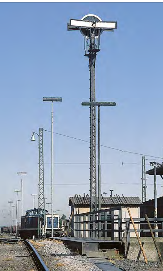
Links: Ein Formabdrücksignal in der Stellung „Halt! Abdrücken verboten“ im Juni 1983 im Rbf Hamburg-Unterelbe-Seehafenbahnhof
