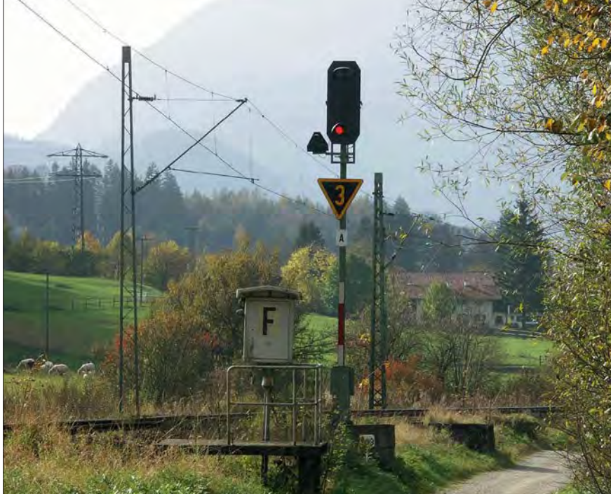
Signalbilder eines Geschwindigkeitsvoranzeigers als Signaltafel (links) und des Frühhalt- und Frühhaltvoranzeigers der DB in doppelter H0-Größe
