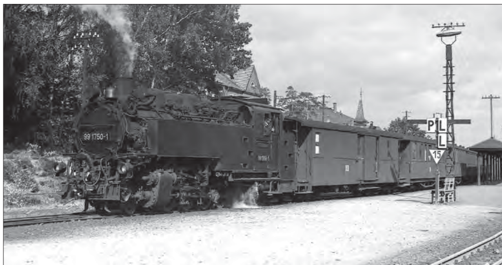
991750-1 wartet am 2. Oktober 1977 im Bahnhof Bertsdorf auf den Abfahrtauftrag. Rechts im Bild die 1958 bei der DR eingeführte Durchläutetafel mit einer Geschwindigkeitstafel für 15 km/h und einem Wiederholungszeichen. Sammlung SC
