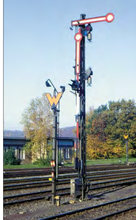
Hauptsignale mit unbeleuchteten Wartezeichen mit Sh 1-Signal am Signalmast im Rbf München-Laim im Februar 2005. Foto Alexander Lindner
