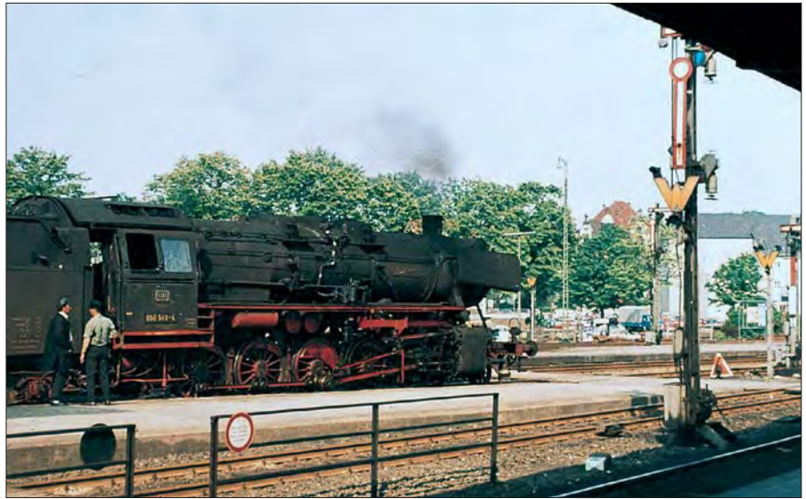
Das Personal der 050 540-3 wartet am 8. Juni 1970 im Bahnhof Goslar neben seiner Lok auf den Fahrauftrag. Vor den Ausfahrtsignalen des Bahnhofs stehen Wartezeichen (bzw. sind an den Hauptsignalmasten angebracht), die – obwohl gemäß Signalbuch bereits seit 1959 durch das Sh 1-Signal ersetzt – zum Zeitpunkt der Aufnahme noch die aus drei Lichtern gebildeten Vorrücksignale besaßen.
