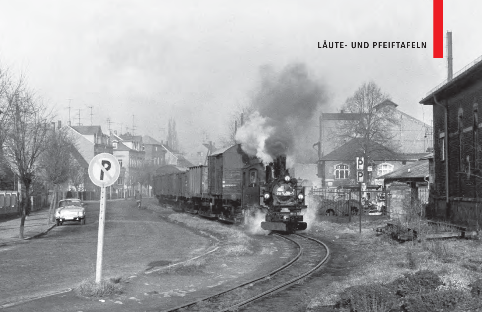
99 1608-1 dampft mit einem Rollbockzug am 24. Dezember 1974 durch Oschatz Richtung Mügeln. Neben der Lok eine von der DR 1958 eingeführte Pfeiftafel vor Wegübergängen. Sammlung SC
