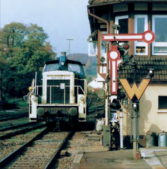
Ebenfalls im Oktober 1984 entstand das Foto der im Bahnhof Herzberg rangierenden 260 008-8. An dem niedrigen Wartezeichen, einer Sonderkonstruktion, leuchte das Sh 1-Signal auf. Foto Horst Müller-Kuntzer
