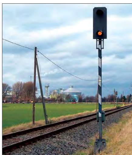
Blinklicht-Überwachungssignal der Bauform 1975 im Januar 2004 an der Strecke Euskirchen–Bad Münstereifel bei Stotzheim
