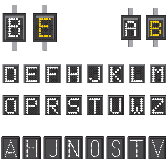
Links: DB-Richtungs- und Richtungs-voranzeiger in 1,5-facher H0-Größe: Oben Gegenüberstellung der Matrix aus 8 x 5 Lichtpunkten und 7 x 5 Lichtpunkten. In der Mitte die für diese Anzeiger zugelassenen Buchstaben, wobei „D“ und „O“ oder „H“ und „B“ nicht am selben Signal verwendet werden durften. Unten einige Beispiele von Buchstaben an Anzeigern mit 28 x 22 Lichtpunkten.
