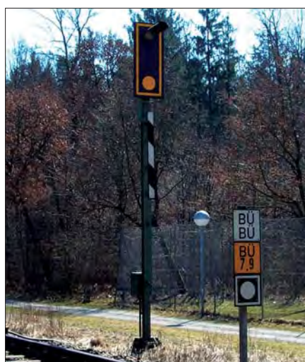
Überwachungssignal der Bauform 1975 mit Abdeckblech sowie BÜ-Tafeln im März 2003 in Neuburg. Fotos Alexander Lindner
