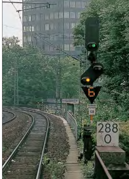
Geschwindigkeitsvoranzeiger für 60 km/h an dem Blocksignal hinter dem Bahnsteig in Hamburg-Dammtor im Juli 1991
