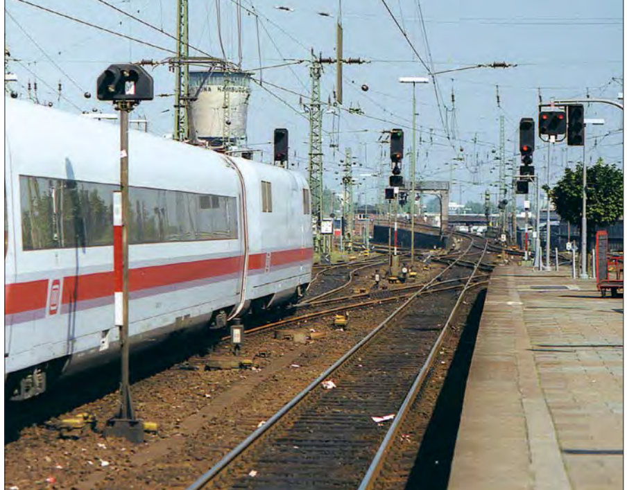
Zwergsignal der Siemens-Bauform 1958 in Hamburg Langenfelde im Juni 2004
