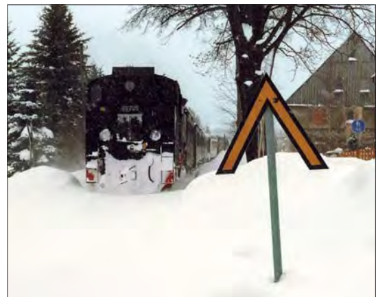
01 1061 mit dem D 26082 Braunschweig–Ottbergen am 8. Juni 1975 bei Lenne. Vor dem Bahnübergang steht ein Signal „Pflugschar heben“, dahinter das Signal „Pflugschar senken“.
