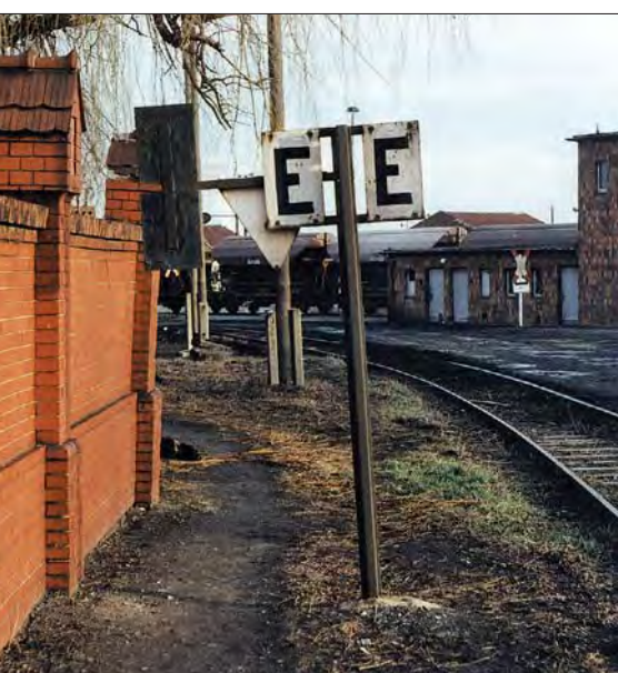
Durchläuteendtafel (die Durchläutebeginntafel für die Gegenrichtung ist am gleichen Mast montiert) im November 1990 in Halberstadt
