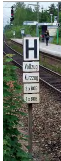
H-Tafel mit Zusatzschildern für unterschiedliche Züge (S-Bahn und BOB) im Juni 2004 im Bf München-Solln.
