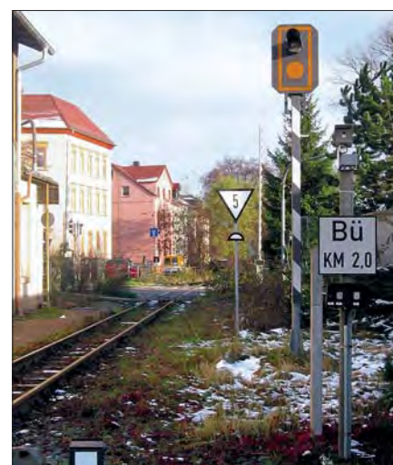
BÜ-Tafel und BÜ-Überwachungssignal mit Rohrmast im November 2004 im Bahnhof Oschatz-Süd. Foto Niels Kunick
