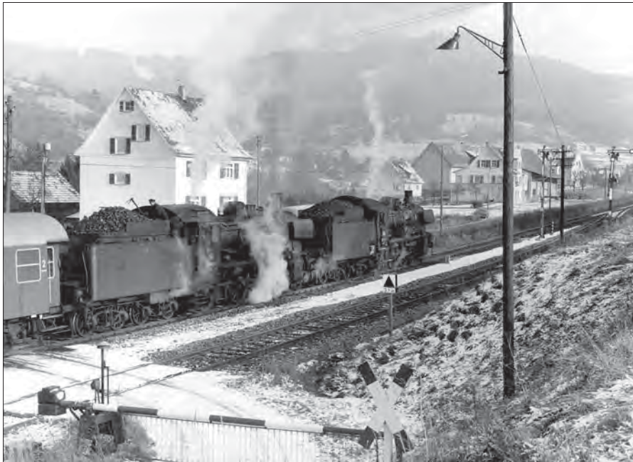
038 711-8 und 038 382-8 warten am 17. Dezember 1970 vor dem N 4318 Tübingen–Sigmarin- gen im Bahnhof Laufen auf die Ausfahrt. Im Vordergrund der Neigungswechselanzeiger, der die 3,7 km lange Steilrampe nach Ebingen ankündigt, die noch im Bahnhofsbereich beginnt. Foto Herbert Stemmler
