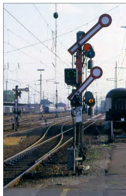
„Türen schließen“ und „Abfahren“ als Lichtsignale der DB (links) und DR (Mitte) sowie der Befehlsstab
