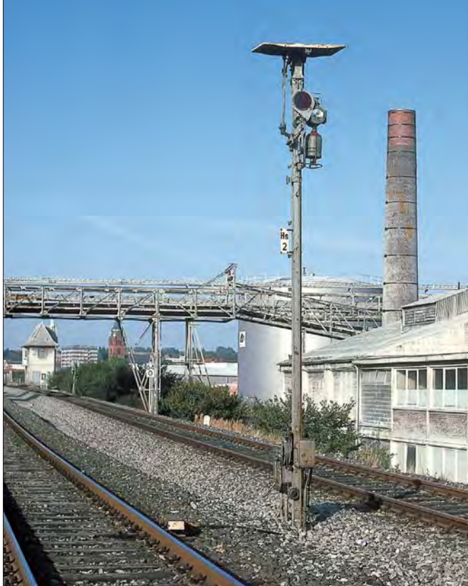
Vor der Störbrücke in Itzehoe standen hohe Brücken-deckungssignale mit Propanbeleuchtung. Das Foto zeigt eines der Signale im September 1983, die Scheibe ist waagrecht geklappt, die Gleissperrung ist aufgehoben.
