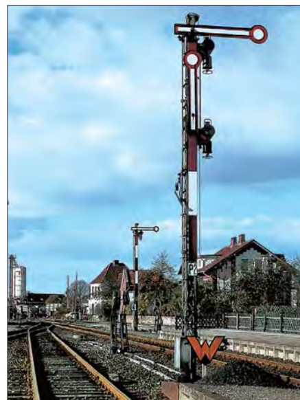
Rechts: Niedriges Wartezeichen vor einem Ausfahrtsignal im Bahnhof Bad Segeberg im Oktober 1979
