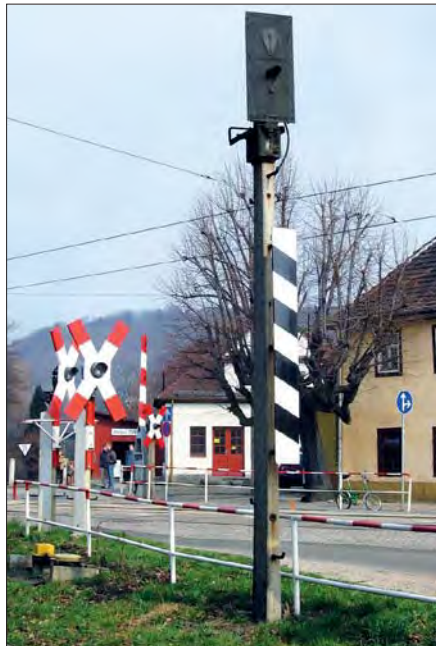
Altes Blinklicht-Überwachungssignal der DR mit dem typischen WSSB-Schleuderbetonmast im März 2004 am Haltepunkt Weißes Roß in Radebeul. Foto Niels Kunick
