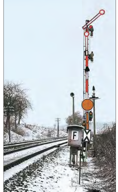
Herzberg im Januar 1985. Das Einfahrsignal F aus Richtung Walkenried zeigt für einen im durchgehenden Hauptgleis haltenden Zug Hp 1. Vor dem Haupt- und Vorsignal der im Lageplan nicht dargestellte, zwischenzeitlich aufgestellte Geschwindigkeitsanzeiger für die Einfahrten in Gleis 4–7 mit 30 km/h.
