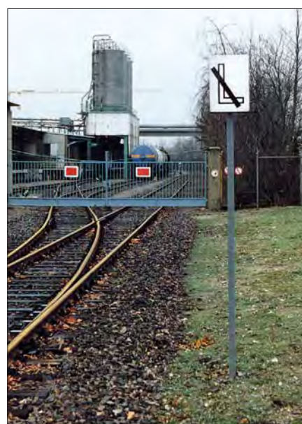
Durchläuteendtafel LP 5 der HGK vor einer Werkseinfahrt im Niehler Hafen in Köln im Jahr 2004. Fotos Michael Schnippering
