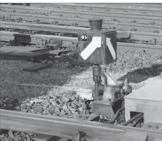
Signal an einer Außenbogenweiche im Bahnhof Furth i. W. im Juli 1997. Während Weichensignale mit Reflektorschildern im Grundriss quadratische Signalkörper haben und daher die Signalbilder der Regelausführung entsprechen, besitzen beleuchtete Weichensignale einen im Grundriss 300 x 220 mm großen Signalkörper, sodass die Pfeile an den Stirnseiten andere Abmessungen haben.
