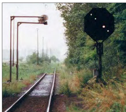
Niedriges Lichtabdrücksignal mit vier Lichtpunkten unter einer Straßenbrücke in Stendal im Oktober 1991 in den Stellungen Ra 7–Ra 9 . Slg. SC
