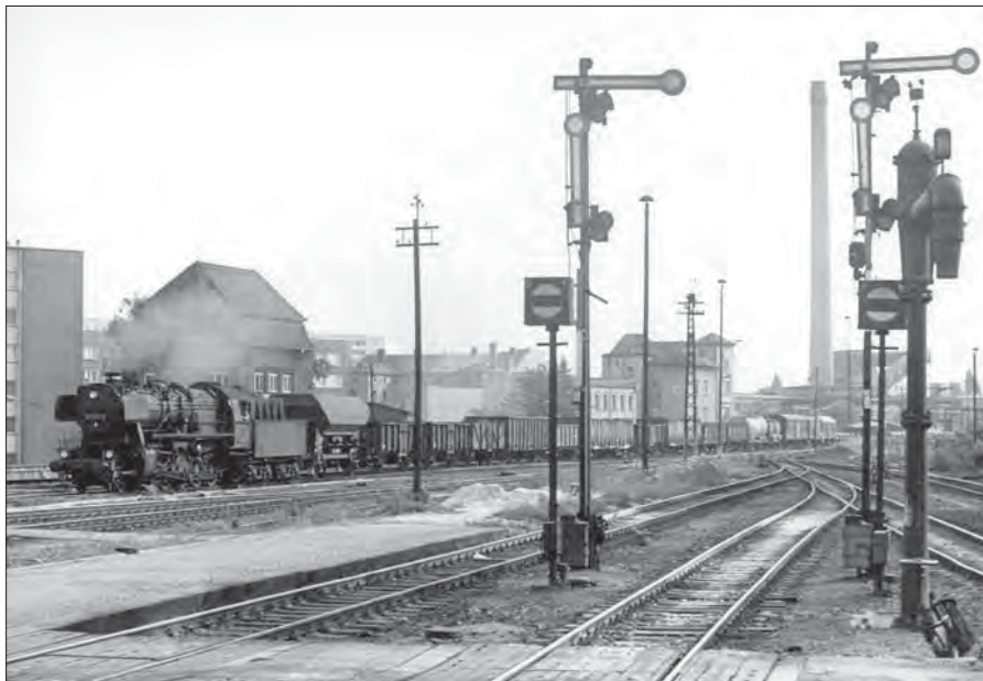
50 3102-6 vom Bw Reichenbach mit einem Güterzug am 17. Juli 1974 in Gera. Rechts zwei Ausfahrtsignale – das rechte mit Ersatzsignal –, vor denen Hauptsperrsignale stehen. Sammlung SC
