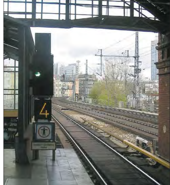
Geschwindigkeitsvoranzeiger für 40 km/h an einem Ks-Signal am S-Bahn-Haltepunkt Hackischer Markt im November 2004
