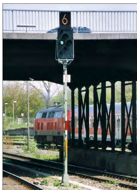
Links: An einem Ks-Mehrschnittsignal aufleuchten der Geschwindigkeitsanzeiger für 60 km/h in Lübeck Hbf im April 2004
