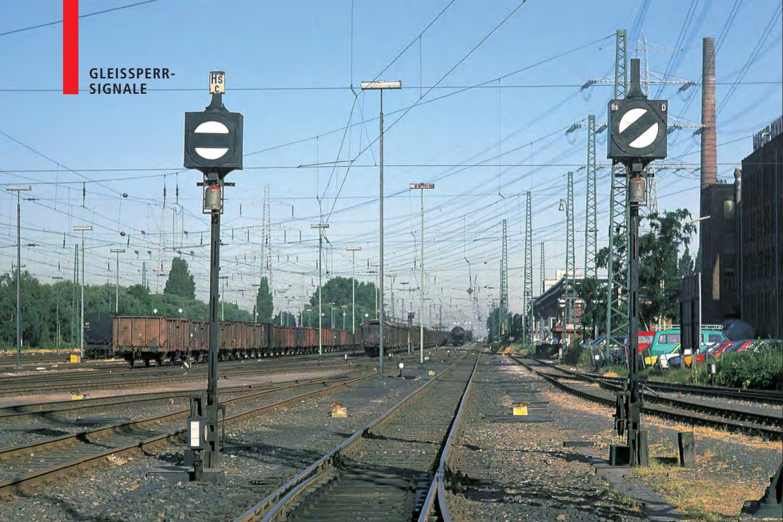
Alte Ausführung der Hauptsperrsignale im Rbf Hamburg-Unterelbe-Seehafenbahnhof im Juni 1983 in den Stellungen „Halt! Fahrverbot“ (links) und „Fahrverbot aufgehoben“ (rechts). Beide Signale haben keine Abdeckkästen über den Antrieben.
