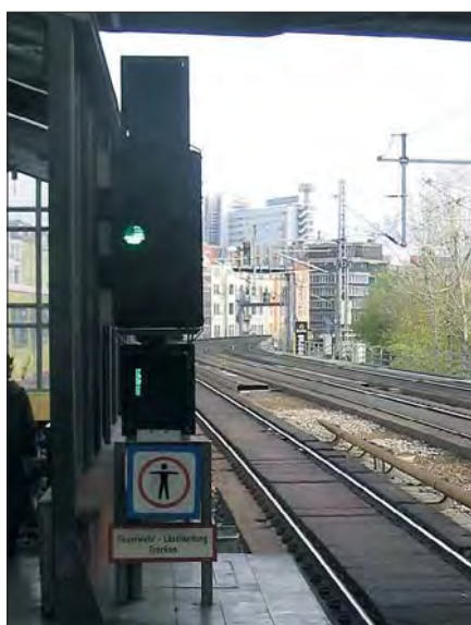
„Abfahren“, ebenfalls an einem Ks-Signal der Berliner S-Bahn im November 2004, hier am Haltepunkt Hackescher Markt
