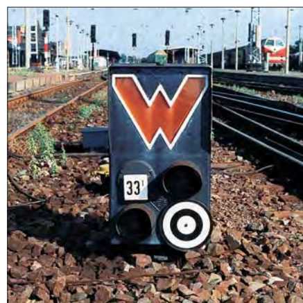
Niedriges beleuchtetes Wartezeichen mit Ra 12-Signal im Oktober 1991 im Bahnhof Stendal. Die Kreisscheibe bedeutet, dass das Signal auch dann als Fahrauftrag gilt, wenn es bereits vor Annäherung der Rangierabteilung leuchtet. Sammlung SC
