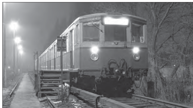
Links unten: Die alten Züge der Berliner S-Bahn besaßen ursprünglich nur eine Laterne für das Spitzensignal. Das Foto zeigt den restaurierten Museumszug bei der Ausfahrt aus dem Bahnhof Friedrichstraße im November 1991. Daneben ein Berliner S-Bahn-Zug in der Kehranlage Sonnenallee im Jahr 1979. Das Richtungsschild ersetzte das 3. Signallicht. Foto Detlef Jentzsch
