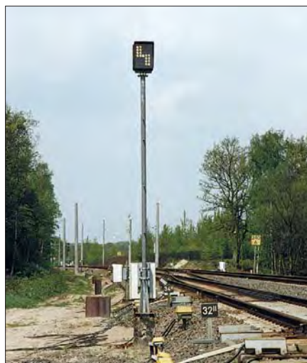
Gleiswechselanzeiger im Bahnhof Büchen im Juli 1996. Das Signal leuchtet auf, da wegen der Elektrifizierungsarbeiten die Strecke nur eingleisig zu befahren war.
