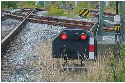
Zwergsignal der Siemens-Bauform 1958 in Hamburg Langenfelde im Juni 2004
