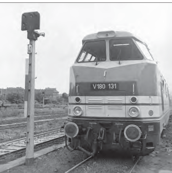
V 180 131 mit „Plastevorbau“ Neben der Lok ein DR-Lichtsperrsignal der WSSB-Bauform. Foto DR, Sammlung SC
