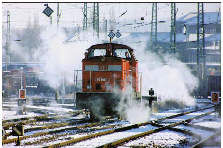
346 883-2 im Jahr 2003 als Weichenheizung in Zwickau Gbf. Links und rechts im Bild Lf 1/2-Signale, die anzeigen, dass der anschließende Weichenbereich nur mit 30 km/h befahren werden darf. Foto DB AG, Weber
