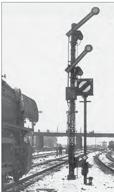
Links: 298 150-4 kommt mit einer Übergabe am 24. August 2004 im Bahnhof Gera-Süd an. Da an dem Signal C vorbei nur auf das Gegengleis ausgefahren werden kann, ist es mit einem Links-fahrt-Auftragssignal als Signaltafel ausgerüstet. Foto Niels Kunick
