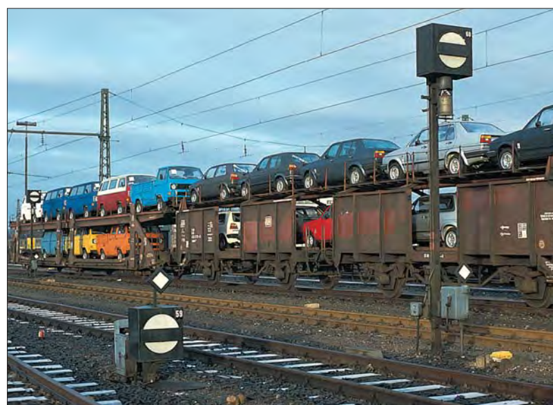
Auch das im Juni 1983 in Billwerder-Moorfleet fotografierte Sperrsignal entspricht der alten Form, nur das Aufsatzblech für das Mastbezeichnungsschild wurde demontiert und der Antrieb hat eine Abdeckung erhalten.
