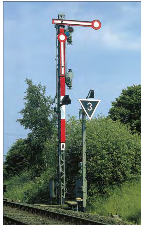
Das Einfahrtsignal des Bahnhofs Ascheberg im Juni 1983 mit einem verstellbaren Geschwindigkeitsanzeiger für 30 km/h (für eine Fahrstraße in ein Stumpfgleis)
