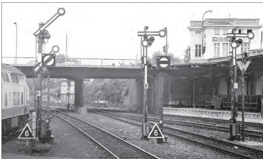
Vor den beiden linken Ausfahrtsignalen in Lübeck Hbf stehen Hauptsperrsignale sowie niedrige Geschwindigkeitsanzeiger; die Weichen in diesen Fahrstraßen lassen auch im abzweigenden Strang 60 km/h zu. Vor dem rechten Ausfahrtsignal kann auf ein Gleissperrsignal verzichtet werden, da es hier nicht zum Flankenschutz erforderlich ist. Seine Funktion für die Regelung der Rangierfahrten übernimmt hier ein Wartezeichen.
