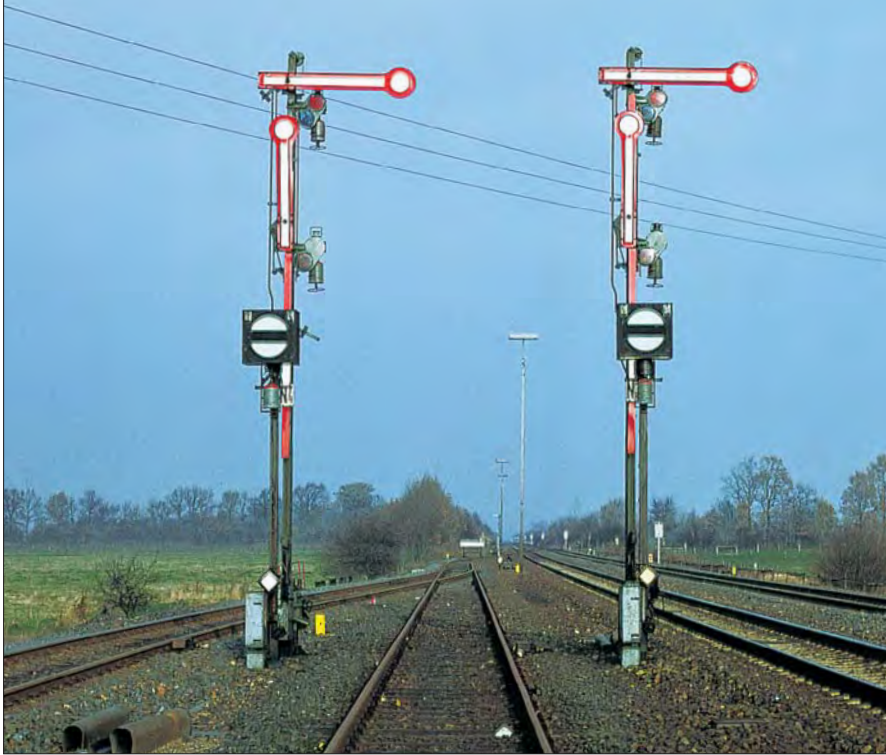
Die im November 1979 im Bahnhof Wrist fotografierten Hauptsperrsignale haben Rückstrahlschilder. Bei ihnen gilt das Signal Sh 1 für unbegleitete Rangierabteilungen als Fahrauftrag.
