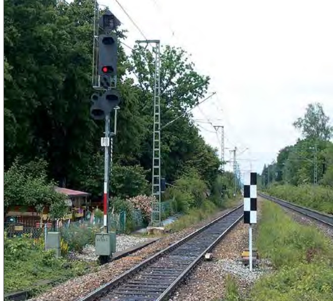
Hohe Schachbretttafel neben einem links stehenden Ausfahrtsignal mit Gleiswechselanzeiger für eine Überleitstelle im Bahnhof München-Solln im Juni 2004. Foto Alexander Lindner
