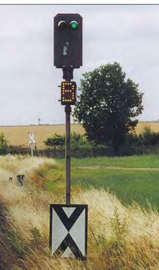
Richtungsvoranzeiger – „H“ für Hannover – vor dem Einfahrsignal des Bahnhofs Kreisen im Juli 1952. Foto Bustorff, Sammlung SC
