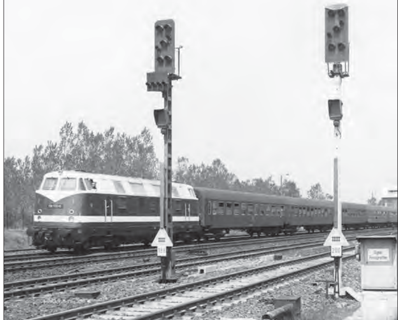
118 170-0 fährt am 18. Mai 1976 mit einem Schnellzug in den Bahnhof Trebbin ein. Im Vordergrund zwei HI-Signale mit roten Mastschildern für permissives Fahren und Wegübergangstafeln. Foto DR, Slg. SC
