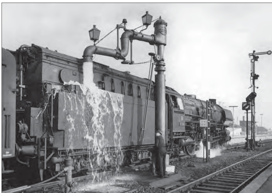
01 1066 nimmt bei einem Zwischenstopp mit dem E 521 Düsseldorf–Hamburg in Osnabrück Hbf im März 1965 Wasser. Beachtung verdienen an dieser Aufnahme nicht nur der Gelenkwasserkran, sondern auch die Kombination Formhauptsignal, Lichtvorsignal und Formsperrsignal. Foto Ludwig Rotthowe
