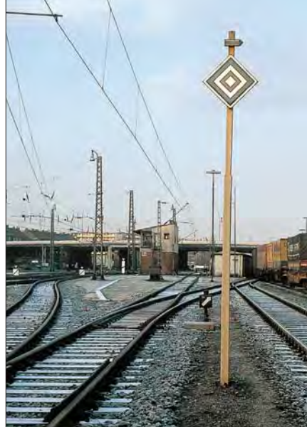
El 6-Signal mit einfachem, nach rechts zeigendem Richtungspfeil für die Fahrt über den abzweigenden Strang einer Weiche in den nichtüberspannten Bereich des Rbf Hamburg-Rothenburgsort im Dezember 1985
