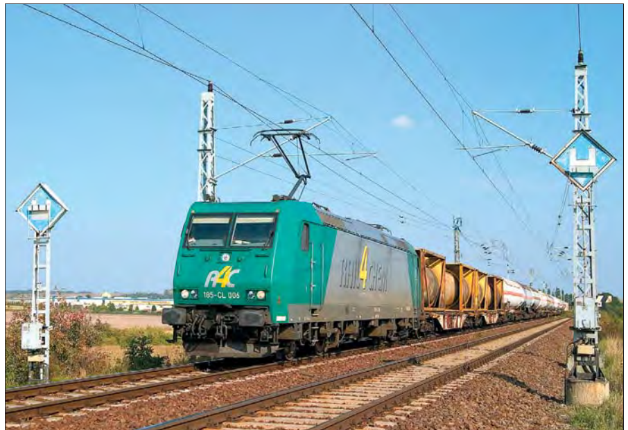
185 CL 005 rail4chem passiert am 9. September 2005 die verstellbaren Aus-/Einschaltsignale der Regelschutzstrecke Teutschenthal. Foto Uwe Böhme
