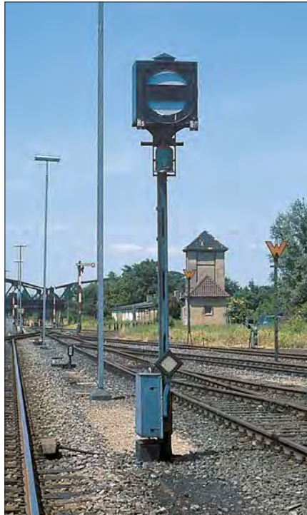
Auch das im Juni 1983 in Billwerder-Moorfleet fotografierte Sperrsignal entspricht der alten Form, nur das Aufsatzblech für das Mastbezeichnungsschild wurde demontiert und der Antrieb hat eine Abdeckung erhalten.
