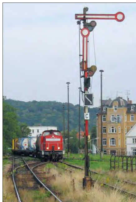
Links: 298 150-4 kommt mit einer Übergabe am 24. August 2004 im Bahnhof Gera-Süd an. Da an dem Signal C vorbei nur auf das Gegengleis ausgefahren werden kann, ist es mit einem Links-fahrt-Auftragssignal als Signaltafel ausgerüstet. Foto Niels Kunick
