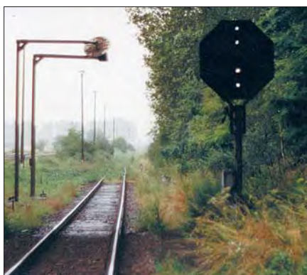
Niedriges Lichtabdrücksignal mit vier Lichtpunkten unter einer Straßenbrücke in Stendal im Oktober 1991 in den Stellungen Ra 7–Ra 9 . Slg. SC
