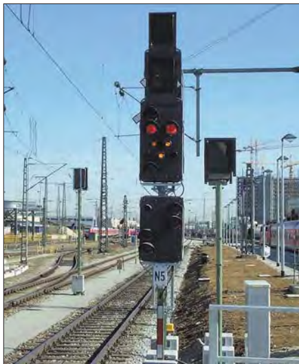
An einem Kompaktsignal aufleuchtendes Vorsichtsignal im Bahnhof München-Ostbahnhof im März 2004. Foto Alexander Lindner
