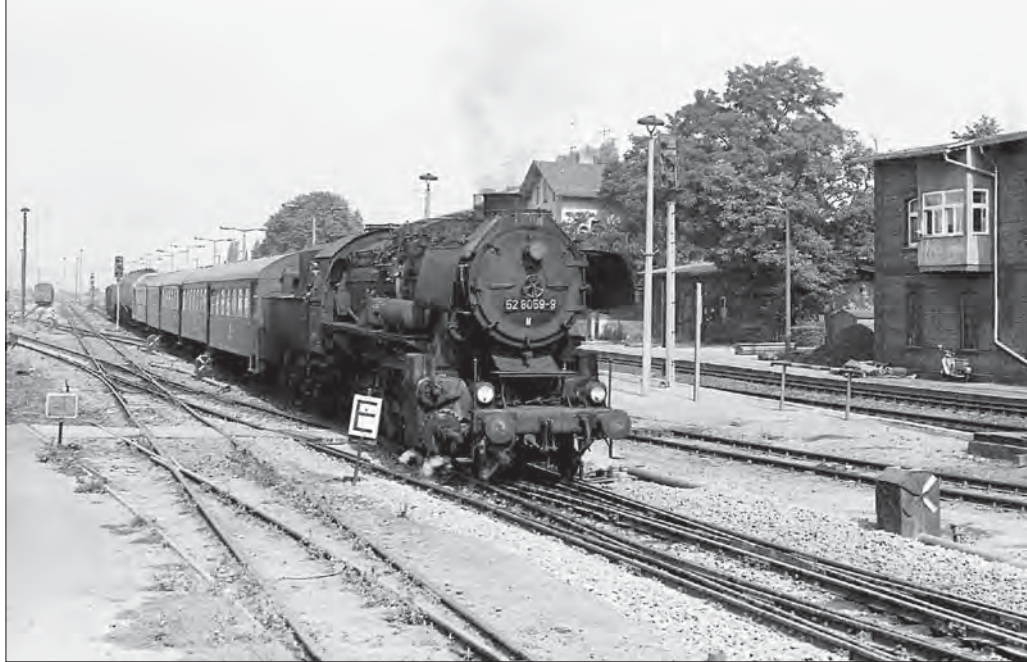
52 8059-9 vom Bw Röblingen verlässt am 1. September 1979 mit einem PmG den Bahnhof Querfurth. Links eine Sh 2-Scheibe vor einem zurückgebauten Gleis, neben der Lok eine Endscheibe, die das Ende einer Langsamfahrstelle im Weichenbereich anzeigt. Foto Sammlung SC
