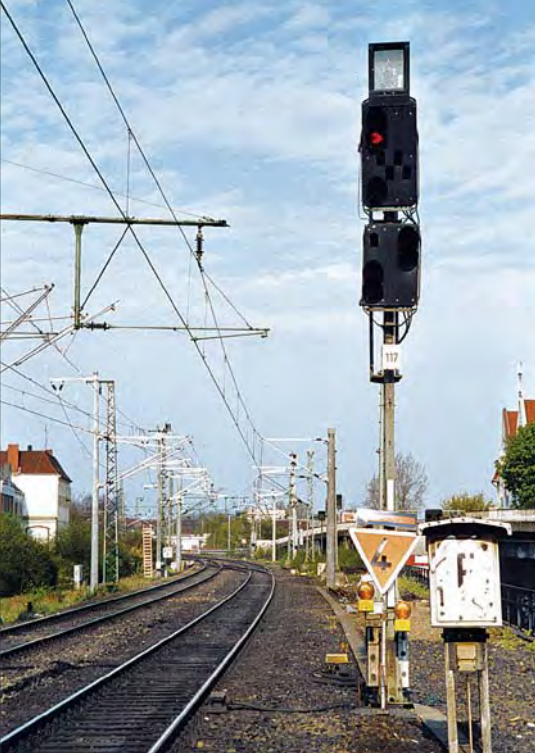
Lf 1-Signal mit Zuordnungspfeil vor dem Abzweig Rainweg im Juni 2004. Die angekündigten 40 km/h gelten nur, wenn der Fahrweg über den abzweigenden Strang der im Hintergrund sichtbaren Weichen zum Bahnhof Hamburg-Altona führt.
