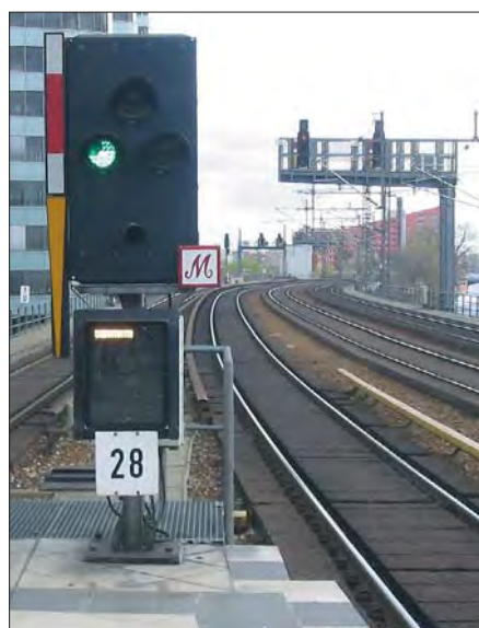
„Türen schließen“ an einem Ks-Signal der Berliner S-Bahn im November 2004 am Haltepunkt Jannowitzbrücke
