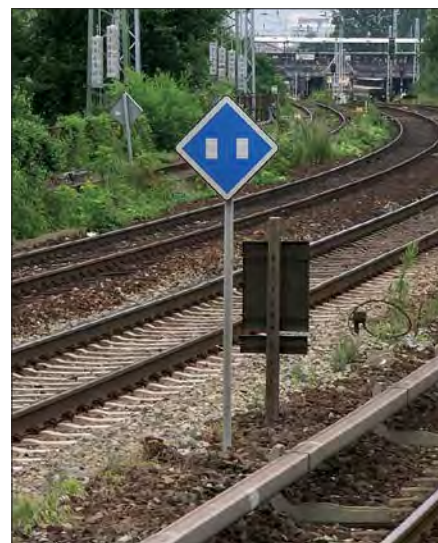
Ein Signal El 1v „Signal El 1 erwarten“ in Berlin-Rummelsburg zum Ankündigen des nur mit ausgeschaltetem Hauptschalter befahrbaren Gleisabschnitts unter der im Hintergrund sichtbaren Brücke am Bahnhof Ostkreuz im Juli 2005. Foto Alexander Lindner
