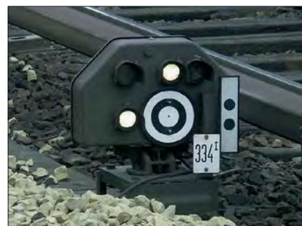
Lichtsperrsignal mit weißem Mastschild mit schwarzen Punkten in der Stellung Sh 1 im Bahnhof Charlottenburg im Dezember 2004. Foto Alexander Lindner
