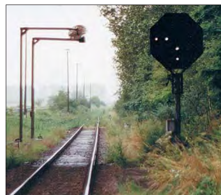
Niedriges Lichtabdrücksignal mit vier Lichtpunkten unter einer Straßenbrücke in Stendal im Oktober 1991 in den Stellungen Ra 7–Ra 9 . Slg. SC
