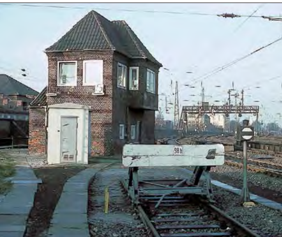
Sh 0-Signale an Prellböcken werden nur beleuchtet, wenn, wie hier im Bahnhof Hamburg-Altona im November 1984, sie wegen anderer Lichtquellen in der Nähe nur schwer zu erkennen sind.
