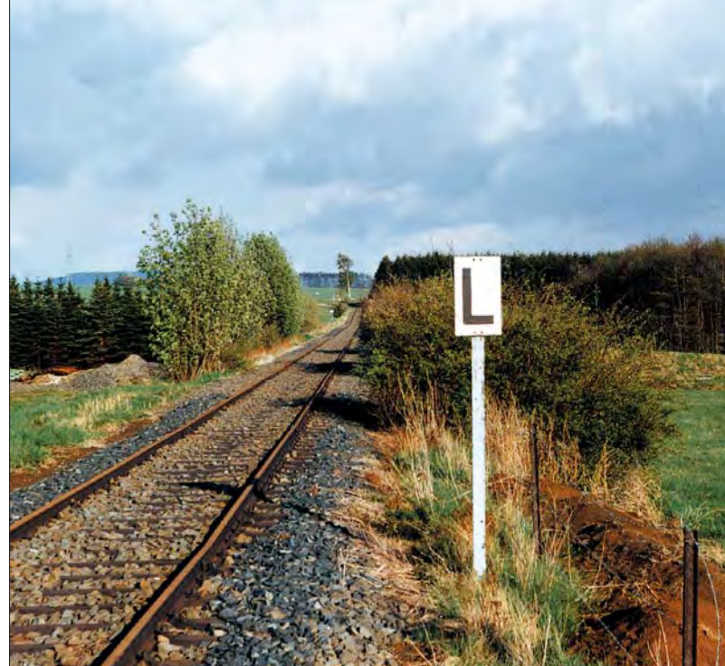
Foto Bustorff, Sammlung SC Rechts: Läutetafel vor einem Bahnübergang an der Westerbahnbahn zwischen Weitefeld und Oberdreisbach im September 1990. Foto Michael Schnippering
