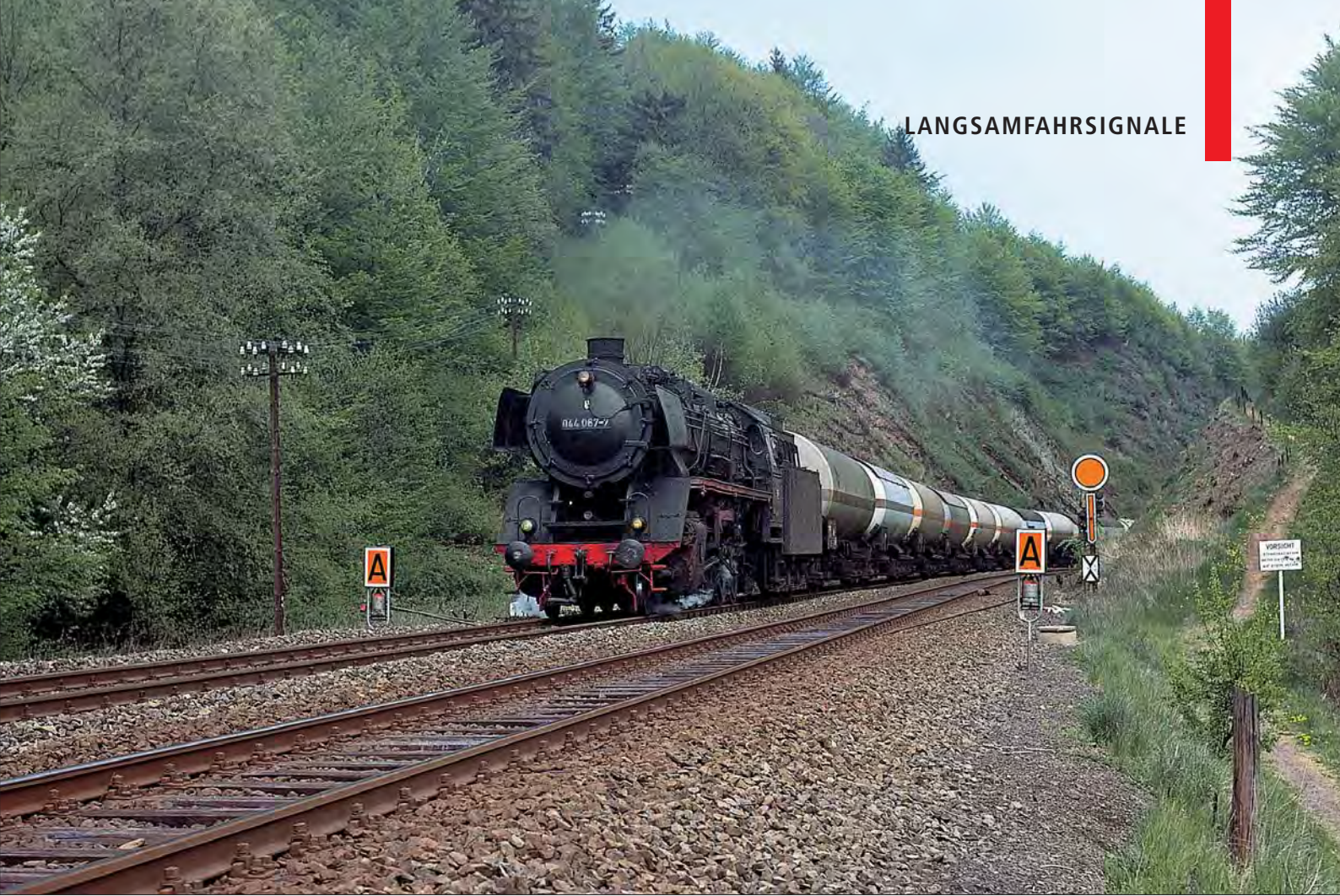
044 067-7 vom Bw Ottbergen rollt am 11. Mai 1976 mit dem Gag 57 422 Langelsheim–Altenbeken durch eine Baustelle bei Lenne. Neben der Lok stehen an beiden Gleisen von innen beleuchtete Anfangscheiben (Transparentsignale), die den Beginn bzw. von der Rückseite mit einem „E“ das Ende der Langsamfahrstelle kennzeichnen.
