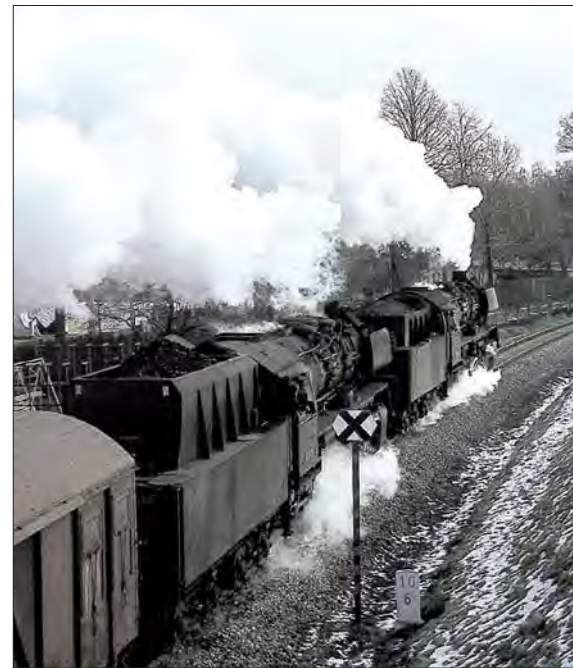
Rechts: Ein von zwei 50 35 gezogener Zug im Dezember 1983 kurz vor dem Bahnhof Rödlitz-Hohndorf. Im Vordergrund die Kreuztafel, die das Einfahrsignal ankündigt. Foto Volker Frömer
