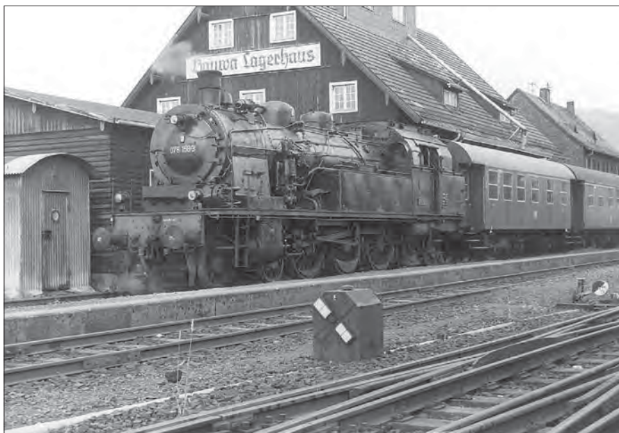
078 185-3 wartet im Juli 1968 im Bahnhof Bischofsheim/Rhön auf die Rückfahrt nach Bad Neustadt/Saale. Im Vordergrund ein mit Reflektorschildern ausgerüstetes DKW-Signal an einer ortsgestellten DKW. Sammlung SC
