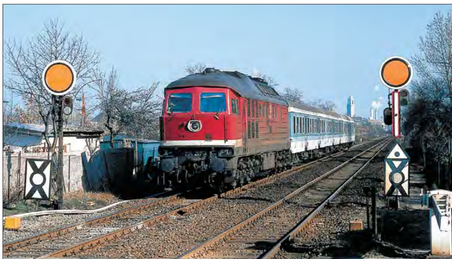
234 257-4 in Berlin-Spandau. Die beiden Einfahrtvorsignale – links ein zwei-, rechts ein dreibegriffiges – stehen im verkürzten Bremswegabstand und haben daher Vorsignaltafeln, auf denen dies mit einem Kreis kenntlich gemacht ist. Foto Thomas Böhnke
