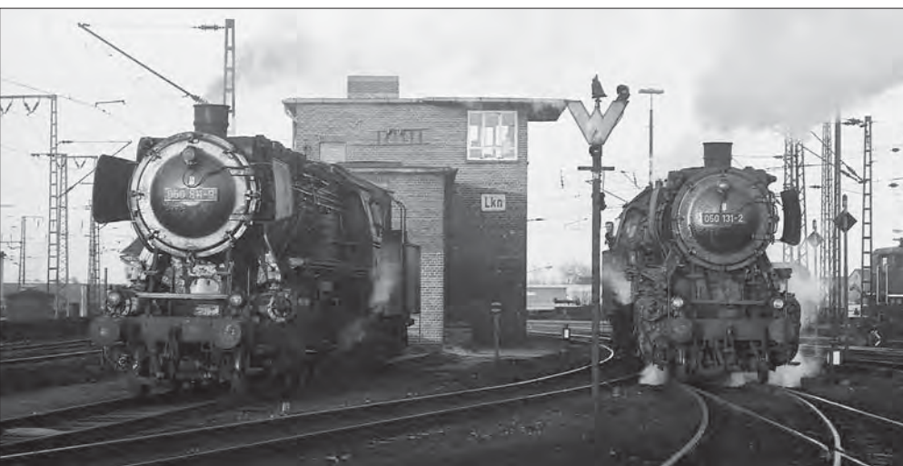
Bw Lehrte am Abend des 3. Februar 1974. Links wartet 050 811-9 auf den nächsten Einsatz, rechts rangiert 050 131-2 im Bw. Neben dem Wartezeichen mit Anstrahlleuchte und Sh 1-Signal im Vordergrund sind auf dem Foto noch eine Reihe weiterer Signale zu finden, u. a. die Grenzzeichen vor dem Zusammenlauf der Gleise und eine Sh 0-Tafel vor dem Stellwerk neben dem Gleisabschluss.
