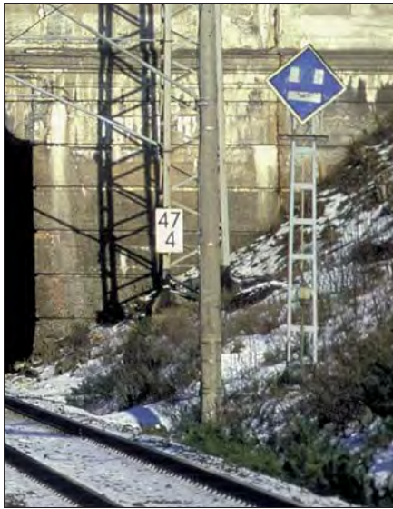
Einfache, unbeleuchtete Ausführung eines verstellbaren Aus-/Einschaltsignals vor der Kanalbrücke Eberswalde im Jahr 2005.
