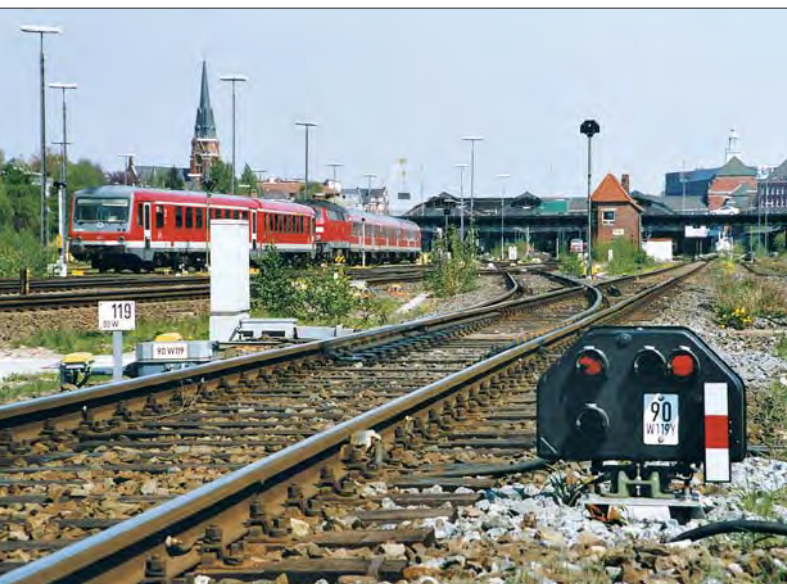
Rechts: Zwergsperrsignal von SEL im August 1991 im Bahnhof Itzehoe
