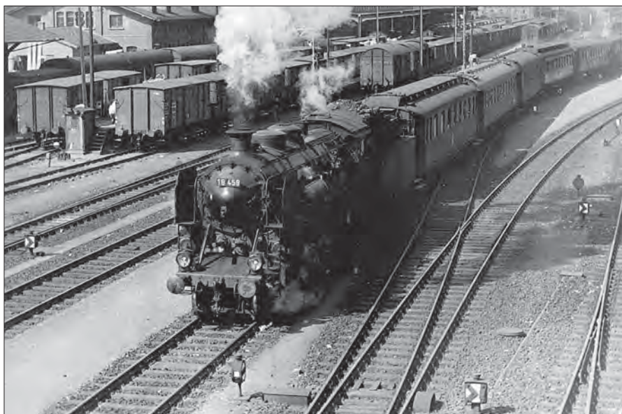
18 458 vom Bw Würzburg hat in Würzburg Hbf einen Schnellzug übernommen und macht sich in den 30er Jahren auf den Weg nach München. Im Vordergrund mehrere Weichen- und DKW-Signale bayerischer Bauart mit beweglichen Blenden, sowie ein niedriges Sperrsignal. Foto Alfred Ulmer, Sammlung Dietrich Braitmaier
