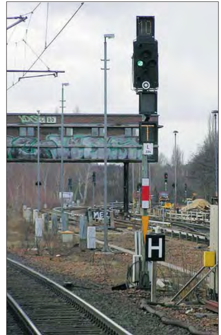
Ks-Signal mit aufleuchtendem Geschwindigkeits- und Richtungsanzeiger im Bahnhof Berlin-Charlottenburg im Januar 2004. Bei den Geschwindigkeits- und Richtungsanzeigern der jüngsten Generation werden Ziffern und Buchstaben aus einer Matrix von 28 x 22 Lichtpunkten gebildet. Foto Dietmar Lehmann
