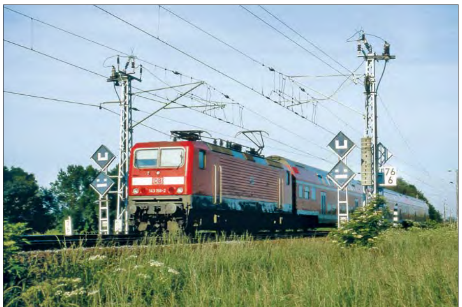
143 159-2 durchfährt mit ausgeschaltetem Hauptschalter vor einer Regionalbahn die Kuppelstelle Roßla an der Strecke Nordhausen–Sangerhausen am 3. Juni 2002. Foto Uwe Böhme
