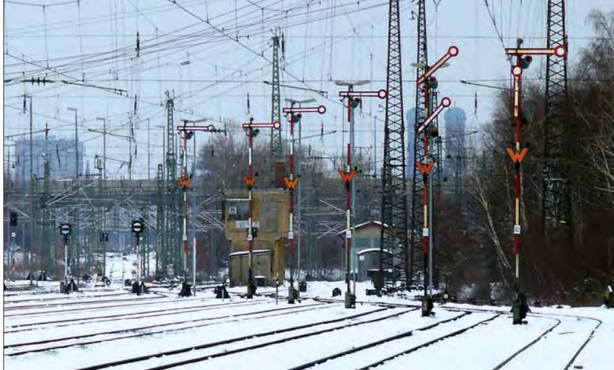
Hauptsignale mit unbeleuchteten Wartezeichen mit Sh 1-Signal am Signalmast im Rbf München-Laim im Februar 2005. Foto Alexander Lindner
