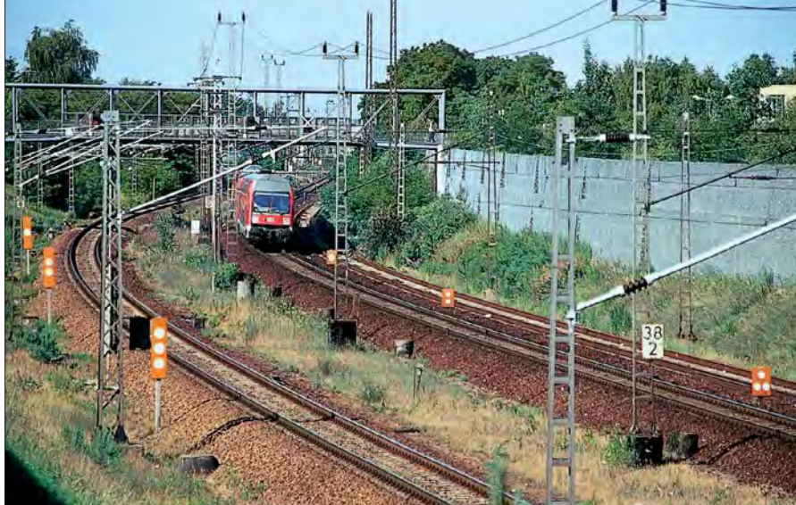
Hauptsignaltbaken im Juni 2003 bei Berlin-Altglienicke. Links im Bild die hohe, rechts die kleine Bauform für die Anordnung zwischen Gleisen mit 4,00 m Abstand. Foto Dietmar Lehmann
