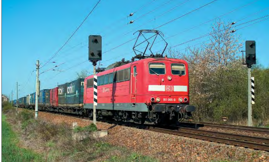
151 065-0 fährt am 21. April 2005 mit einem Container-Ganzzug von „norfolk-line“ bei Hohlstedt Richtung Halle/S. Neben der Lok zwei Blinklicht-Überwachungssignale. Foto Uwe Böhme
