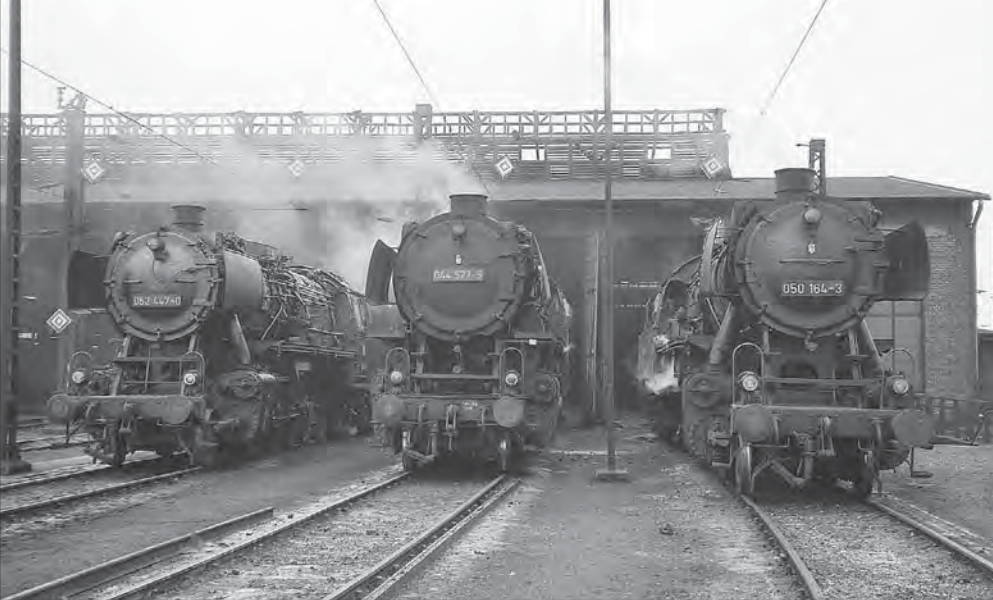
Lokparade im Bw Hohenbudberg am 28. Juli 1973: V.l.n.r. präsentieren sich 052 447-0, 044 577-5 und 050 164-3. Da die Gleise im Rechteckschuppen nicht überspannt sind, „stehen“ unmittelbar vor dem Schuppen Signale „Halt für Fahrzeuge mit Stromabnehmern“. Das Signal ganz links im Bild ist am Abspannmast angebracht, die übrigen sind im Kettenwerk unmittelbar vor dem Lokschuppen befestigt. Sammlung SC
