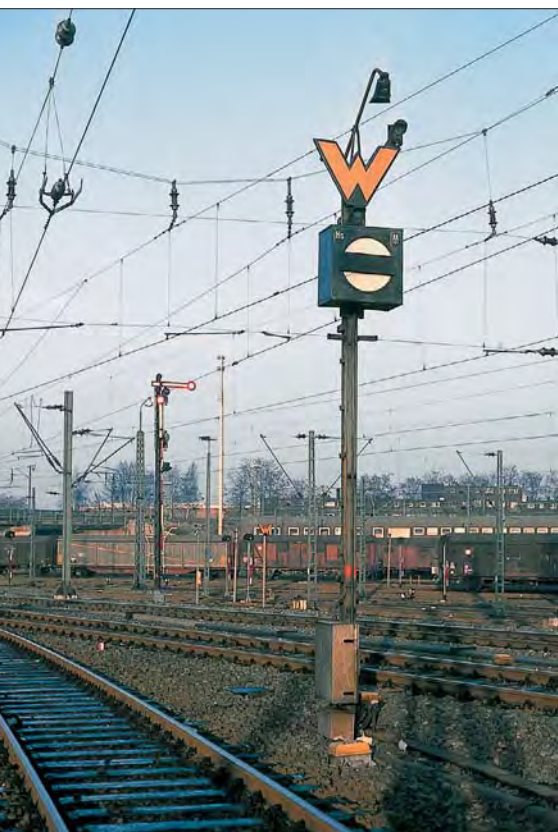
Vor den beiden linken Ausfahrtsignalen in Lübeck Hbf stehen Hauptsperrsignale sowie niedrige Geschwindigkeitsanzeiger; die Weichen in diesen Fahrstraßen lassen auch im abzweigenden Strang 60 km/h zu. Vor dem rechten Ausfahrtsignal kann auf ein Gleissperrsignal verzichtet werden, da es hier nicht zum Flankenschutz erforderlich ist. Seine Funktion für die Regelung der Rangierfahrten übernimmt hier ein Wartezeichen.
