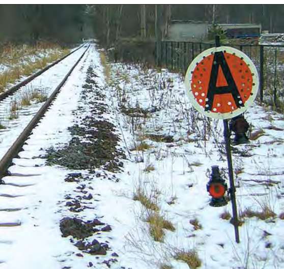
Von 1910 bis 1935 verwendete Ausführung der Anfangscheibe auf einem nachgestellten Bild. Foto René Döring
