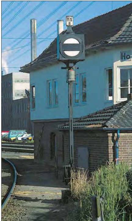
Das Stellwerk „Ho“ im Bahnhof Hamburg-Unterelbe-Seehafenbahnhof wurde 1909 von Jüdel gebaut. Bis in die 80er Jahre standen dort noch mehrere Sperrsignale der 1913 entwickelten Bauform, wie hier im Juni 1983.
