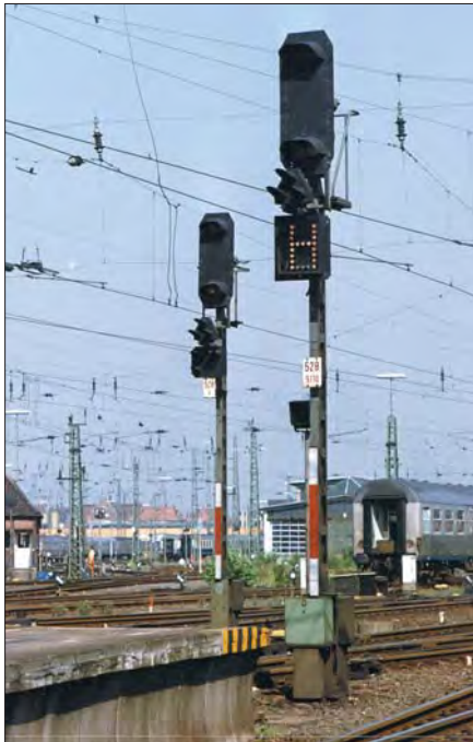
Lichtsignal der Bauform 1951 mit einem alten Richtungsanzeiger mit 8 x 5 Lichtpunkten im Bahnhof Hamburg-Altona im September 1991. Das „H“ bedeutet, dass die eingestellte Fahrstraße Richtung Hamburg Hbf führt (alternativ konnte „L“ für Langenfelde gezeigt werden).
