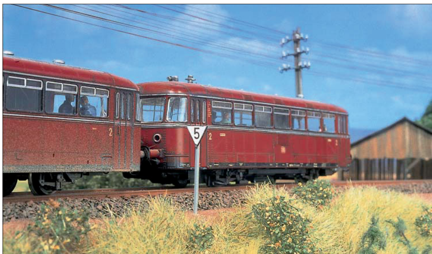
Der Schienenbus hat die Lf 4-Tafel passiert und seine Geschwindigkeit auf den entsprechenden Wert von 50 km/h (Anzeigewert x 10) reduziert. Beim Aufstellen solcher Tafeln auf der Anlage sollte man sich als Bediener beim Fahrbetrieb aber auch daran halten.
