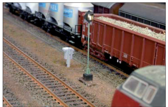
Der leuchtende Gleiswechselanzeiger signalisiert der ausfahrenden S-Bahn, dass die Weiterfahrt in das Gegengleis führt.
