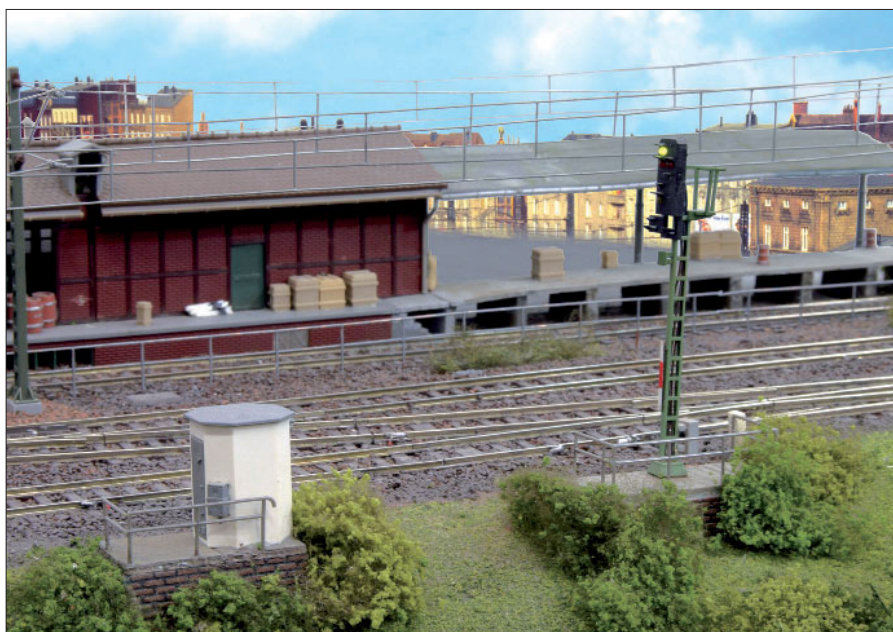
Hp 1 am Zwischensignal (Viessmann, Hauptsperrsignal) in einem größeren Modellbahnhof (Modellbahnteam Osnabrück). Im vor dem Signal stehenden Kabelhaus enden oder beginnen viele Signalkabel.
