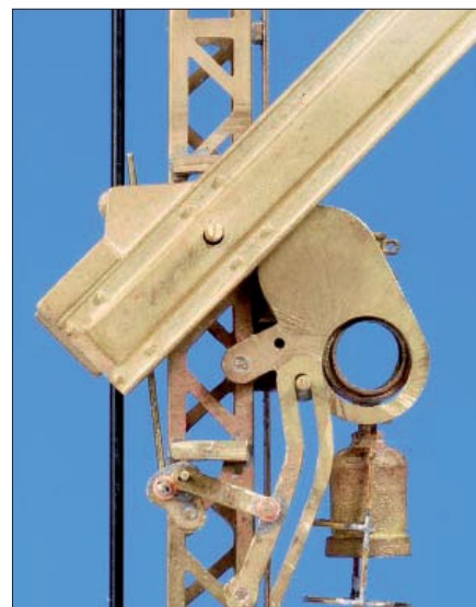
Hp 2: Die Mitnehmerstange zieht das Umlenkdreieck im Uhrzeigersinn und drückt die Steuersichel vom Mast weg. Die Blende schwingt nach oben und gibt die Signallaterne frei.
