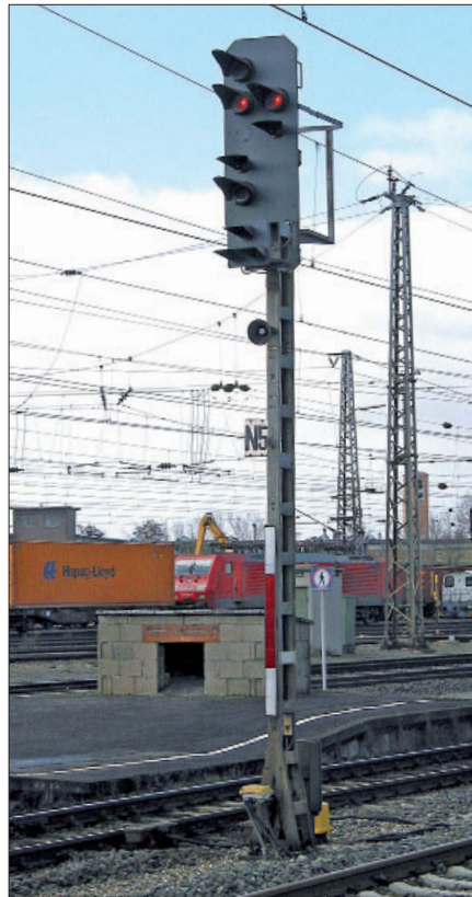
Licht-Hauptsignale haben sich über die Epochen stark im Aussehen verändert. Hier die Einheitsbauform 1969 (links). Bei den Licht-Vorsignalen hat sich die schräge Form mit den abgeschrägten Ecken recht lange gehalten (oben).
