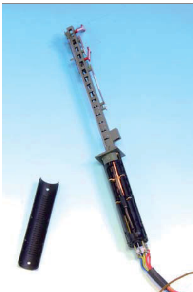
Im Inneren des Viessmann-Unterflur-Signals finden sich ebenfalls zwei Spulen als Antriebe und ein Dämpfungsmechanismus für das verlangsamte Bewegen der Signalfügel.
