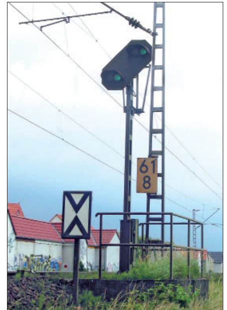
Licht-Hauptsignale haben sich über die Epochen stark im Aussehen verändert. Hier die Einheitsbauform 1969 (links). Bei den Licht-Vorsignalen hat sich die schräge Form mit den abgeschrägten Ecken recht lange gehalten (oben).
