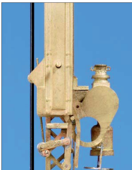
Hp 0: Über eine Mitnehmerstange und ein Umlenkdreieck wird die Steuersichel zum Mast gezogen und mit der Blende die Signallaterne abgedeckt.
