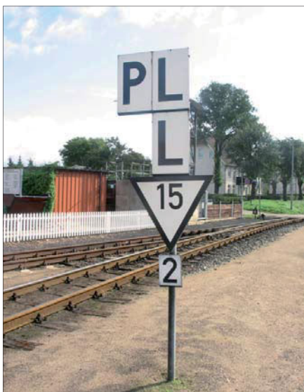
Eine ähnliche Kombination mit der Aufforderung zum Durchläuten und einer alten Geschwindigkeitstafel.
