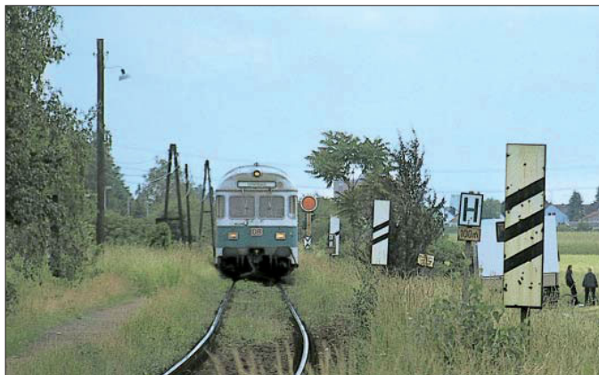
Vorsignaltafel und -baken auf einer eingleisigen Nebenstrecke.
