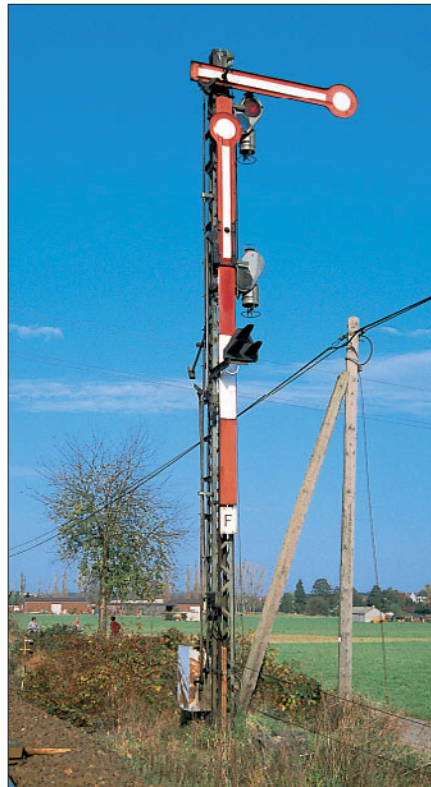
Beeindruckend in Erscheinung und Technik ist das zweiflüglige Formhauptsignal (links). Zum etwas kleineren Formvorsignal – im Volksmund auch „Spiegelei“ genannt – gehört auch die Vorsignaltafel.
