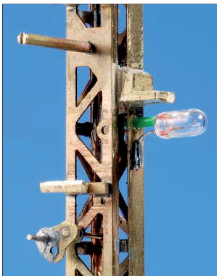
Ein Anschluss des Glühbirnchens wird an der Mastschiene angelötet, der andere mithilfe einer Kabelisolierung in das Mastinnere geführt.
