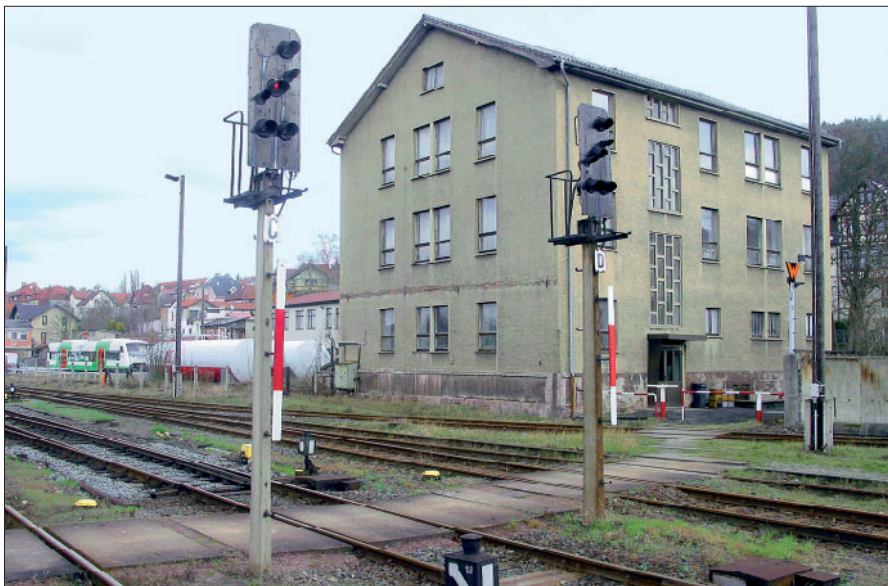
HI-Signale der zweiten Bauform (Einzellichtoptiken) mit Schleuderbetonmasten in einem Bahnhof der ehemaligen DR. Die Firmen Erbert und Siba vertreiben in ihrem Signalprogramm verschiedene Ausführungen.
