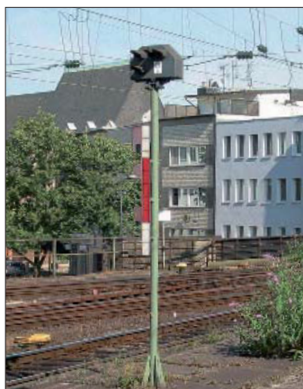
Ein hohes Licht-Sperrsignal mit rot-weiß gestreiftem Mastschild
