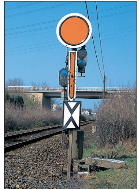
Beeindruckend in Erscheinung und Technik ist das zweiflüglige Formhauptsignal (links). Zum etwas kleineren Formvorsignal – im Volksmund auch „Spiegelei“ genannt – gehört auch die Vorsignaltafel.
