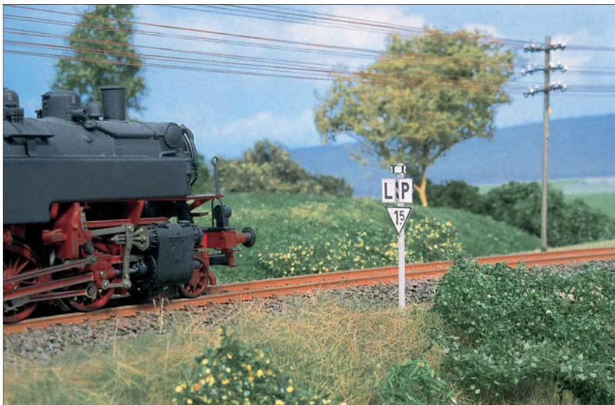
Eine Läute- und Pfeiftafel mit aufgesetztem Wiederholungszeichen und einer Geschwindigkeitstafel für maximal 15 km/h in der guten alten Epoche IIIa, Mitte der 50er Jahre.
