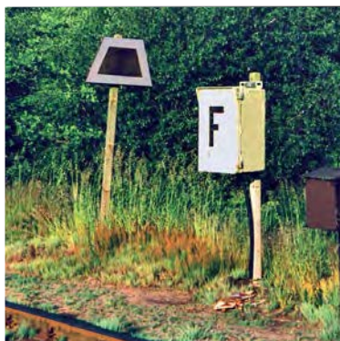
Typisch Nebenbahn: Statt eines Hauptsignals steht ein Kennzeichen K 15 (Trapeztafel) vor der Bahnhofseinfahrt, davor ein Fernsprechkasten, damit der Triebfahrzeugführer bei Unklarheiten mit dem Fahrdienstleiter Kontakt aufnehmen kann. Auch für Modellbahnen eine kostensparende und betriebsbereichernde Alternative. Das Bild stammt allerdings nicht von der Siebertalbahn, sondern von der Kleinbahn Bremen-Thedinghausen.
