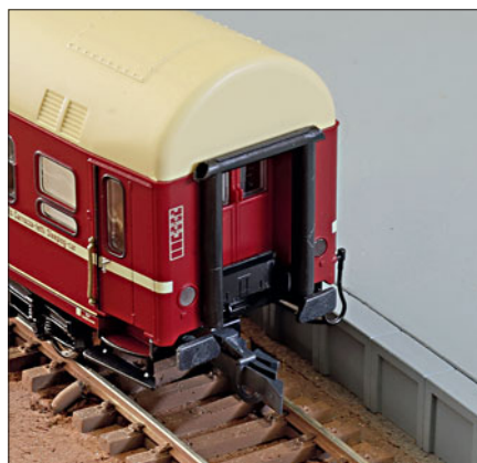
Ein mit Zurüstteilen versehener, maßstäblicher WL in H0 im 90 cm Radius am Bahnsteig.
