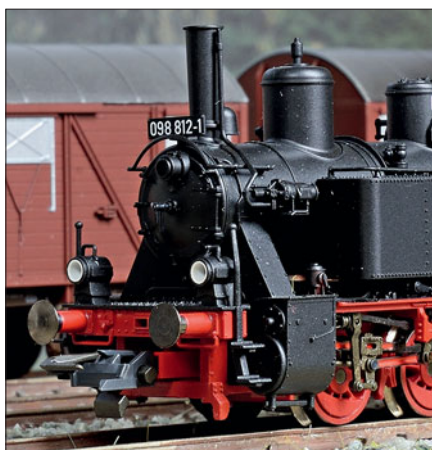
Kleine Lok mit großer Kupplung. Eine Fleischmann-98 mit einer Roco-Universalkupplung.
