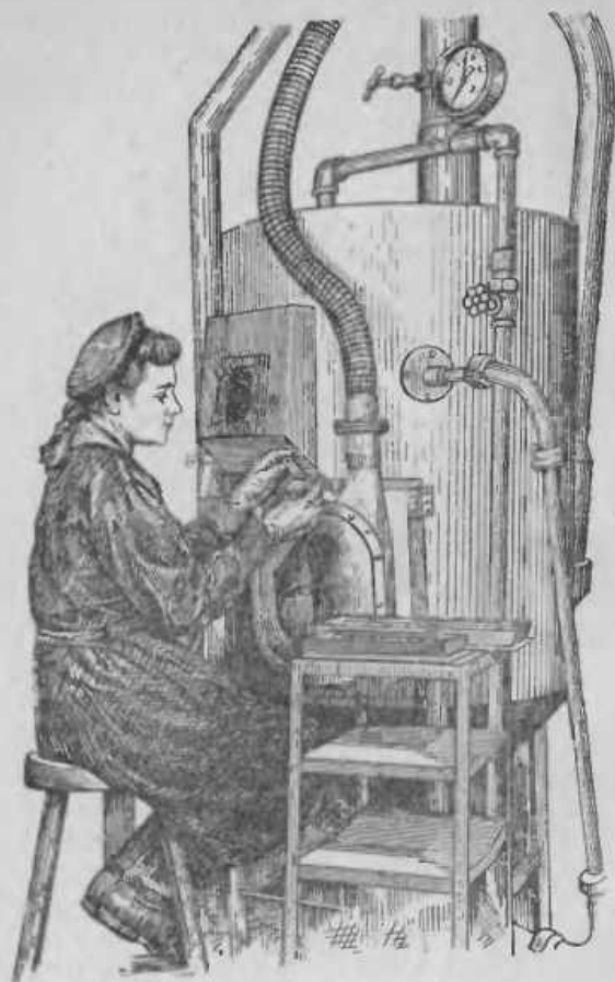
Фиг. 6. Общий вид пескоструйного аппарата для обработки небольших изделий.
