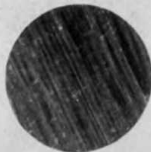
Фиг. 11. Фактура шлифованной поверхности стали. \times 10 .
