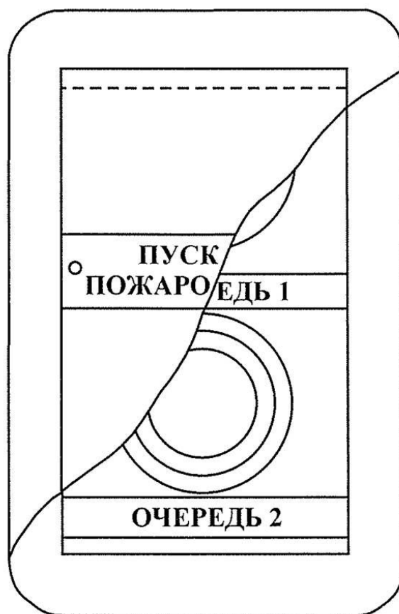
Рис. 3.3. Пост дистанционного пуска генератора установки газового пожаротушения
