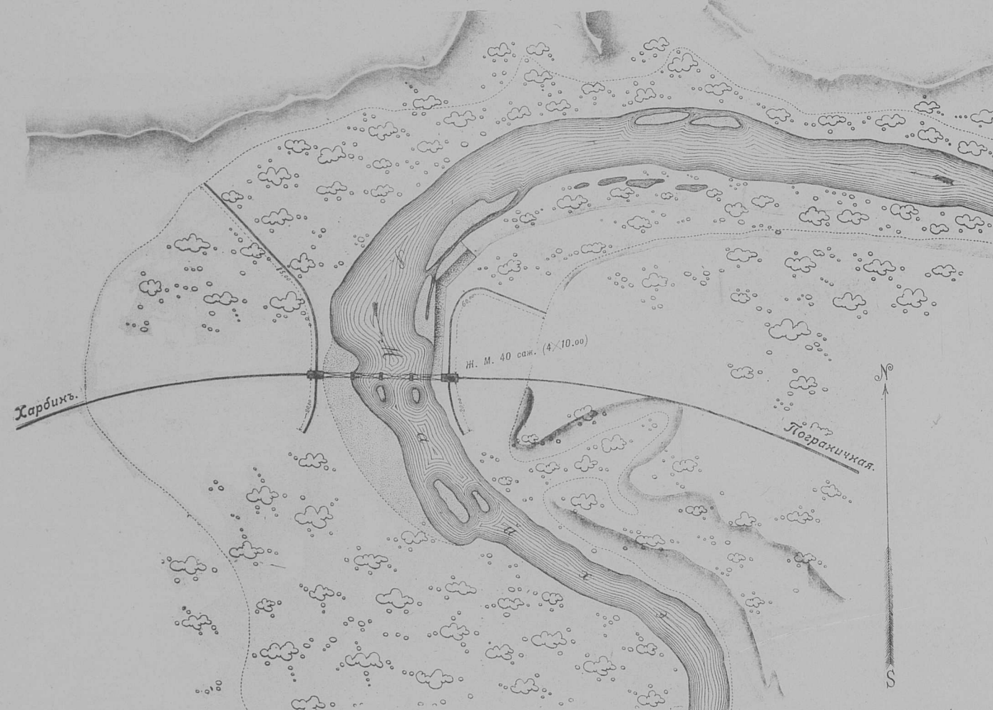
ОБЩІЙ ВИДЪ МОСТА ЧЕРЕЗЪ Р. БАРИМЪ ОТВ. 30.00 САЖ. (3×10.00) СЪ ѲЗДОЙ ПО ВЕРХУ. НА 441 ВЕР. ПИК. № 4400+45.50 ГЛАВНОЙ (ЗАПАДНОЙ) ЛИНІИ. ПРИ Н—4.12 САЖ.
