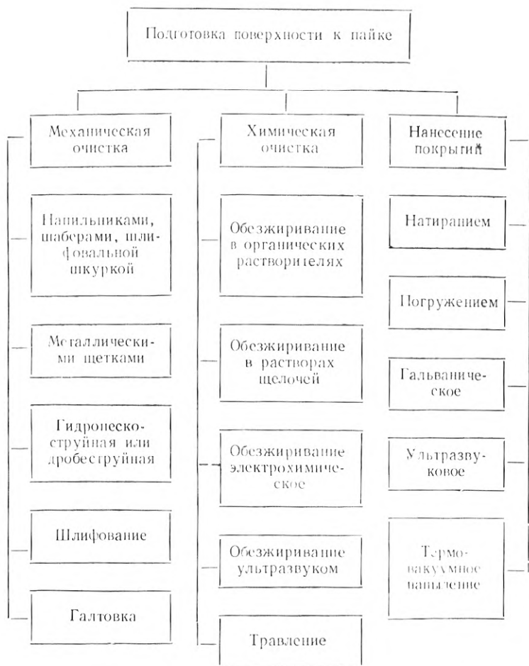
Рис. 17. Схема классификации способов подготовки к пайке
