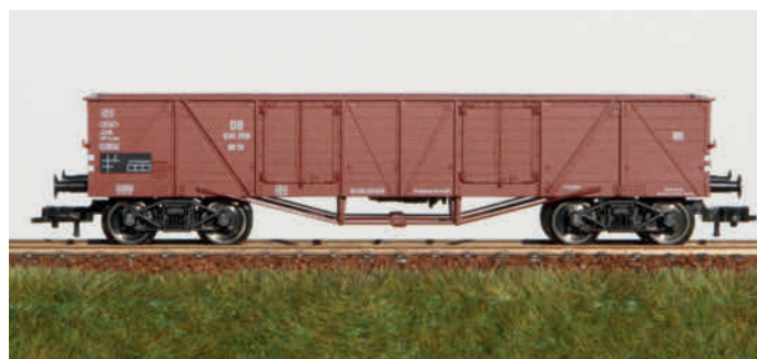
Open bakwagen, type oo, van de DB. Ze waren nuttig bij het kolenvervoer.
