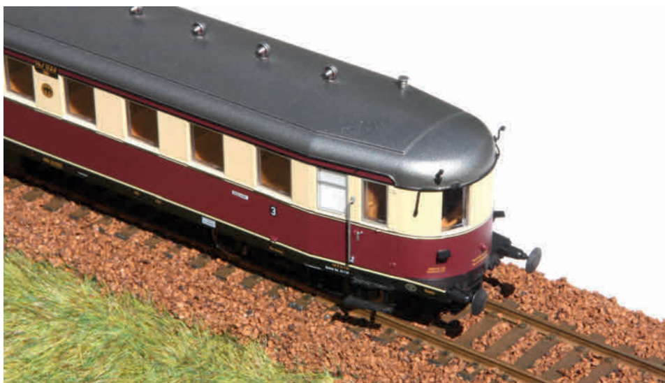
Ook de bijwagen heeft een stroomlijnkop. Het dak loopt hier veel geleidelijker over dan bij de motorwagen.
