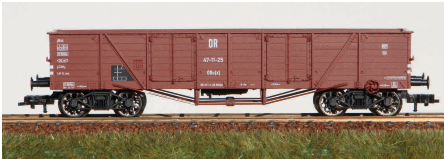
Deze oo-wagen van de Reichsbahn (Ost) heeft spaakwielen. Die werden pas later in de draaistellen geplaatst.
