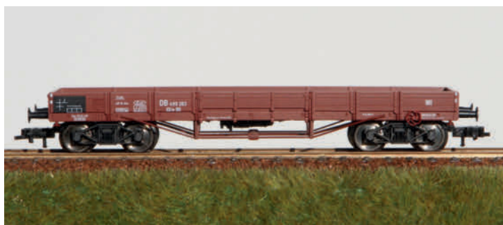
Lage bakwagen van het type XX van de DB. Het spanwerk is goed weergegeven.
