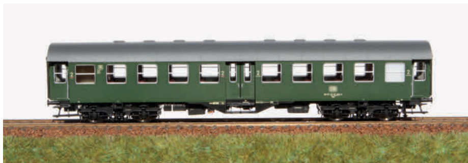
De nieuwe serie ombouwers van de DB is van Minden Deutz draaistellen voorzien.
