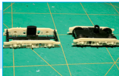
Beide Piko-draaistellen voorzien van nieuwe scheenplaten.
