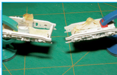
Om een goede hechting van de verf te waarborgen, worden de verbouwde draaistellen eerst in de primer gezet.
