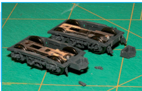
Na drogen van de lijmverbinding kunnen de overtollige delen van de scheenplaten weggezaagd worden.
