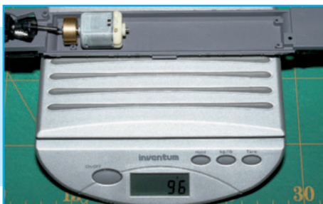
De rijtuigbak plus motor en draaistellen komt op amper 100 gram. Veel te weinig voor een goede trekkracht.
