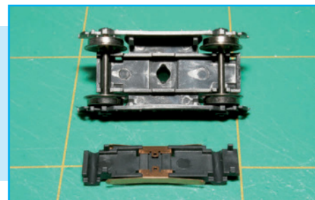
Het loopdraaistel. De wielen apart bestellen, evenals het plaatje met de stroomafnemers.
