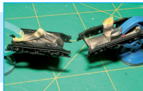
Na de primer is het dan de beurt aan zijdematte zwarte lak.
