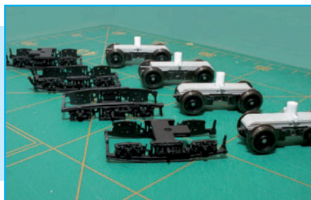
Alle loopdraaistellen afgemonteerd en de scheenplaten in de zwarte verf gezet.
