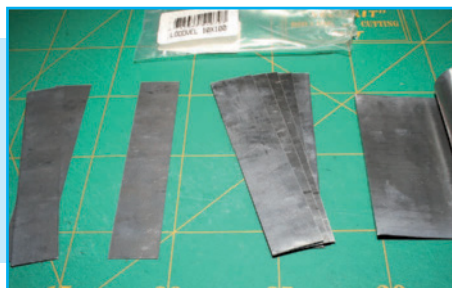
Uit een rol bladlood van de hobbymarkt worden stripjes gesneden.
