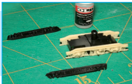
De nieuwe scheenplaten kunnen dan, na grondig ontvetten van alle onderdelen met cellulosethinner, met industriële secundelijm gelijmd worden.
