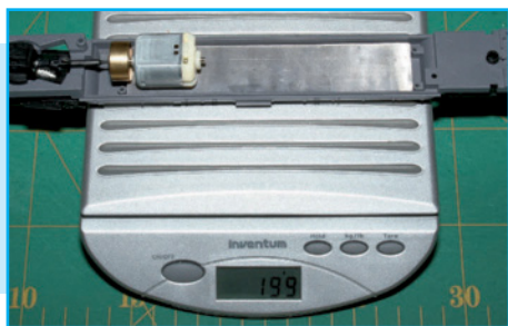
De complete bodem brengt nu een behoorlijke 200 gram op de weegschaal.
