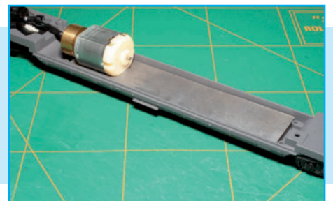
De strips krijgen een plaatsje onder in de wagenbak.
