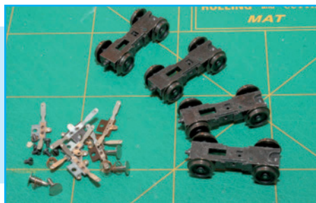
De metalen draaistelframes worden, tijdelijk, van stroomafnemers en andere kleine onderdelen ontdaan.
