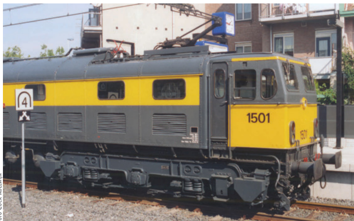
Eloc 1501 passeert station Rotterdam Zuid. Goed te zien is dat het draaistel opzichte van de bak tamelijk breed is. De oorzaak is dat de locomotieven volgens het kleinere omgrenzingsprofiel gebouwd zijn. De zandbakken zitten aan de buitenzijde van de draaistellen bevestigd.
