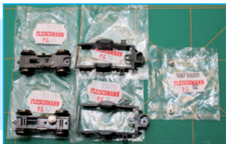
Voor de draaistellen onder de B- en ABk-bak worden de motorloze kopdraaistellen van de Fleischmann Plan V gebruikt.
