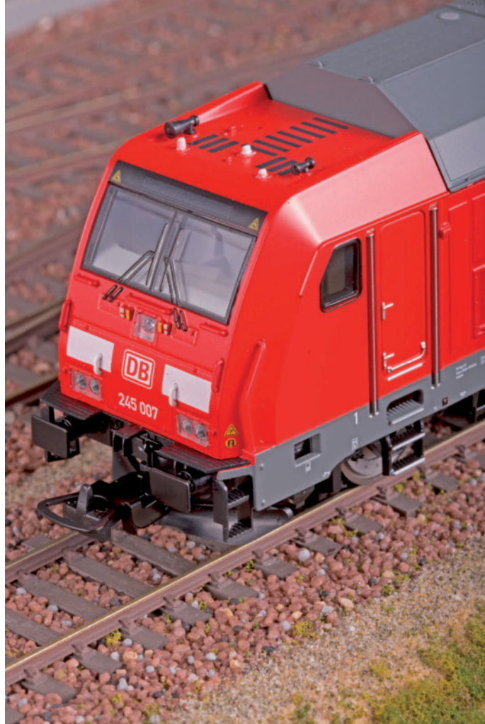
Het front met vele details, die soms meegegoten zijn, zoals de ruitenwissers en handgrepen naast de deuren. De koersborden boven cabineramen zijn niet verlicht.
