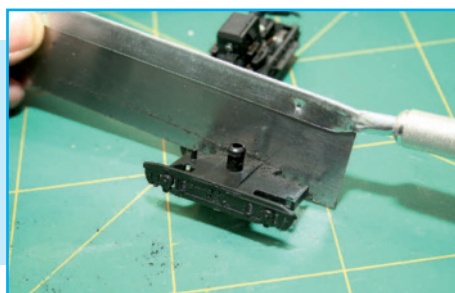
Met een fijn (kap)zaagje worden de Hondekop-scheenplaten los van het Piko-looppdraaistel gezaagd.
